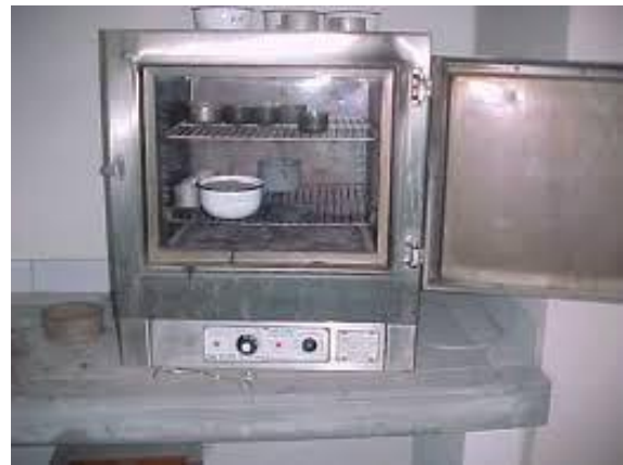
Figura 21. Prueba de contenido de humedad
