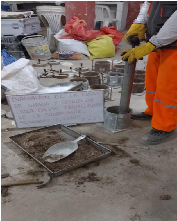
Figura 26. Prueba de resistencia suelos (CBR)
