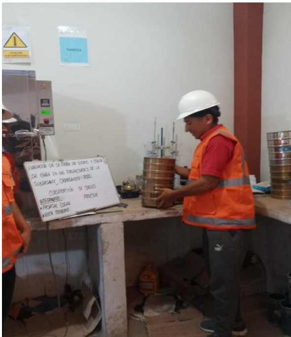
Figura N° 16: Ensayo de análisis granulométrico
