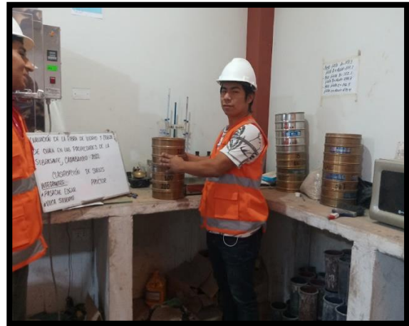
FIGURA 7: análisis granulométrico pasando por la malla número 200.
