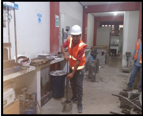
FIGURA 6: realizando la cantidad de de golpes en el ensayo Proctor modificado.
