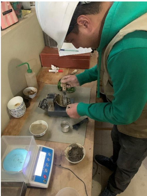
Figura 19. Ensayo de límites de Atterberg CC-1
