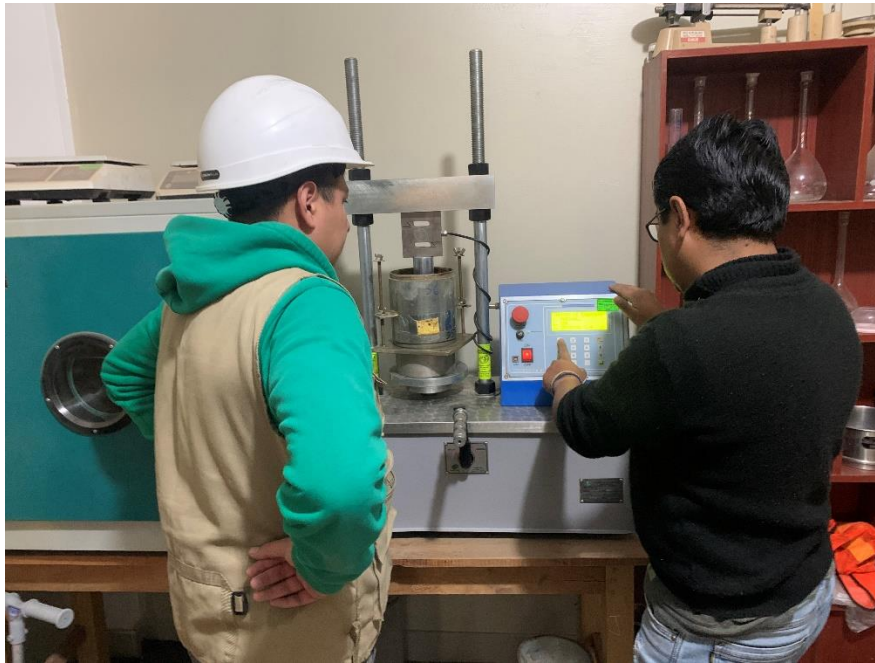
Figura 11. Ensayo de CBR a la muestra de la CC-1
