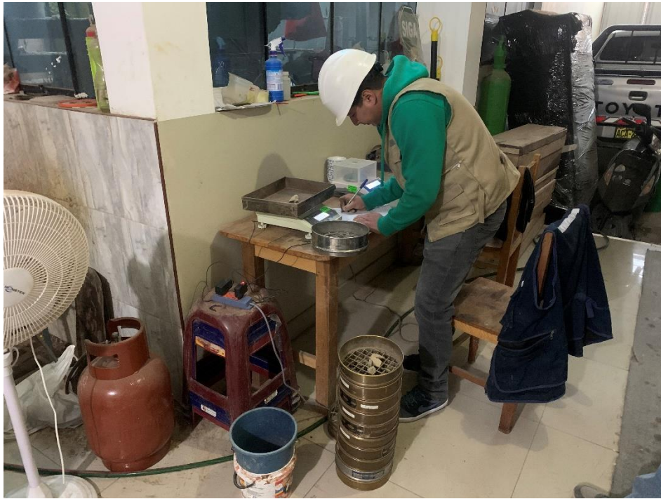
Figura 7. Determinación de porcentaje de gravas, arenas y finos
