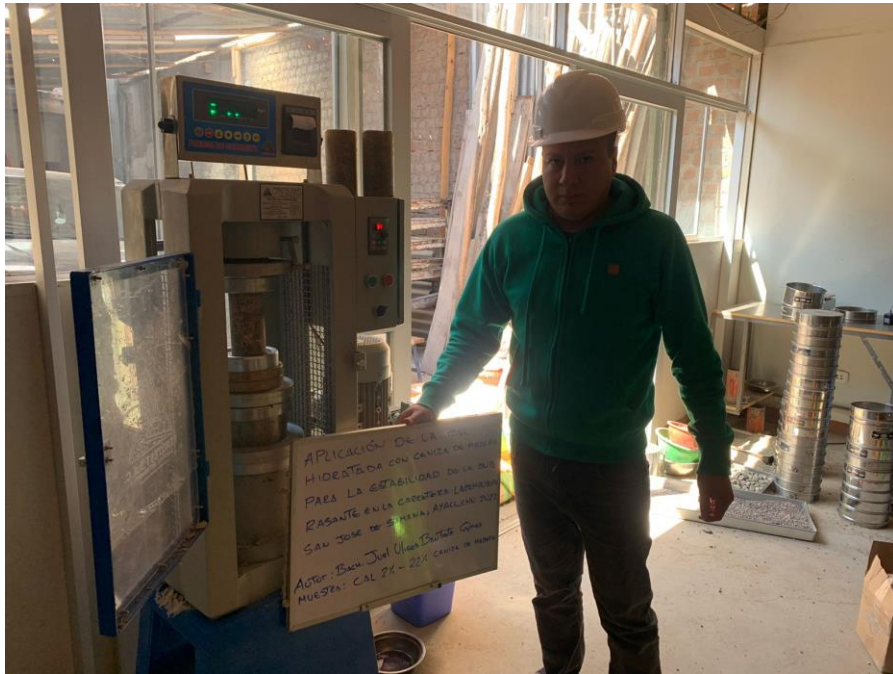
Figura 25. Ensayo de resistencia a compresión simple de muestras alteradas
