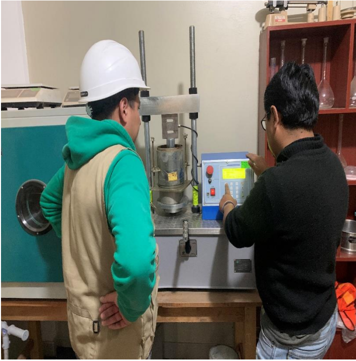
Figura 5. Ensayo de CBR a las muestras de la CC-1
