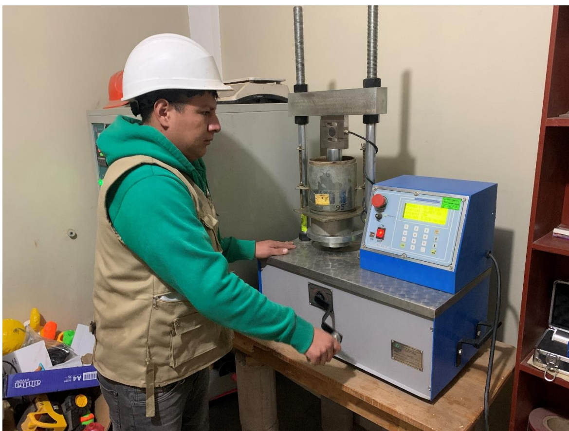
Figura 28. Ensayo de CBR a muestras alteradas
