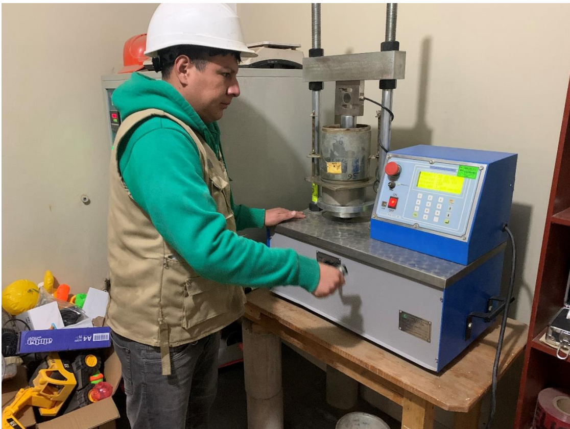
Figura 14. Ensayo de CBR a muestra alterada con 2% cal hidrata + 17% de ceniza de madera
