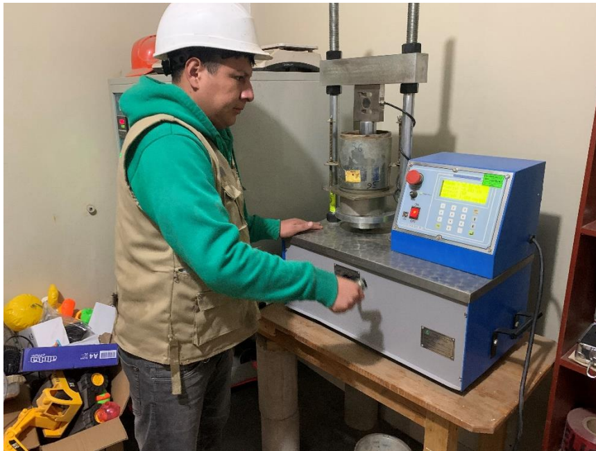
Figura 15. Ensayo de CBR a muestras alteradas
