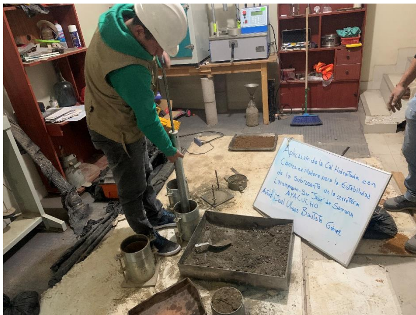
Figura 18. Ensayo de Proctor modificado para muestras inalteradas
