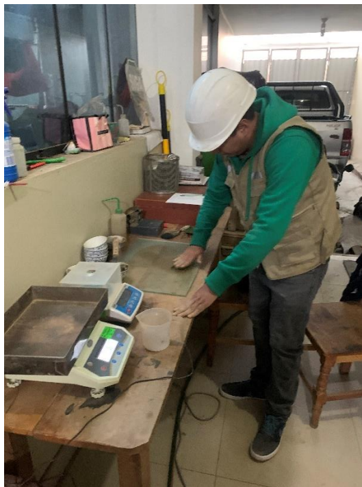
Figura 8. Determinación de los límites de Atterberg
