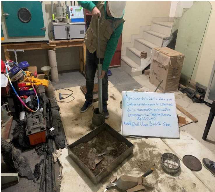
Figura 7. Ensayo de Proctor modificado a las muestras de la CC-1
