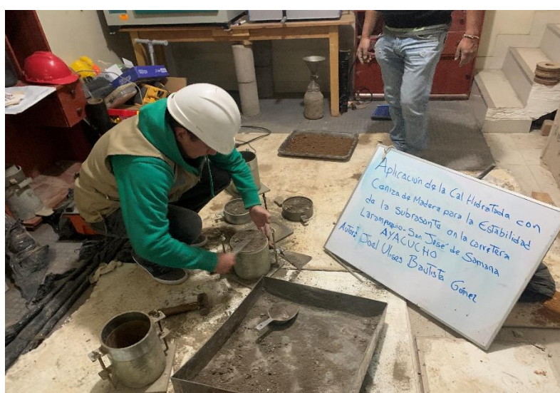
Figura 20. Ensayo de Proctor modificado a muestra alterada
