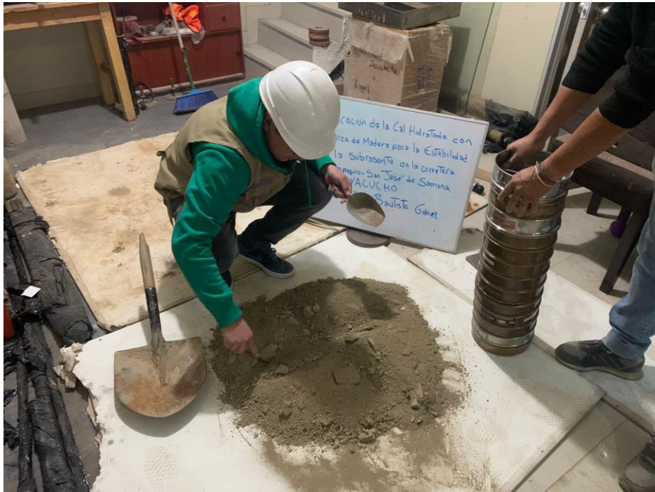
Figura 5. Cuarteo de la muestra de suelo de la calicata 1
