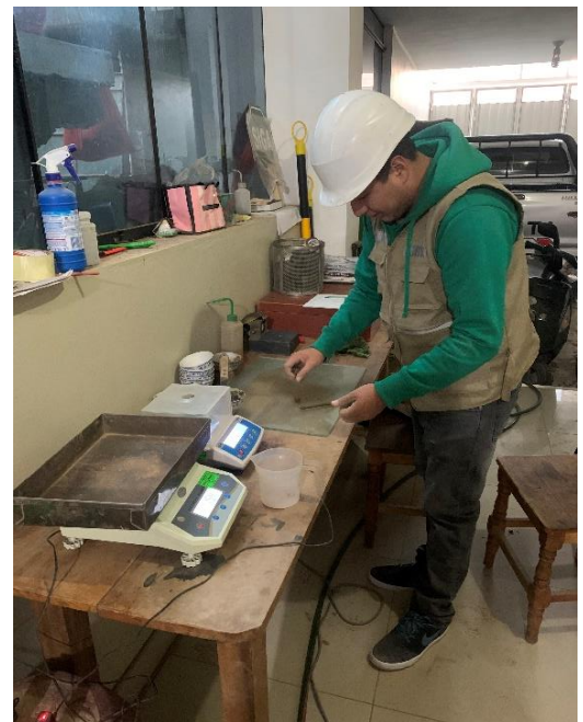
Figura 20. Ensayo de límites de Atterberg CC-4
