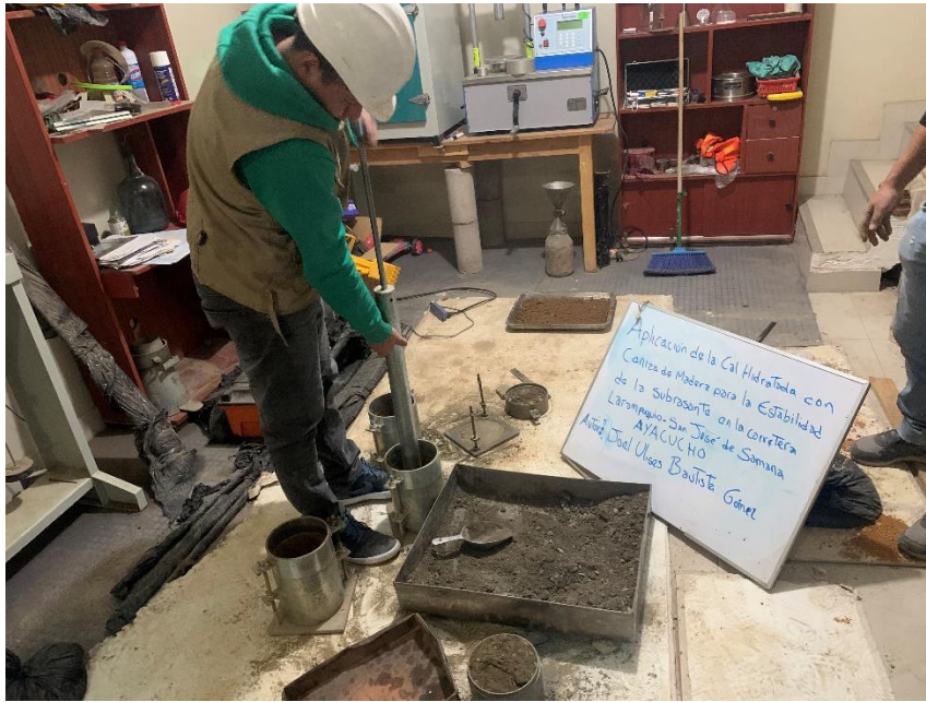
Figura 14. Ensayos de Proctor modificado a muestras alteradas
