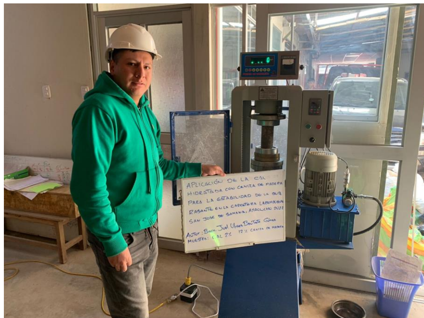
Figura 12. Ensayo a compresión simple no confinada a la muestra de la CC-4
