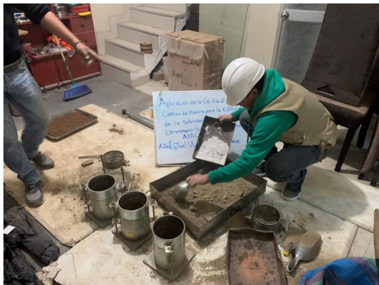
Figura 13. Preparación de muestras con incorporación de cal y ceniza de madera
