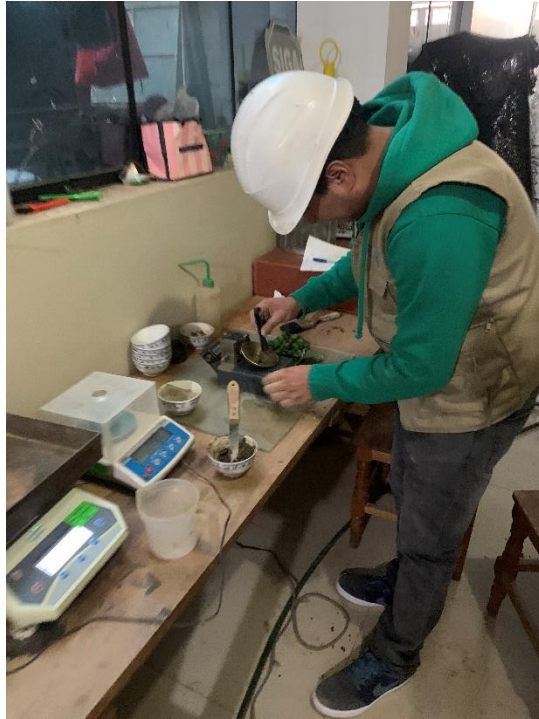
Figura 9. Determinación de los límites de Atterberg
