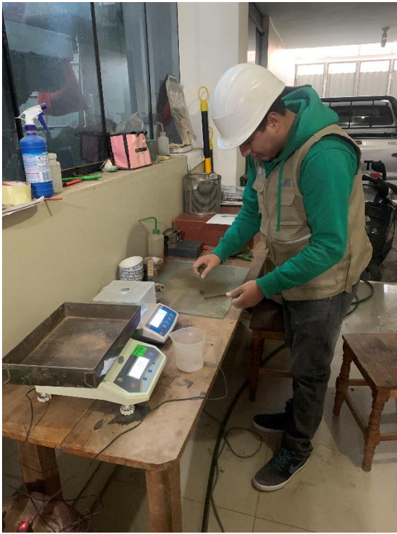
Figura 9. Ensayos de límites de atterberg
