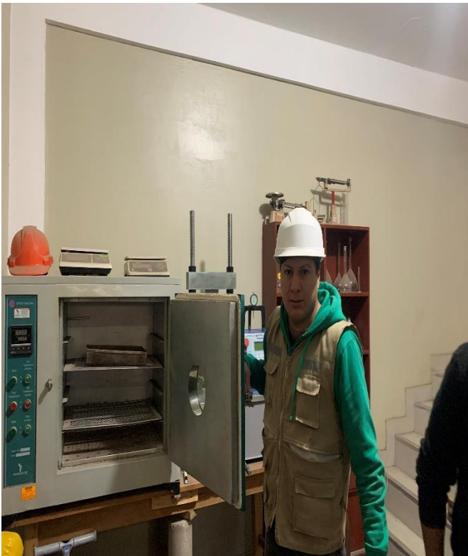
Figura 11. Secado en horno de las muestras
