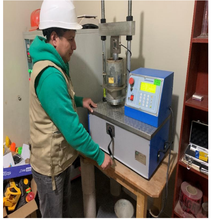
Figura 6. Ensayo de CBR a las muestras de la CC-4
