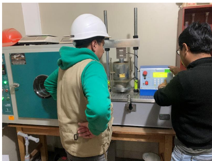
Figura 19. Ensayo de CBR para muestras inalteradas
