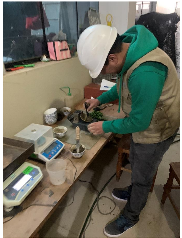
Figura 10. Adecuación de la muestra para determinar el límite líquido
