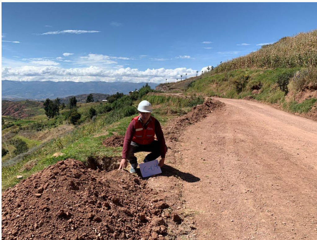
Figura 4. Calicata de estudio para la obtención de muestras
