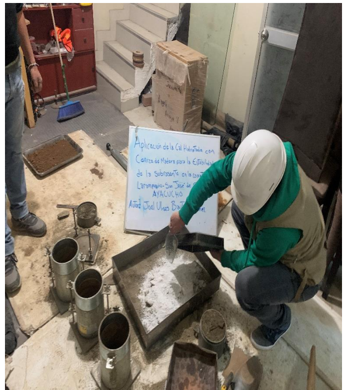
Figura 12. Incorporación de cal hidratada y ceniza de madera a las muestras
