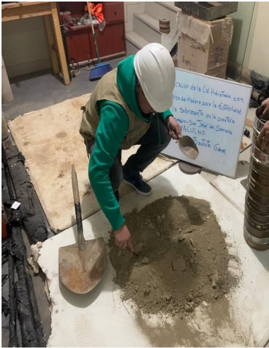
Figura 17. Cuarteo de muestra de suelo obtenido
