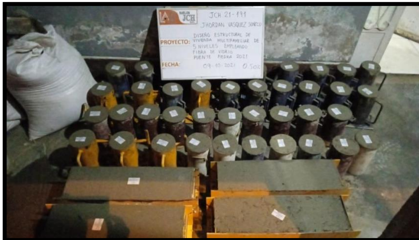
Figura 9. Vista de probetas cilíndricas y vigas colocadas en los moldes.
