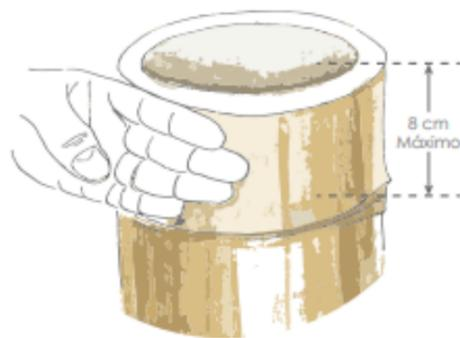
Figura 18. Separación máxima del nudo.
