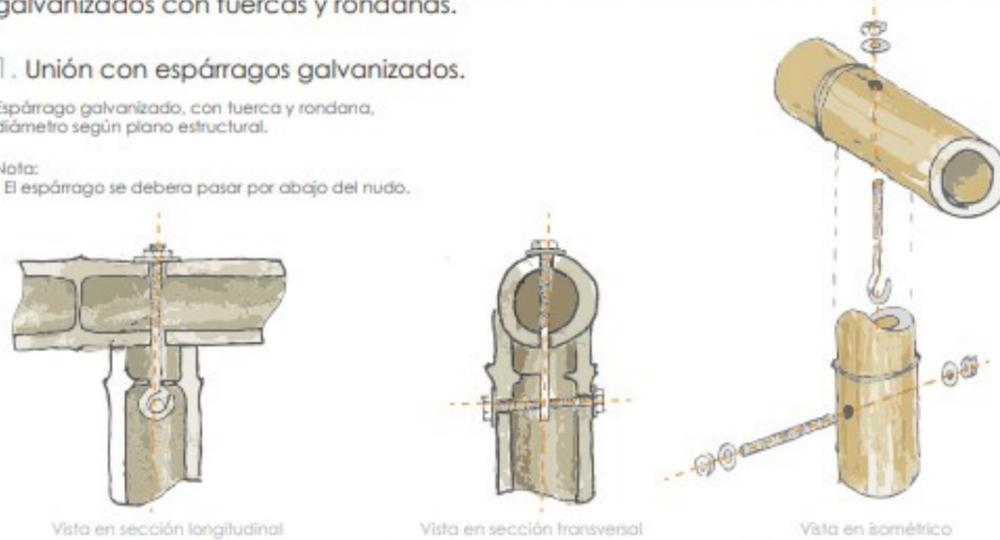
Figura 23. Unión de boca de pescado con espárrago.
