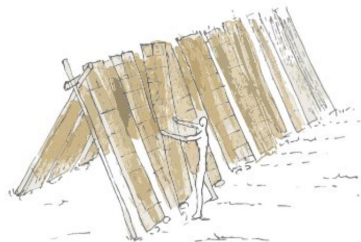
Figura 48. Proceso de secado en el burro.
