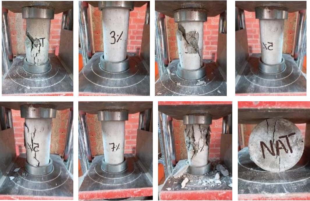
Foto 10. Rotura a compresión de las muestras del concreto natural y adicionados
