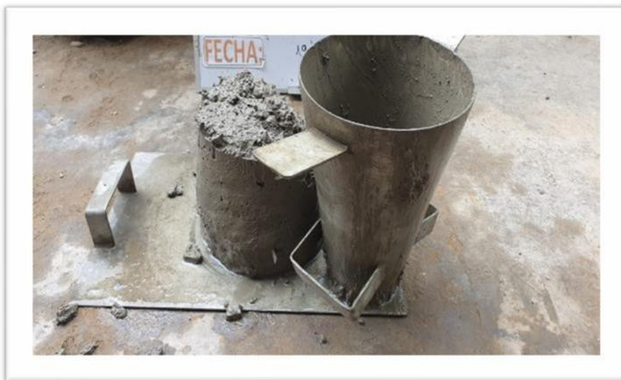
Figura 14. Ensayo con el cono de Abrams.
