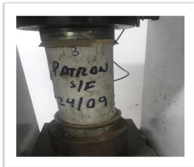
Figura 18. Ensayo a la compresión del concreto sin PVC (Prensa hidráulica)
