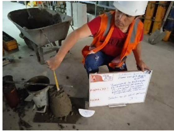
Foto 6. Asentamiento del concreto al 3% de PVC
