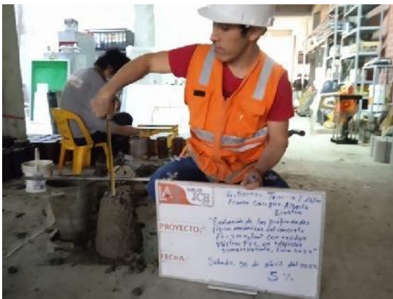
Foto 7. Asentamiento al 5% de PVC
