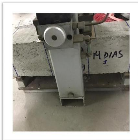
Figura 21. Muestra de vigas a flexión sin PVC y con PVC
