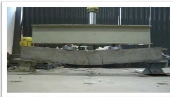
Figura 7. Ensayo de Flexión
