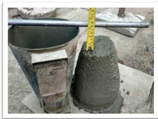
Figura 2. Ensayo de asentamiento del concreto
