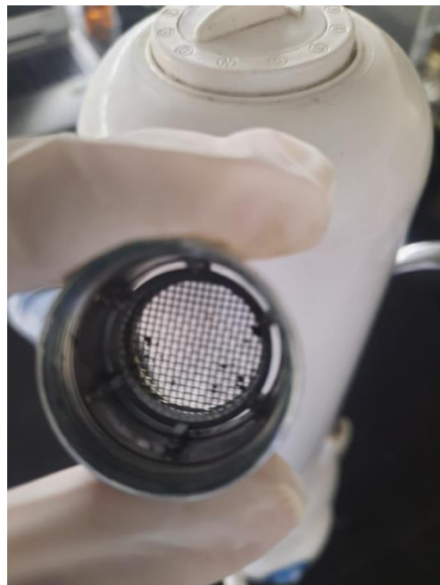
Figura 15. Malla inoxidable del filtro del nanotubo de carbono
