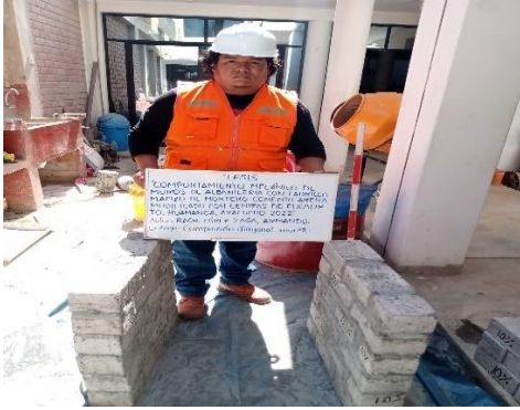
Figura 1.19. Elaboración de muretes para ensayos a corte diagonal
