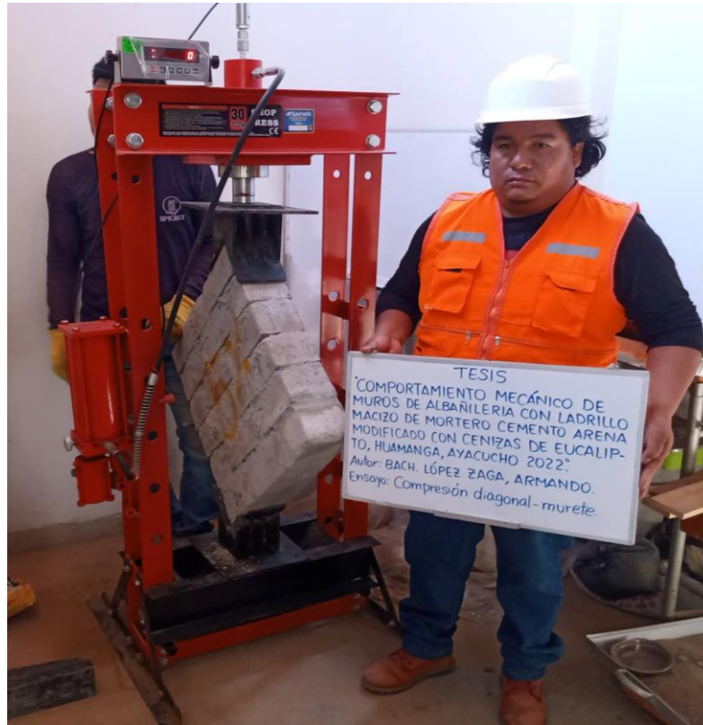
Figura 1.31. Ensayo a compresión por corte diagonal.
