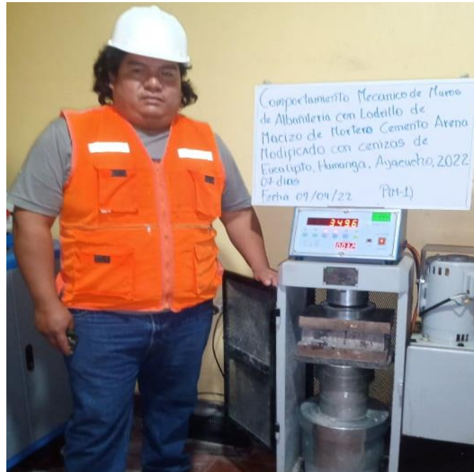
Figura 1.27. Ensayo a compresión a los 7 días
