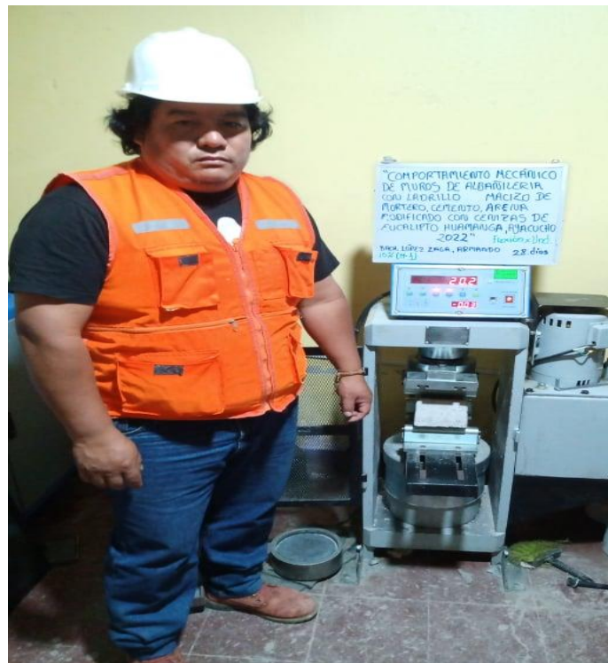
Figura 1.28. Ensayo a flexión por unidad
