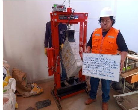
Figura 1.20. Ensayo compresión diagonal- muretes
