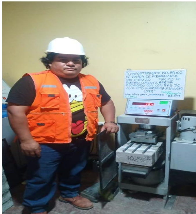
Figura 1.30. Ensayo a flexión por adherencia en pilas
