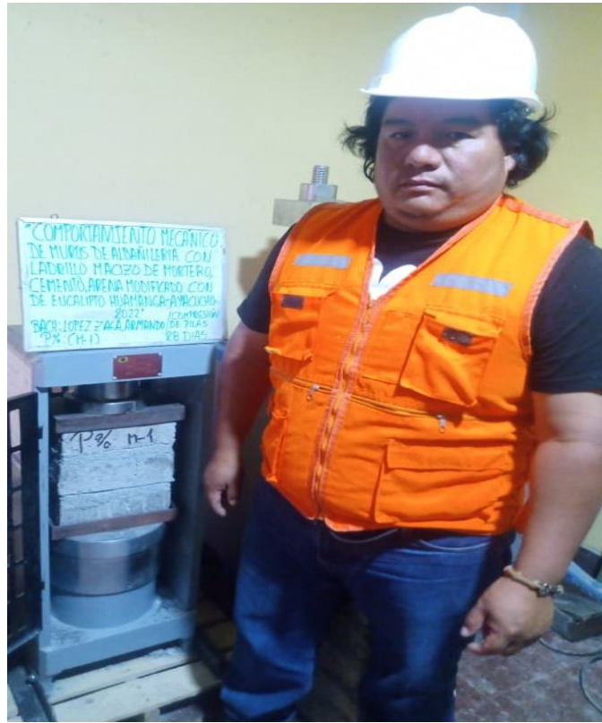
Figura 1.29. Ensayo a compresión en pilas
