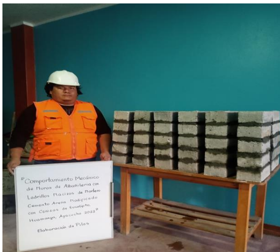
Figura 1.16. Elaboración de pilas para ensayos a flexión por adherencia
