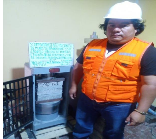
Figura 1.14. Ensayo a compresión en pilas.
