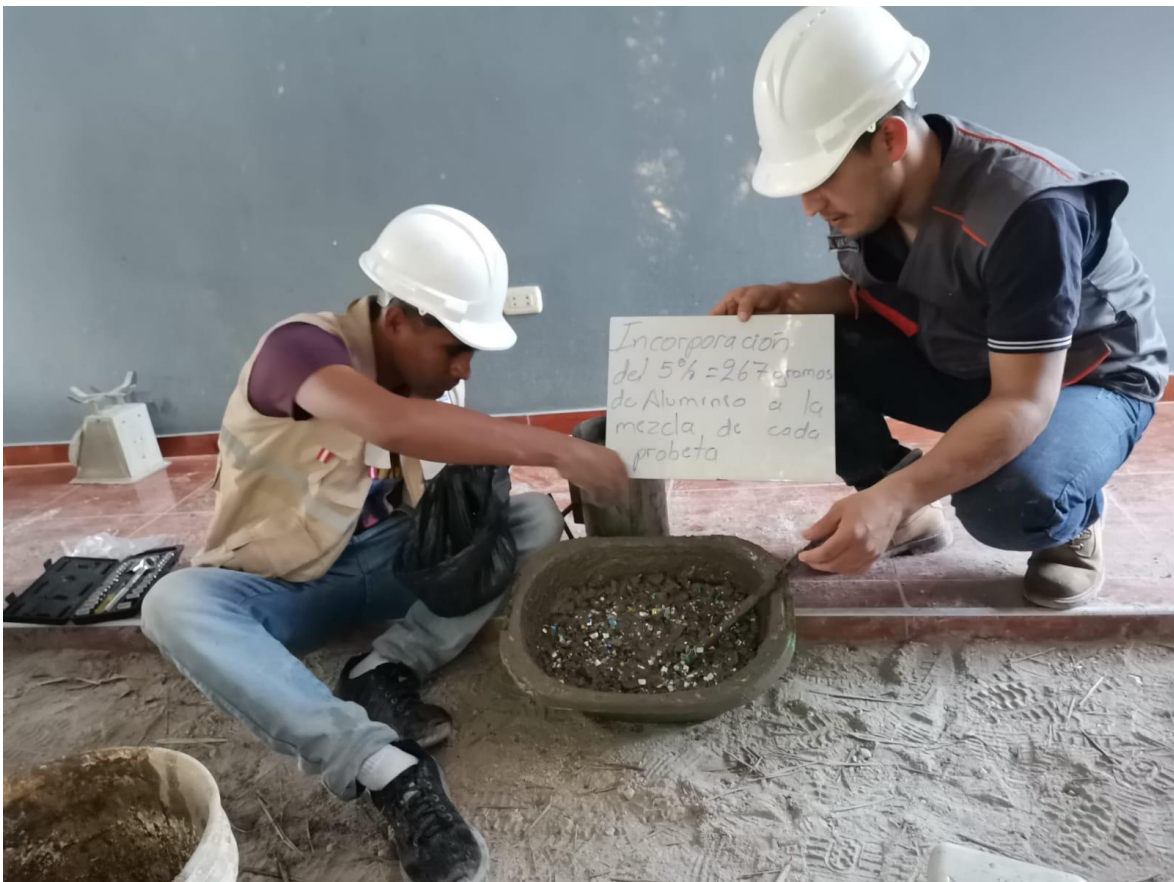
Figura 19 Adición del aluminio molido al concreto- Fuente Propia
