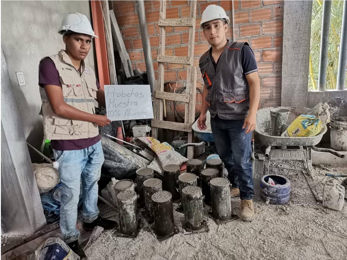
Figura 23 Probetas, con adición al 10% de aluminio molido- Fuente Propia.
