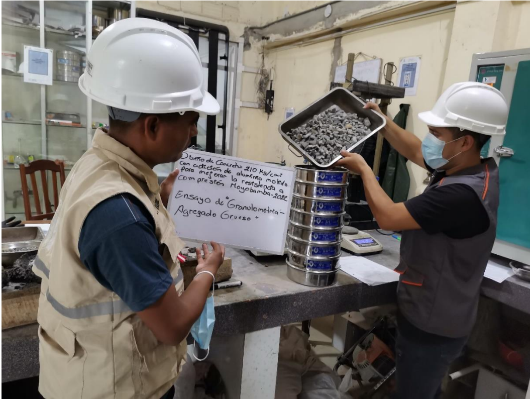
Ensayo de Granulometría, agregado grueso- Fuente Propia.
