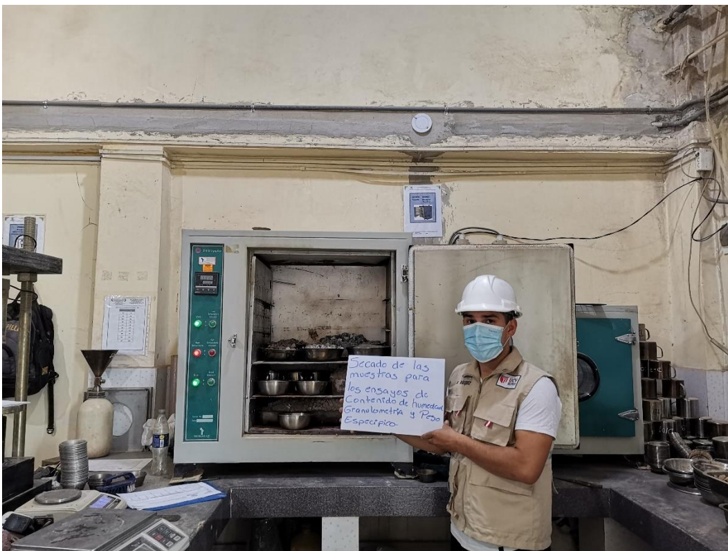
Figura 6 secado de las muestras en el horno- Fuente Propia.
