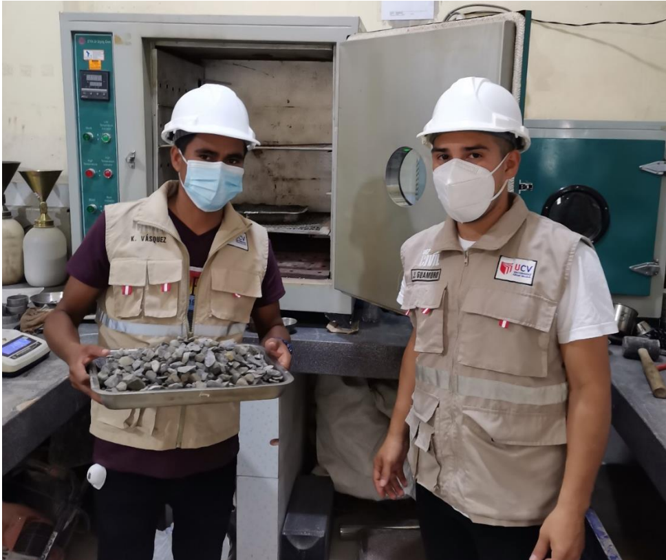
Figura 5 Secado de muestra del agregado grueso para los ensayos de Granulometría y peso específico- Fuente Propia.
