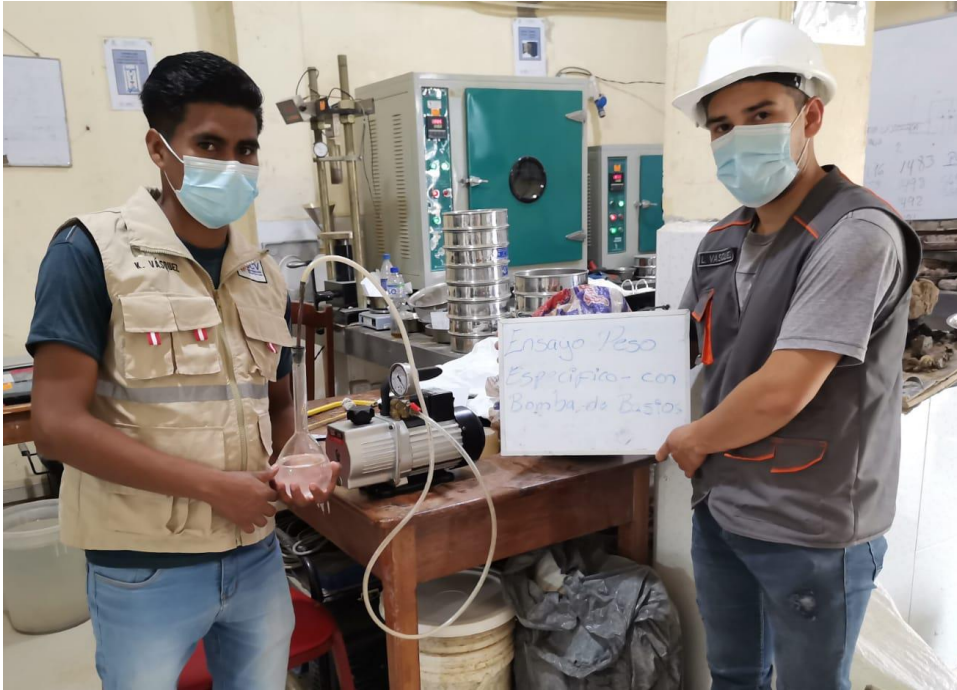
Figura 10 Ensayo de peso específico con bomba de vacíos- Fuente Propia.
