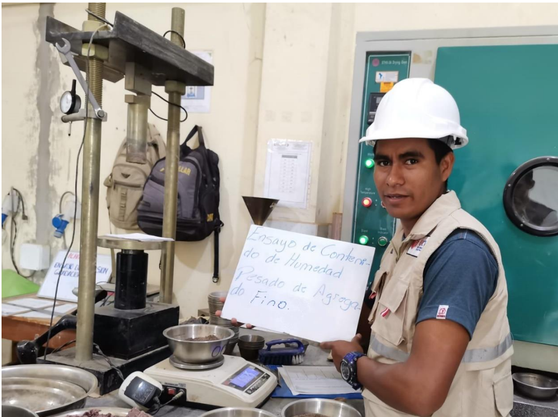
Figura 2 Pesado de Agregado Fino, ensayo Contenido de Humedad- Fuente Propia.
