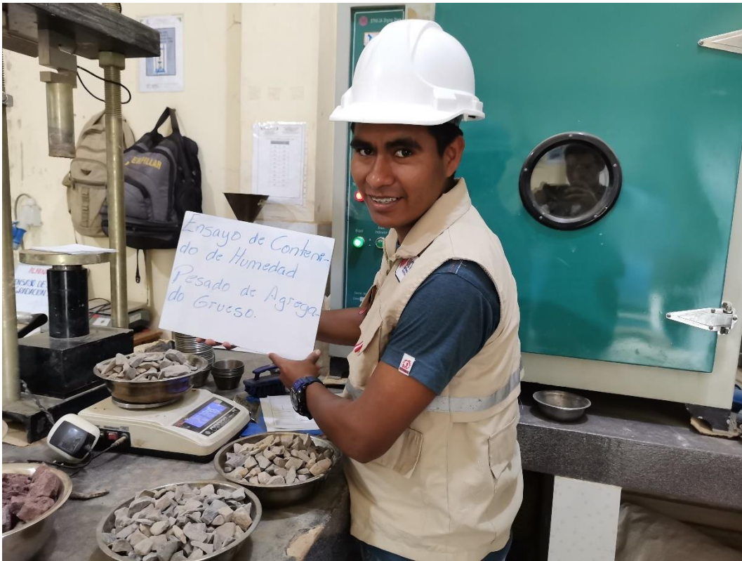
Figura 3 Pesado de Agregado Grueso, ensayo Contenido de Humedad- Fuente Propia
