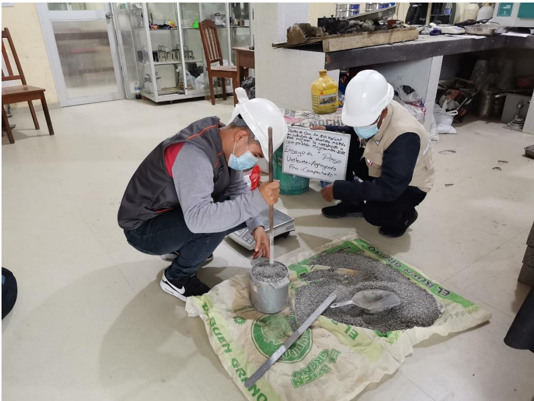
Figura 15 Ensayo peso unitario compactado del agregado fino- Fuente Propia.
