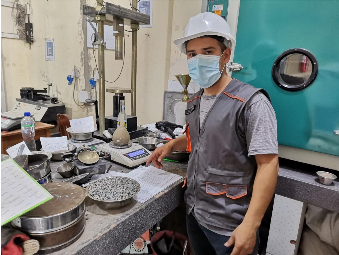
Figura 12 Ensayo de peso específico, pesado de la fiola, más el agregado fino más el agua- Fuente Propia.
