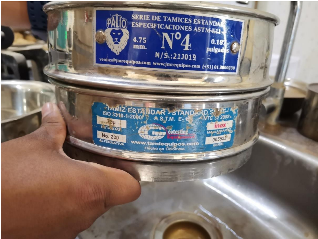
Tamiz de lavado para el agregado grueso, del ensayo de granulometría- Fuente Propia.
