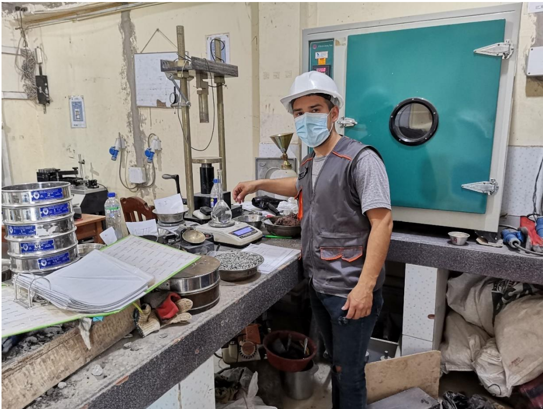
Figura 11 Ensayo peso específico, pesado de fiola más agua- Fuente Propia.
