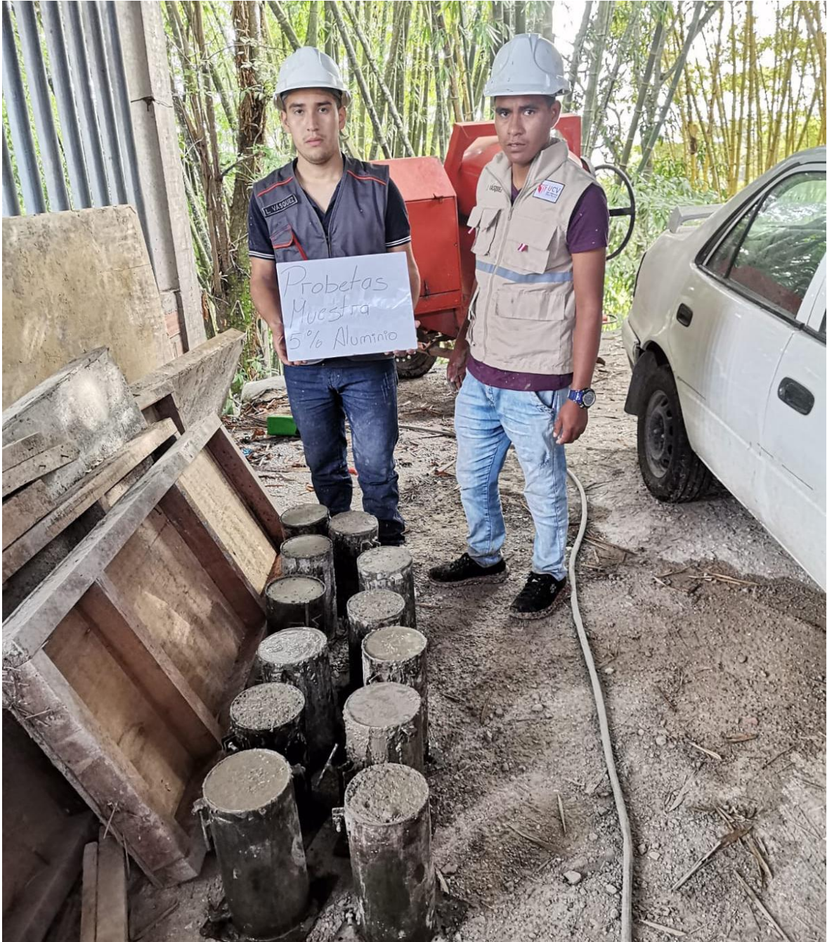
Figura 22 Probetas, con adición al 5% de aluminio molido- Fuente Propia.
