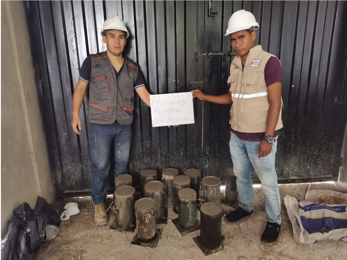
Figura 21 Probetas, con adición al 3% de aluminio- Fuente Propia.
