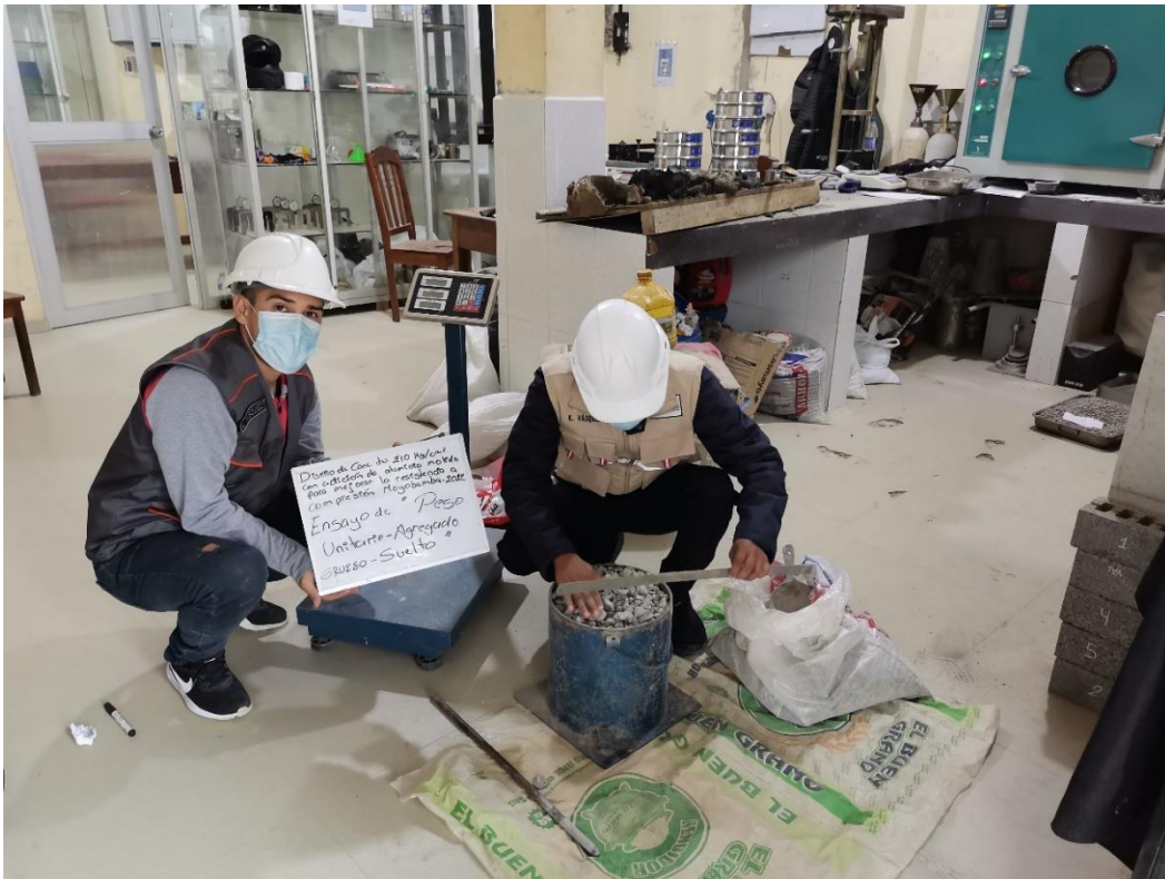
Figura 16 Ensayo peso unitario suelto del agregado grueso- Fuente Propia.
