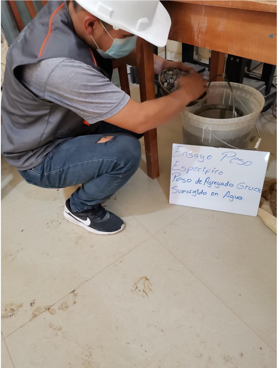
Figura 13 Ensayo de peso específico, del agregado grueso- Fuente Propia.
