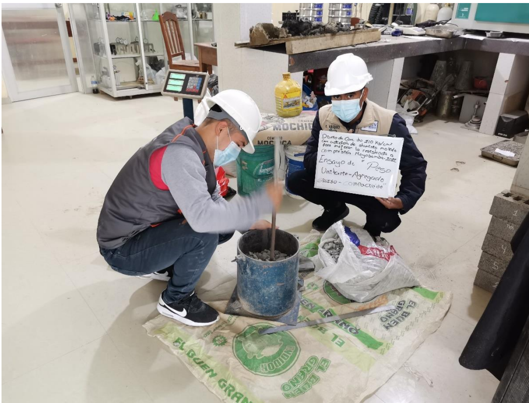
Figura 17 Ensayo peso unitario compactado del agregado grueso- Fuente Propia.
