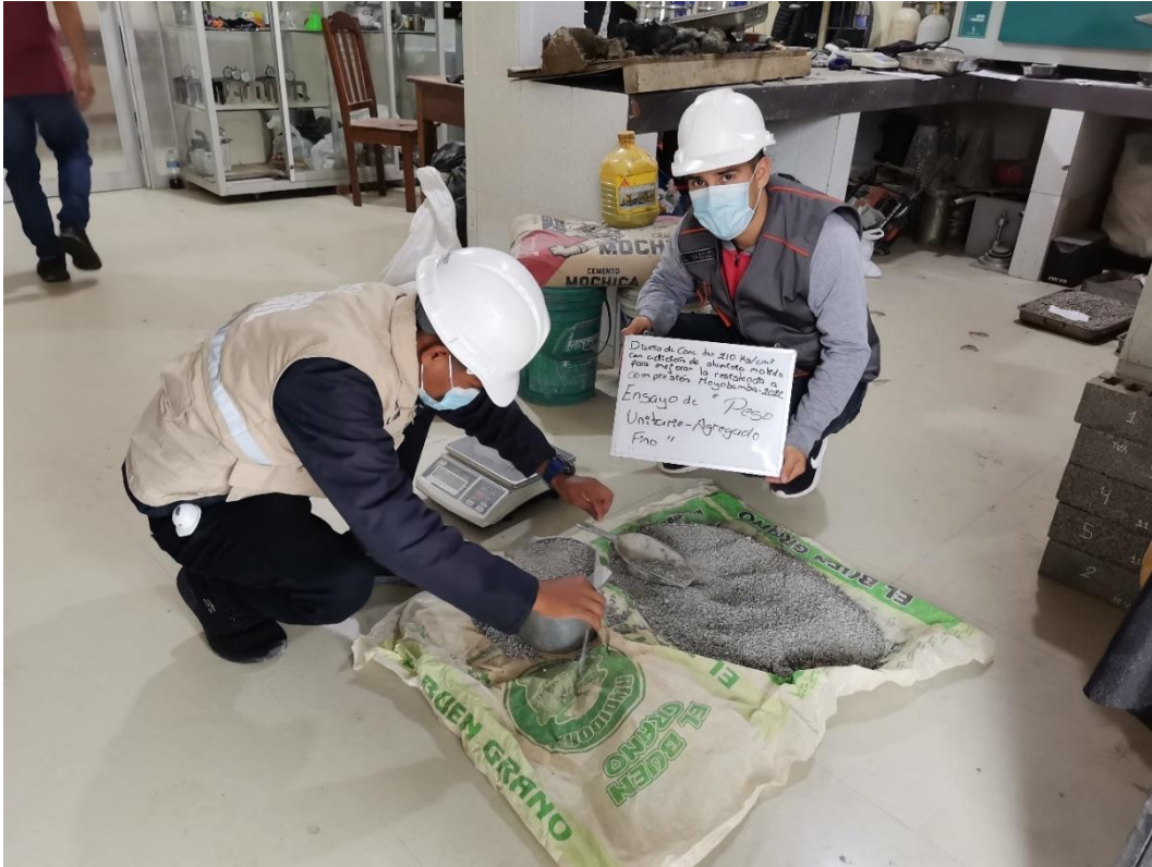
Figura 14 Ensayo de peso unitario suelto para el agregado fino- Fuente Propia.
