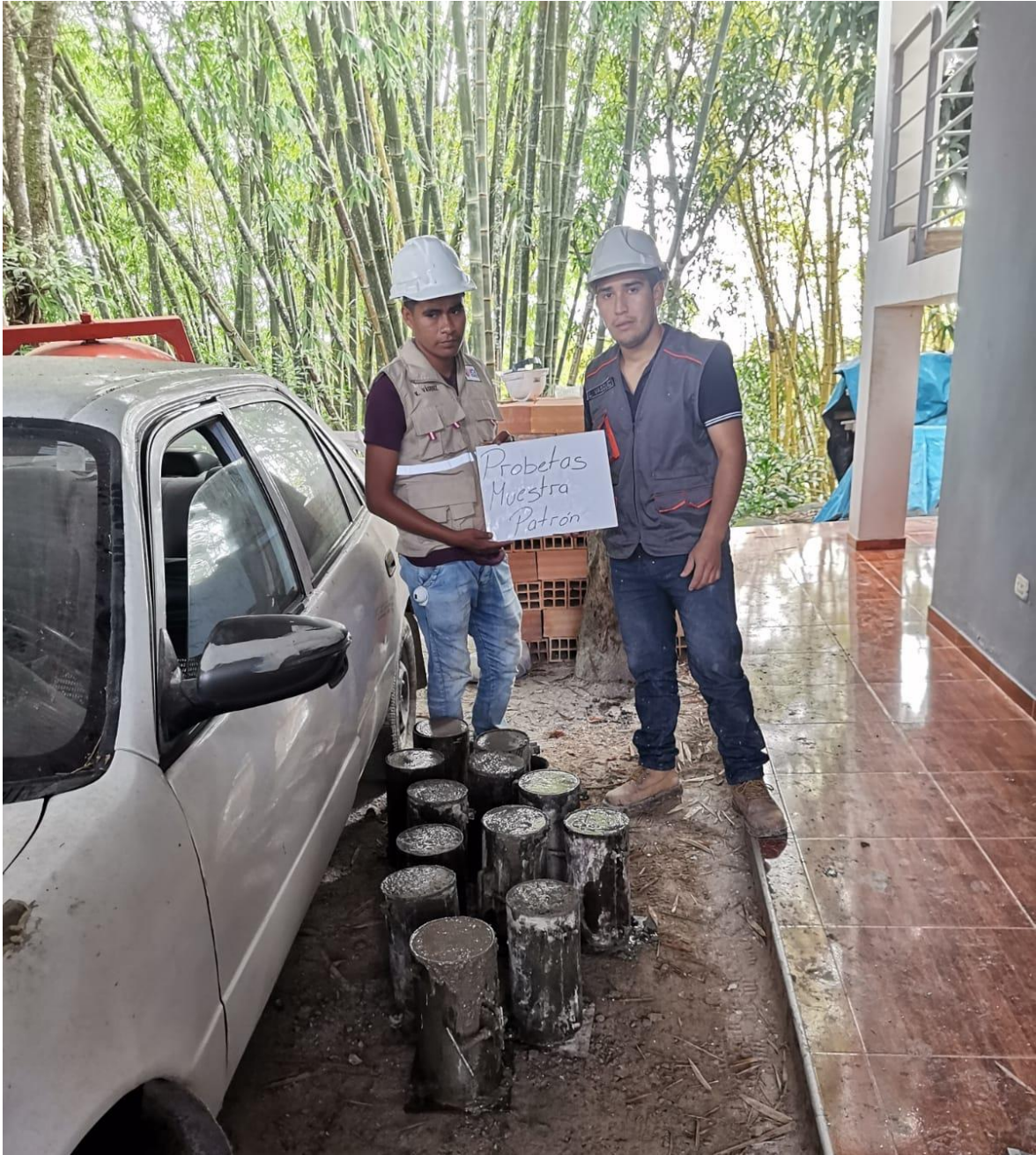
Figura 20 Probetas, muestra patrón- Fuente Propia.
