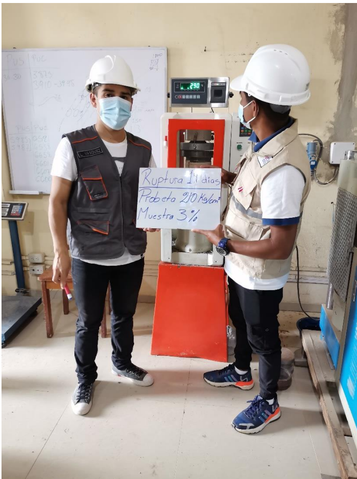
Figura 26 Ruptura de las probetas a los 14 días, tipo de falla 3- Fuente Propia.
