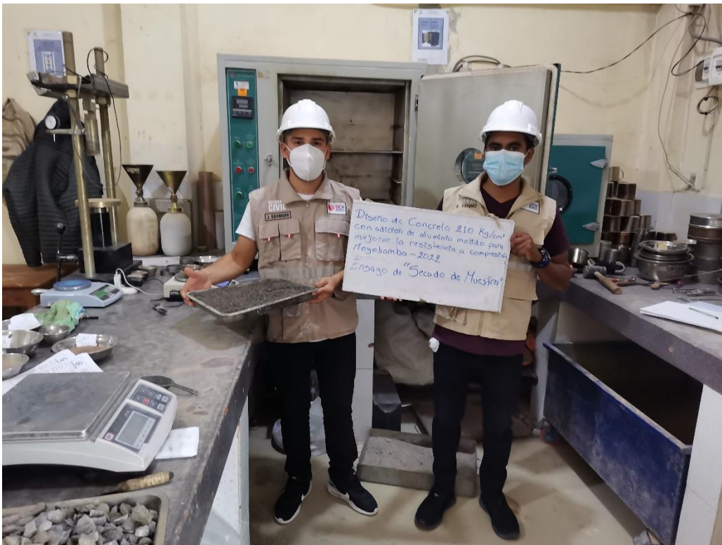
Figura 4 Secado de muestra del agregado fino para los ensayos de Granulometría y peso específico- Fuente Propia.
