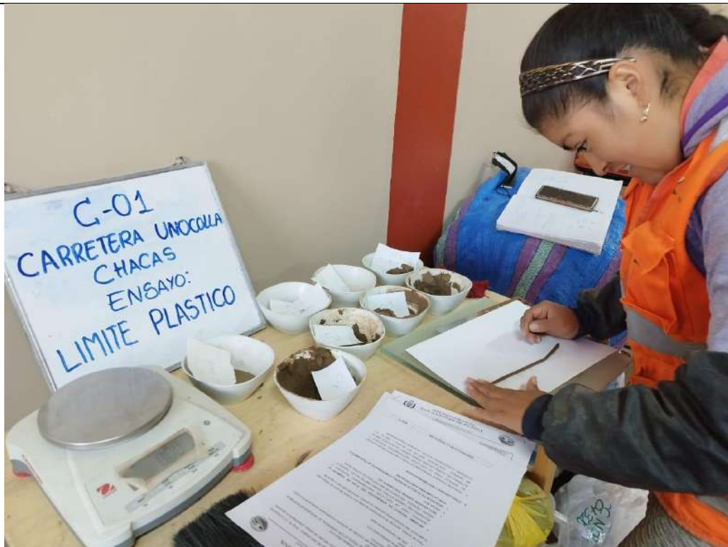
FOTO N°10: Ensayo de limite plástico en la copa de casa grande, cantera N° 1
