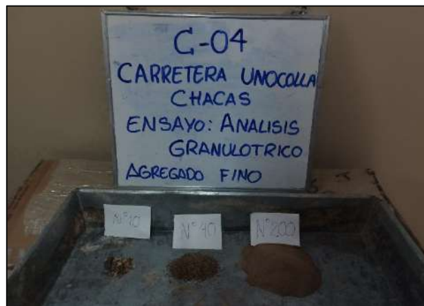
Figura 21. Distribución de partículas retenidas de acuerdo a su tamiz, calicata N°04. Fuente propia.
