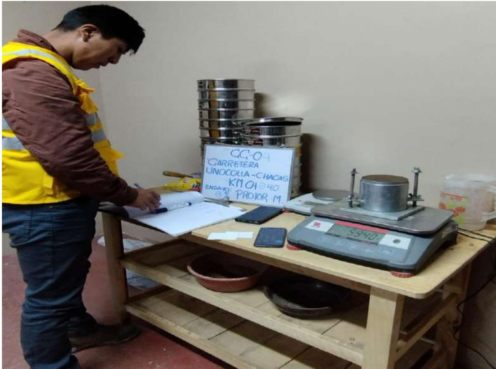
FOTO N°13: Pesado de molde más muestra del ensayo de Proctor.
