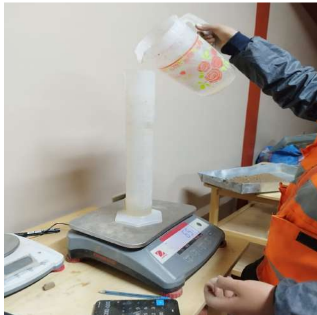
Figura 36. Se realiza el pesado para la humectación a la muestra. Fuente propia.
