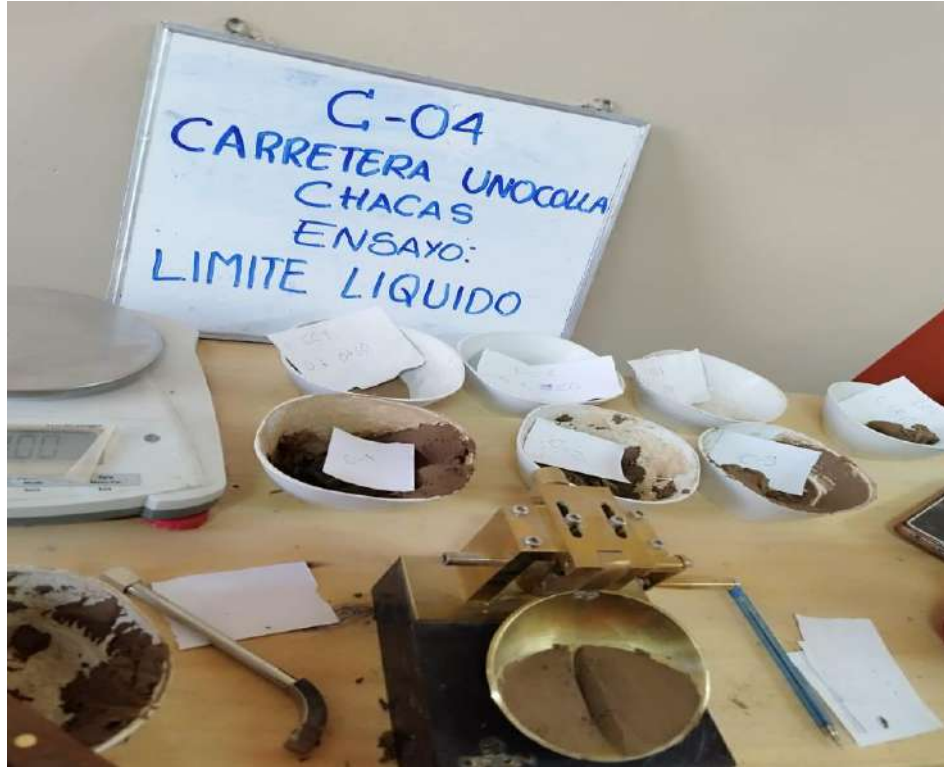
FOTO N°09: ensayo de limite liquido en la copa de casa grande, cantera N° 4.
