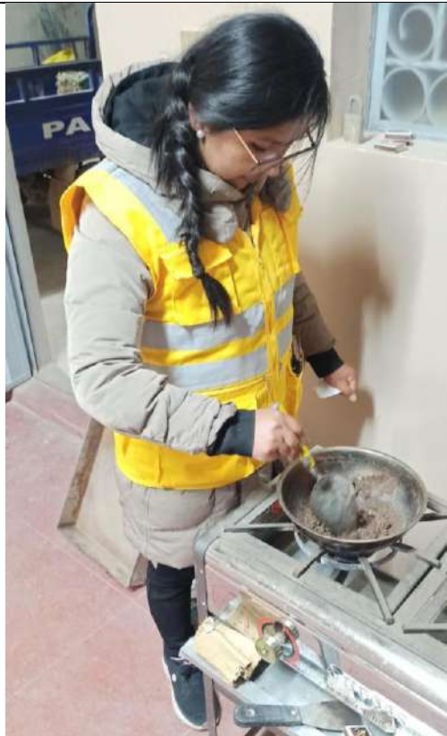
FOTO N°04: cocción de la muestra de contenido de humedad.
