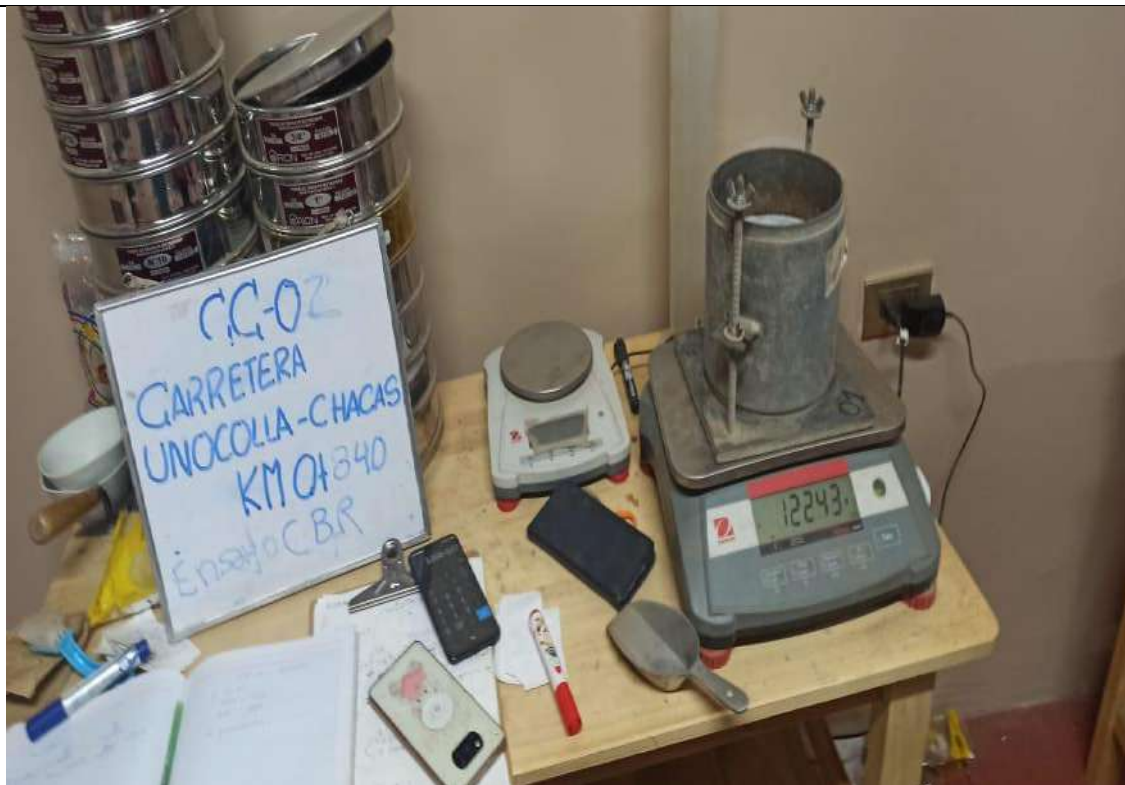
FOTO N°14: Pesado de molde del ensayo de CBR.
