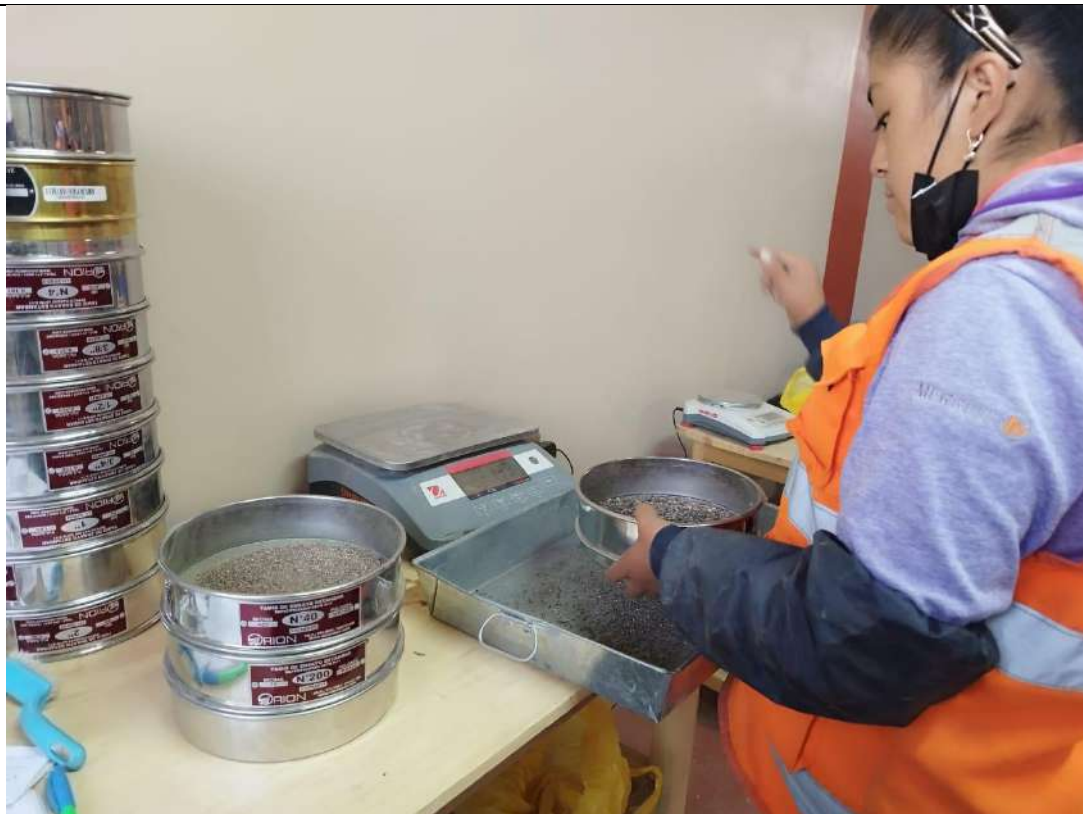
FOTO N°06: se realiza el tamiza de muestra de una de las calicatas
