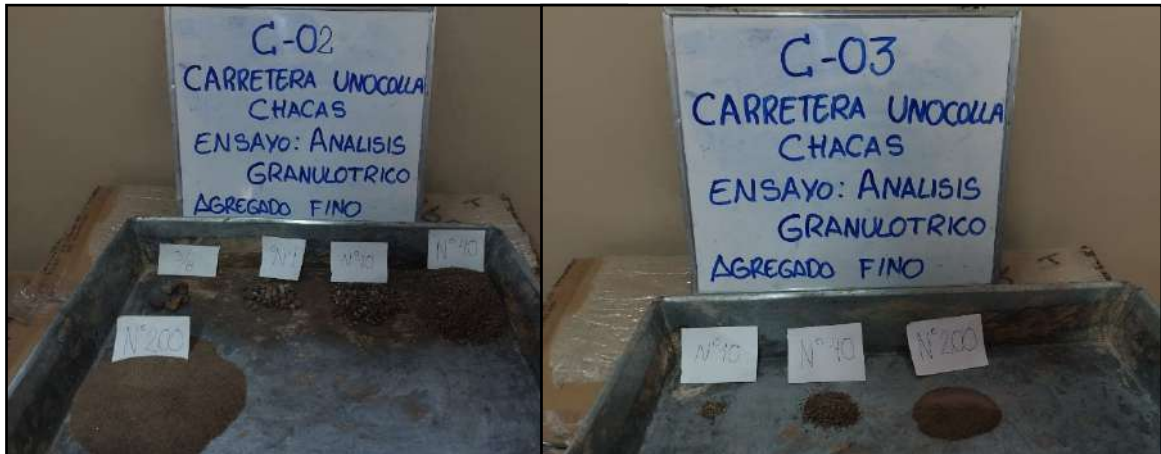
Figura 20. Distribución de partículas retenidas de acuerdo a su tamiz, calicata N°02 y calicata N°03. Fuente propia.
