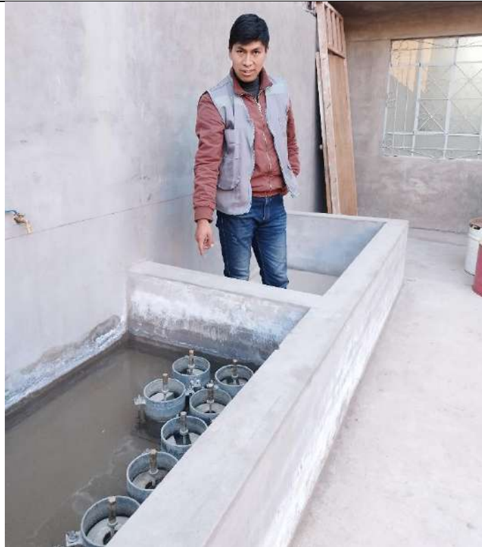
FOTO N°19: Proceso de expansión de las muestras del ensayo de CBR.
