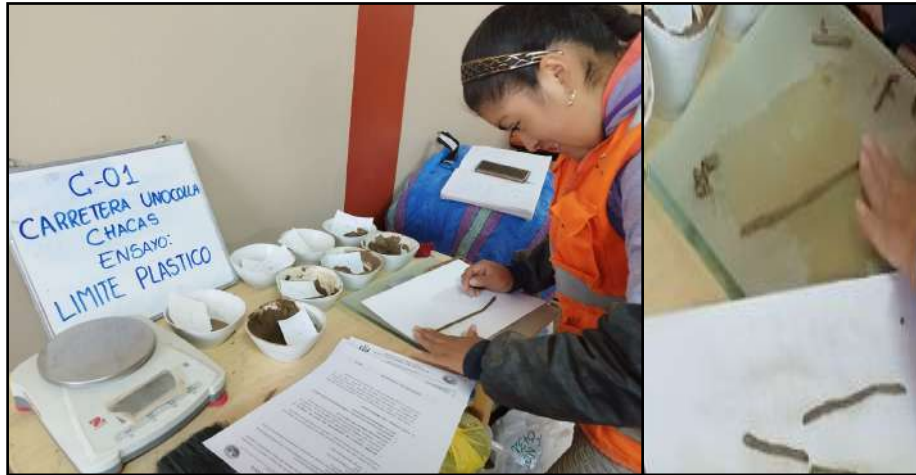
Figura 30. Se realiza el ensayo de índice de plasticidad, calicata N°01. Fuente propia.
