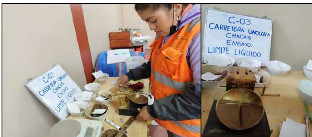
Figura 28. Se realizo los golpes en la copa de casa grande. Calicata N°03. Fuente propia.
