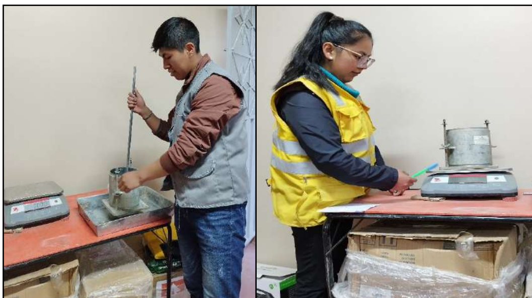
Figura 47. Varillado y pesado de muestras para calcular peso unitario. Fuente propia.
