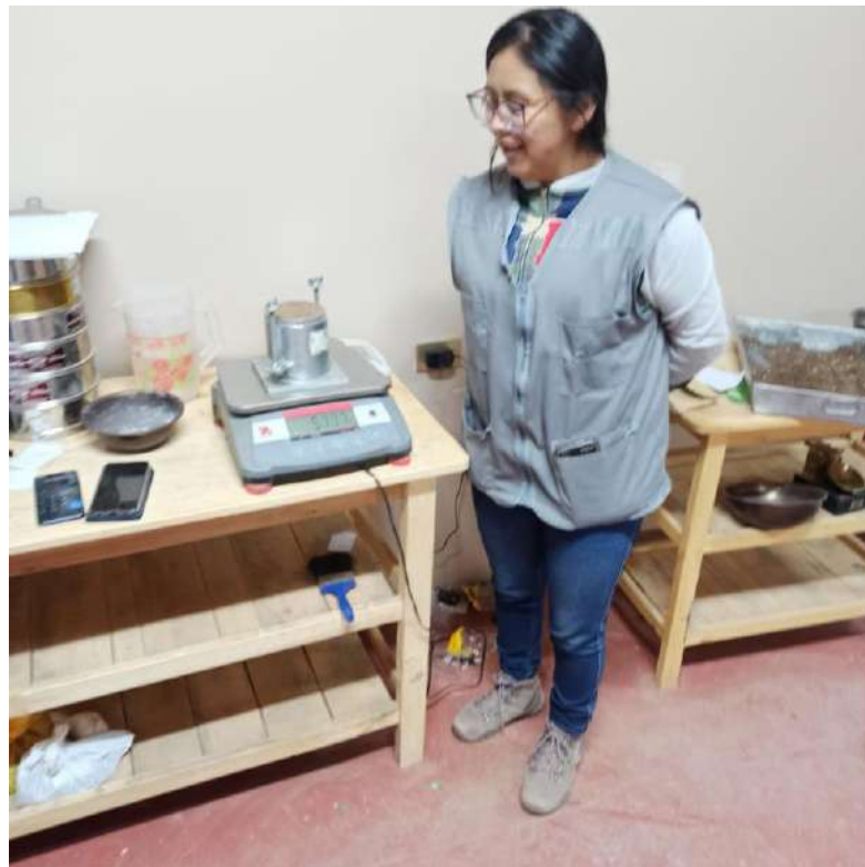
FOTO N°18: Pesado de molde más muestra del ensayo de CBR.
