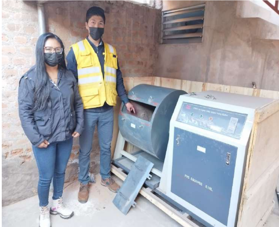
Figura 48. Ensayo de desgaste con la maquina los Ángeles. Fuente propia.
