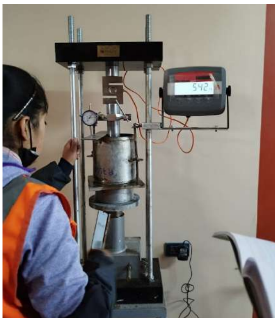
Figura 42. Se realiza la penetración del ensayo de CBR. Fuente propia.
