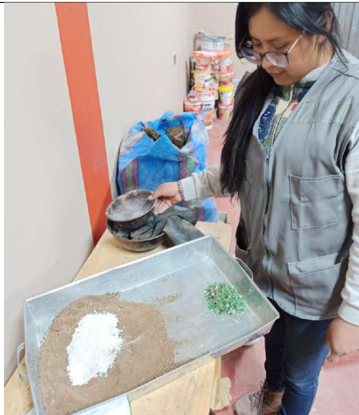
FOTO N°16: dosificación de aditivos de acuerdo al peso de la muestra.
