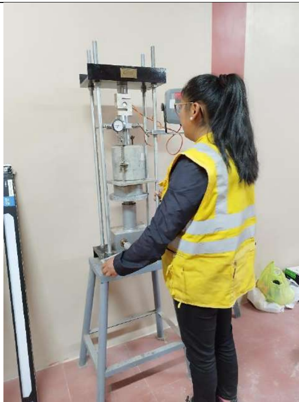
FOTO N°20: se realiza la penetración a las muestras del ensayo de CBR.
