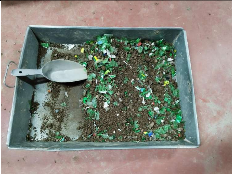
FOTO N°17: homogenización de la muestra con la adición de estabilizantes
