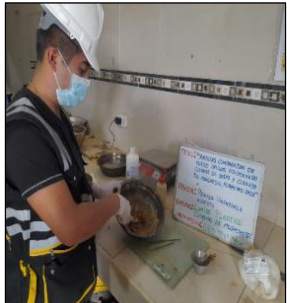
Figura 32: Ensayo de Limite Plástico adición de 9% de cloruro de magnesio, según referencia de la norma MTC E 111. FUENTE: Elaboración propia
