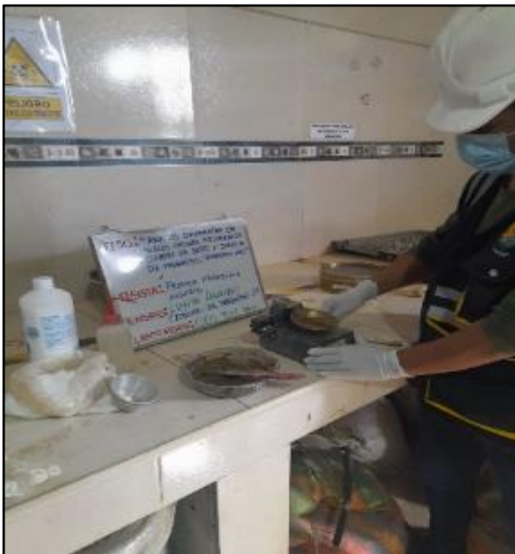
Figura 21: Ensayo de Limite Líquido con adición de 3% de cloruro de magnesio, según referencia de la norma MTC E 110. FUENTE: Elaboración propia
