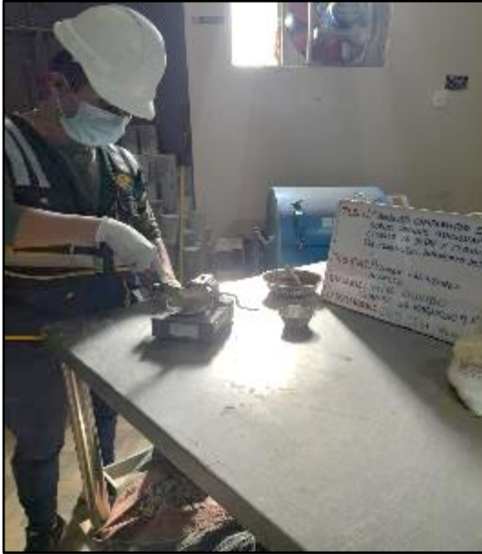
Figura 25: Ensayo de Limite Líquido con adición de 9% de cloruro de magnesio, según referencia de la norma MTC E 110. FUENTE: Elaboración propia
