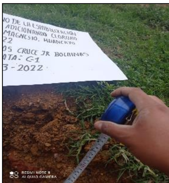
Figura 3: Medida y corroboración de los estratos de la calicata, según referencia de la norma MTC E 101. FUENTE: Elaboración propia
