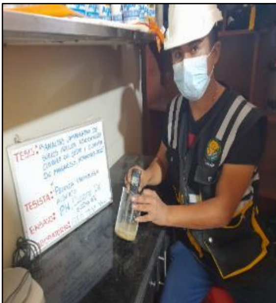
Figura 49: Análisis del ensayo de preparación de PH del suelo con adición de 6% de cloruro de sodio, según referencia de la norma MTC E 129. FUENTE: Elaboración propia
