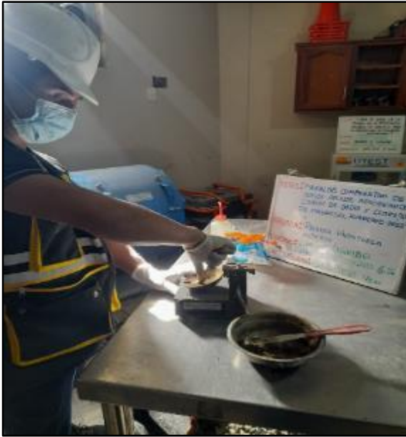
Figura 19: Ensayo de Limite Líquido con adición de 6% de cloruro de sodio, según referencia de la norma MTC E 110. FUENTE: Elaboración propia
