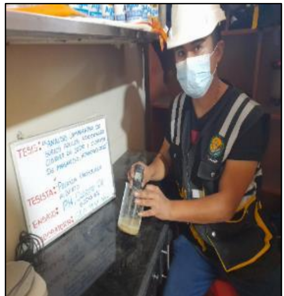
Figura 50: Análisis del ensayo de preparación de PH del suelo con adición de 9% de cloruro de sodio, según referencia de la norma MTC E 129. FUENTE: Elaboración propia
