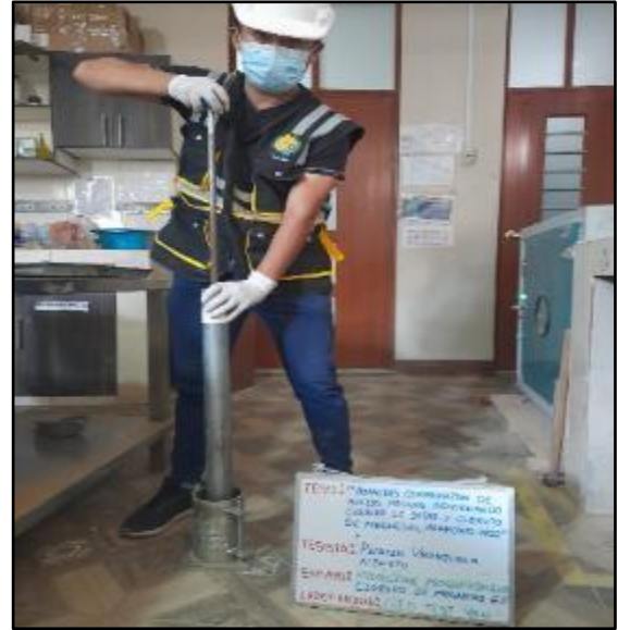
Figura 38: Apisonamiento del material con adición de 6% de cloruro de magnesio dentro del molde en 5 capas, en un molde con 56 golpes, según referencia de la norma MTC E 115. FUENTE: Elaboración propia
