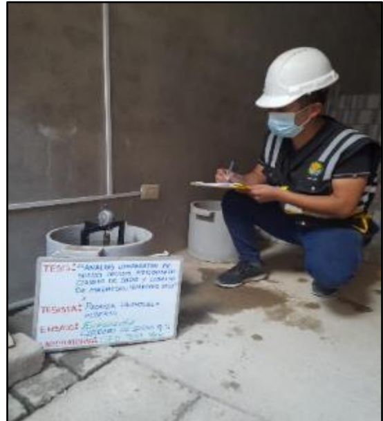
Figura 57: Sumergido de los moldes por 96 horas siendo medido la expansión cada 24 horas con adición de 9% de cloruro de sodio, según referencia de la norma MTC E 132. FUENTE: Elaboración propia
