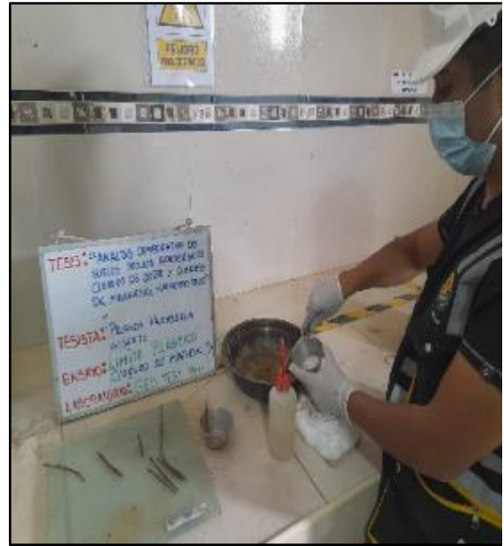
Figura 30: Ensayo de Limite Plástico adición de 3% de cloruro de magnesio, según referencia de la norma MTC E 111. FUENTE: Elaboración propia
