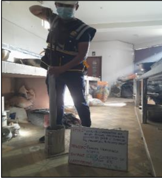
Figura 44: Apisonamiento del material dentro del molde en 5 capas, en un molde con 56 golpes, en el segundo molde por 25 golpes y en el tercer molde 12 golpes con adición 3% de cloruro de magnesio, según referencia de la norma MTC E 132. FUENTE: Elaboración propia.
