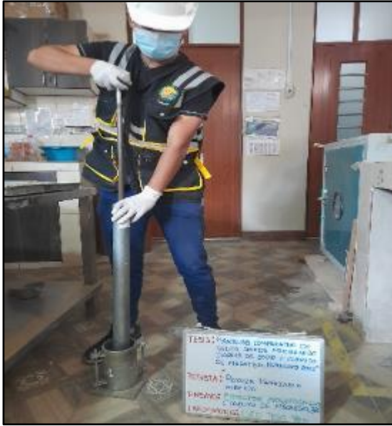
Figura 37: Apisonamiento del material con adición de 3% de cloruro de magnesio dentro del molde en 5 capas, en un molde con 56 golpes, según referencia de la norma MTC E 115. FUENTE: Elaboración propia
