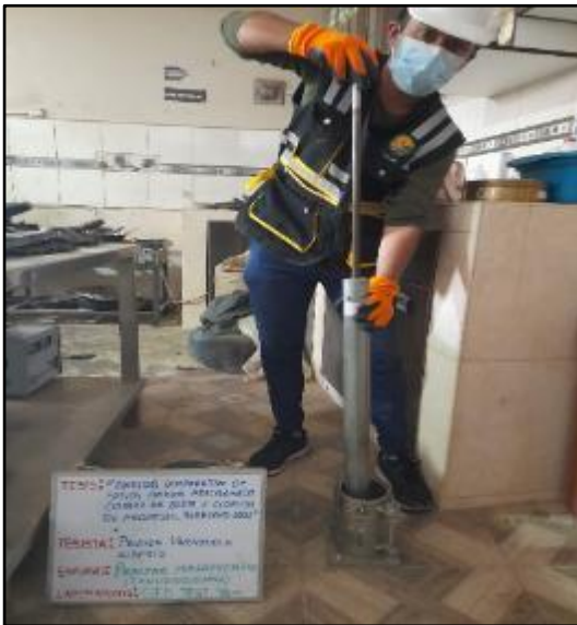
Figura 40: Apisonamiento del material dentro del molde en 5 capas, en un molde con 56 golpes, en el segundo molde por 25 golpes y en el tercer molde 12 golpes, según referencia de la norma MTC E 132. FUENTE: Elaboración propia
