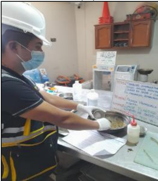
Figura 27: Ensayo de Limite Plástico adición de 3% de cloruro de sodio, según referencia de la norma MTC E 111. FUENTE: Elaboración propia
