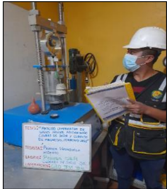
Figura 62: Ensayo para la determinación de un índice de resistencia del suelo, registro de penetración en el dial, 0.025 plg a 0.500 plg con adición de 3% de cloruro de sodio, según referencia de la norma MTC E 132. FUENTE: Elaboración propia
