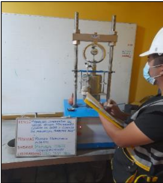
Figura 61: Ensayo para la determinación de un índice de resistencia del suelo, Lectura de penetración en el dial, 0.025 plg a 0.500 plg convencional, según referencia de la norma MTC E 132. FUENTE: Elaboración propia
