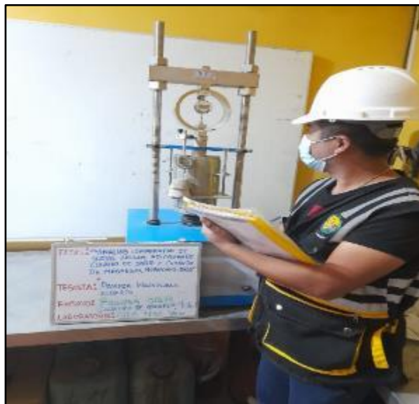
Figura 67: Ensayo para la determinación de un índice de resistencia del suelo, registro de penetración en el dial, 0.025 plg a 0.500 plg con adición de 9% de cloruro de magnesio, según referencia de la norma MTC E 132. FUENTE: Elaboración propia
