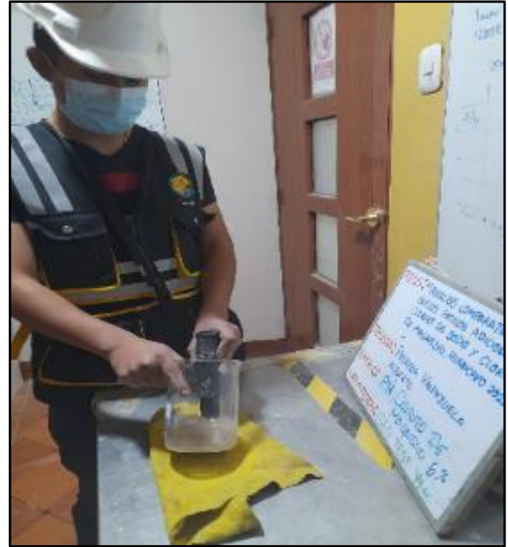
Figura 52: Análisis del ensayo de preparación de PH del suelo con adición de 6% de cloruro de magnesio, según referencia de la norma MTC E 129. FUENTE: Elaboración propia
