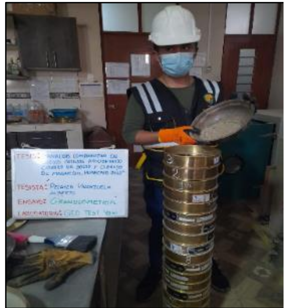
Figura 14: Ensayo de análisis granulométrico, separación de material por tamaño de partículas método de tamizado, según referencia de la norma MTC E 107. FUENTE: Elaboración propia
