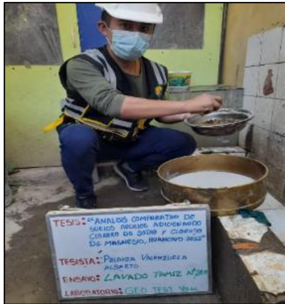
Figura 16: Ensayo del material más fino que pasa por el tamiz N°200, según referencia de la norma MTC E 202. FUENTE: Elaboración propia
