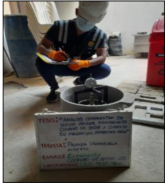
Figura 55: Sumergido de los moldes por 96 horas siendo medido la expansión cada 24 horas con adición de 3% de cloruro de sodio, según referencia de la norma MTC E 132. FUENTE: Elaboración propia
