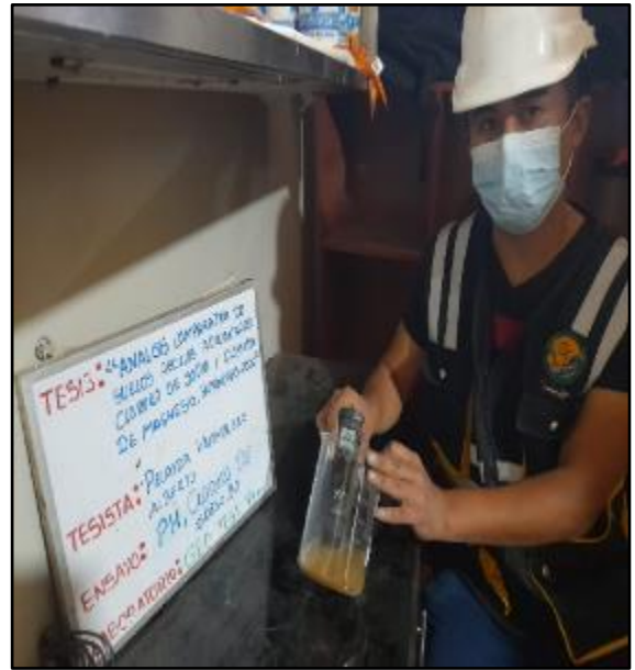
Figura 48: Análisis del ensayo de preparación de Ph del suelo con adición de 3# de cloruro de sodio, según referencia de la norma MTC E129. FUENTE: Elaboración propia.
