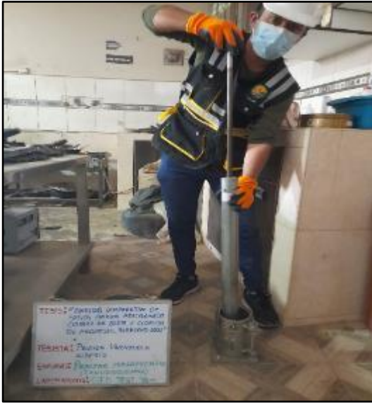
Figura 33: Apisonamiento del material convencional dentro del molde en 5 capas, en un molde con 56 golpes, según referencia de la norma MTC E 115. FUENTE: Elaboración propia
