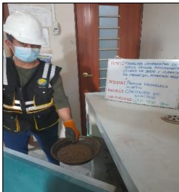
Figura 15: Ensayo para determinar el contenido humedad del suelo, según referencia de la norma MTC E 108. FUENTE: Elaboración propia
