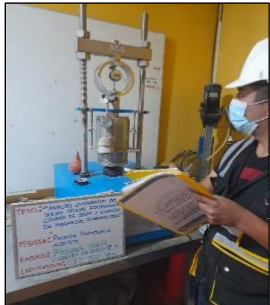
Figura 64: Ensayo para la determinación de un índice de resistencia del suelo, registro de penetración en el dial, 0.025 plg a 0.500 plg con adición de 9% de cloruro de sodio, según referencia de la norma MTC E 132. FUENTE: Elaboración propia
