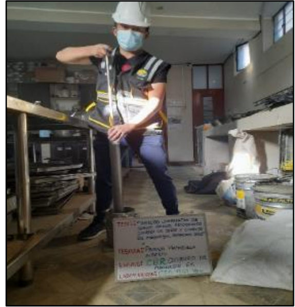
Figura 45: Apisonamiento del material dentro del molde en 5 capas, en un molde con 56 golpes, en el segundo molde por 25 golpes y en el tercer molde 12 golpes con adición 6% de cloruro de magnesio, según referencia de la norma MTC E 132. FUENTE: Elaboración propia.
