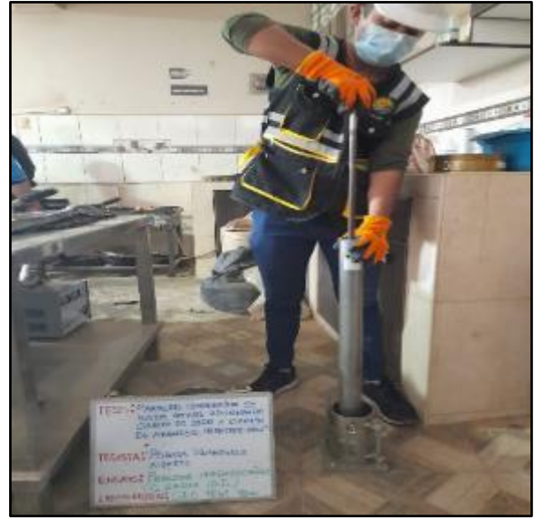
Figura 34: Apisonamiento del material con adición de 3% de cloruro de sodio dentro del molde en 5 capas, en un molde con 56 golpes, según referencia de la norma MTC E 115. FUENTE: Elaboración propia
