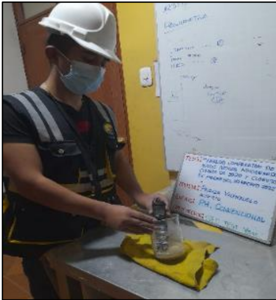
Figura 47: Análisis de PH del suelo convencional, según referencia de la norma MTC E 129. FUENTE: Elaboración propia.
