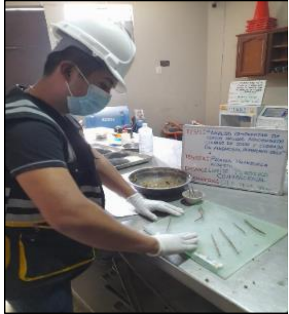
Figura 26: Ensayo de Limite Plástico convencional, según referencia de la norma MTC E 111. FUENTE: Elaboración propia
