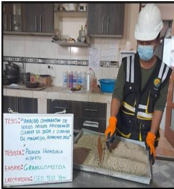
Figura 13: Ensayo de análisis granulométrico, separación de material por tamaño de partículas método de tamizado, según referencia de la norma MTC E 107. FUENTE: Elaboración propia
