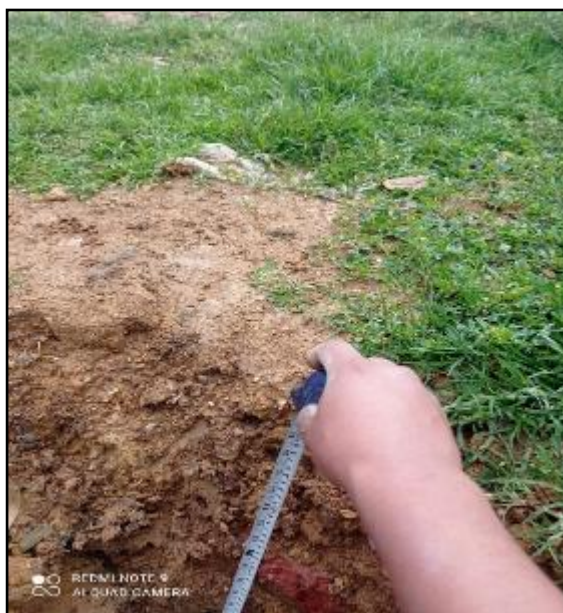
Figura 11: Medida y corroboración de los estratos de la calicata, según referencia de la norma MTC E 101. FUENTE: Elaboración propia
