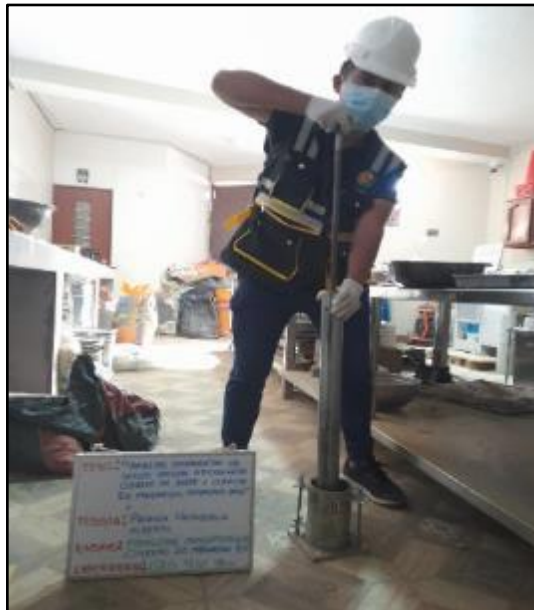
Figura 46: Apisonamiento del material dentro del molde en 5 capas, en un molde con 56 golpes, en el segundo molde por 25 golpes y en el tercer molde 12 golpes con adición 9% de cloruro de magnesio, según referencia de la norma MTC E 132. FUENTE: Elaboración propia.
