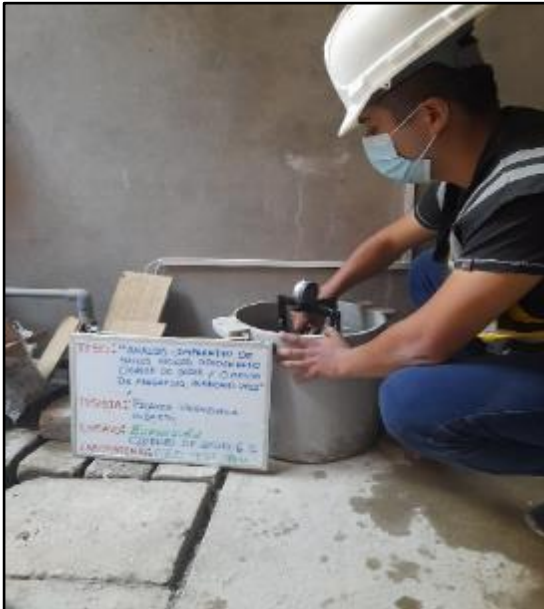
Figura 56: Sumergido de los moldes por 96 horas siendo medido la expansión cada 24 horas con adición de 6% de cloruro de sodio, según referencia de la norma MTC E 132. FUENTE: Elaboración propia
