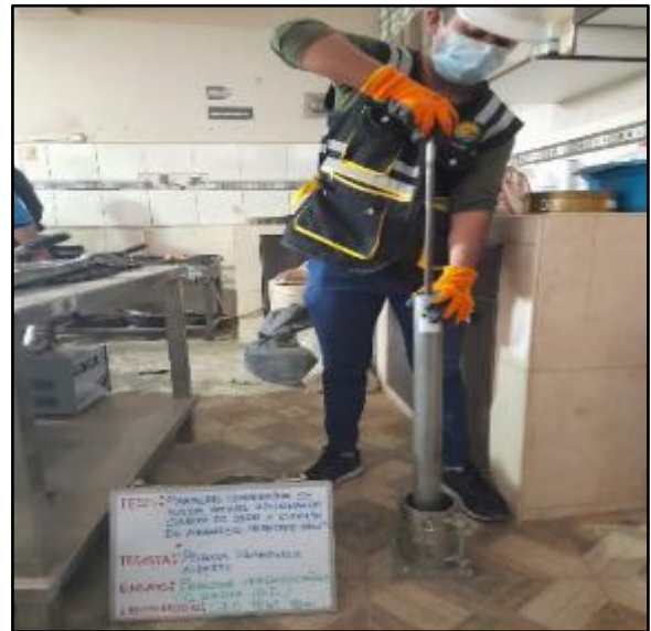
Figura 41: Apisonamiento del material dentro del molde en 5 capas, en un molde con 56 golpes, en el segundo molde por 25 golpes y en el tercer molde 12 golpes con adición 3% de cloruro de sodio, según referencia de la norma MTC E 132. FUENTE: Elaboración propia
