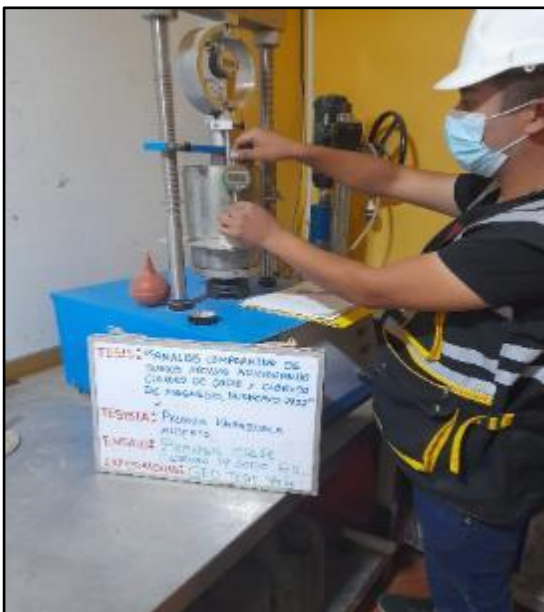
Figura 63: Ensayo para la determinación de un índice de resistencia del suelo, registro de penetración en el dial, 0.025 plg a 0.500 plg con adición de 6% de cloruro de sodio, según referencia de la norma MTC E 132. FUENTE: Elaboración propia
