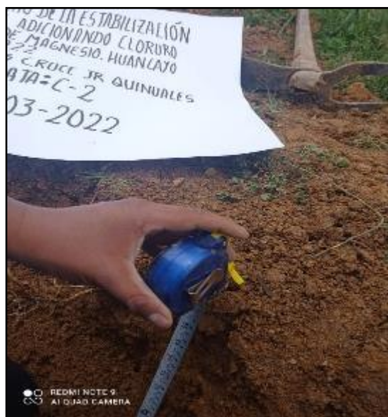
Figura 7: Medida y corroboración de los estratos de la calicata, según referencia de la norma MTC E 101. FUENTE: Elaboración propia
