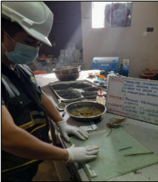
Figura 29: Ensayo de Limite Plástico adición de 9% de cloruro de sodio, según referencia de la norma MTC E 111. FUENTE: Elaboración propia
