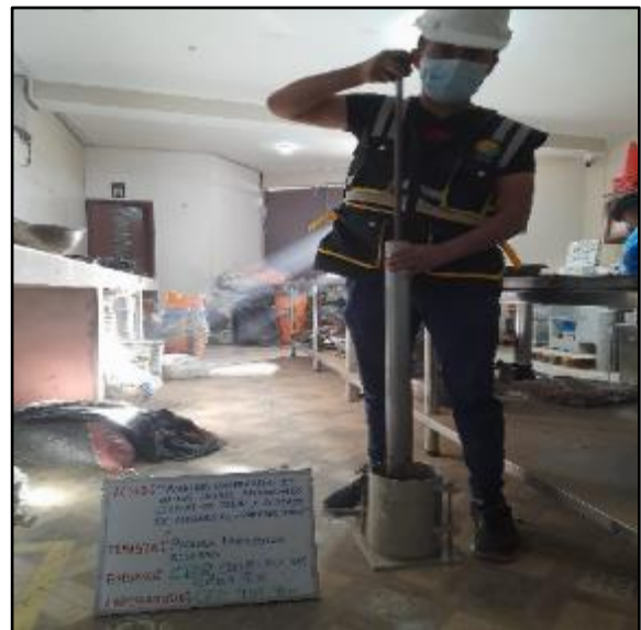
Figura 43: Apisonamiento del material dentro del molde en 5 capas, en un molde con 56 golpes, en el segundo molde por 25 golpes y en el tercer molde 12 golpes con adición 9% de cloruro de sodio, según referencia de la norma MTC E 132. FUENTE: Elaboración propia.
