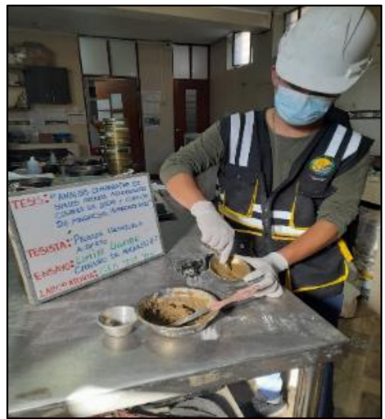
Figura 22: Ensayo de Limite Líquido con adición de 6% de cloruro de magnesio, según referencia de la norma MTC E 110. FUENTE: Elaboración propia
