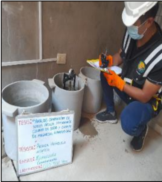
Figura 54: Sumergido de los moldes por 96 horas siendo medido la expansión cada 24 horas, según referencia de la norma MTC E 132. FUENTE: Elaboración propia
