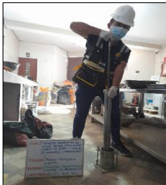
Figura 39: Apisonamiento del material con adición de 9% de cloruro de magnesio dentro del molde en 5 capas, en un molde con 56 golpes, según referencia de la norma MTC E 115. FUENTE: Elaboración propia
