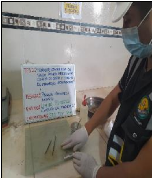
Figura 31: Ensayo de Limite Plástico adición de 6% de cloruro de magnesio, según referencia de la norma MTC E 111. FUENTE: Elaboración propia
