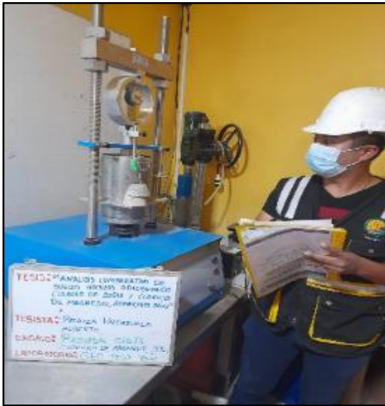
Figura 65: Ensayo para la determinación de un índice de resistencia del suelo, registro de penetración en el dial, 0.025 plg a 0.500 plg con adición de 3% de cloruro de magnesio, según referencia de la norma MTC E 132. FUENTE: Elaboración propia
