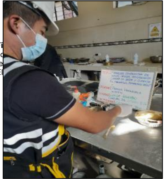
Figura 20: Ensayo de Limite Líquido con adición de 9% de cloruro de sodio, según referencia de la norma MTC E 110. FUENTE: Elaboración propia
