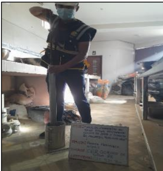
Figura 42: Apisonamiento del material dentro del molde en 5 capas, en un molde con 56 golpes, en el segundo molde por 25 golpes y en el tercer molde 12 golpes con adición 6% de cloruro de sodio, según referencia de la norma MTC E 132. FUENTE: Elaboración propia.
