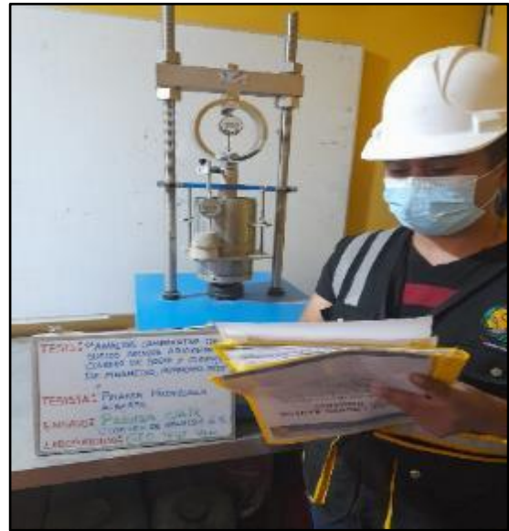
Figura 66: Ensayo para la determinación de un índice de resistencia del suelo, registro de penetración en el dial, 0.025 plg a 0.500 plg con adición de 6% de cloruro de magnesio, según referencia de la norma MTC E 132. FUENTE: Elaboración propia
