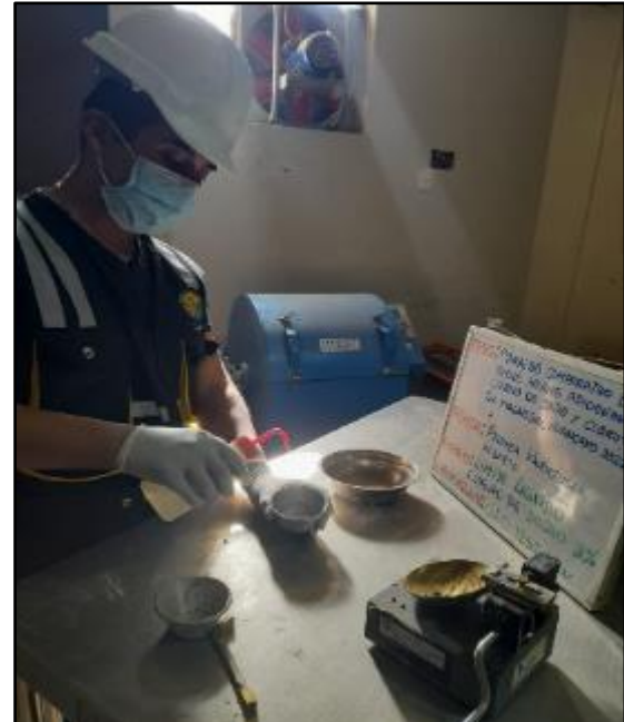
Figura 18: Ensayo de Limite Líquido con adición de 3% de cloruro de sodio, según referencia de la norma MTC E 110. FUENTE: Elaboración propia
