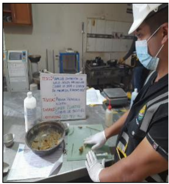
Figura 28: Ensayo de Limite Plástico adición de 6% de cloruro de sodio, según referencia de la norma MTC E 111. FUENTE: Elaboración propia
