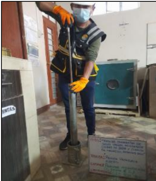
Figura 35: Apisonamiento del material con adición de 6% de cloruro de sodio dentro del molde en 5 capas, en un molde con 56 golpes, según referencia de la norma MTC E 115. FUENTE: Elaboración propia.
