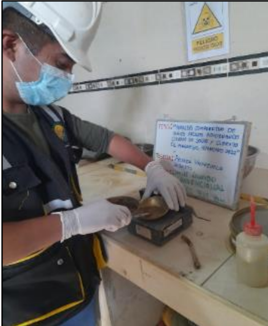
Figura 17: Ensayo de Limite Líquido convencional, según referencia de la norma MTC E 110. FUENTE: Elaboración propia
