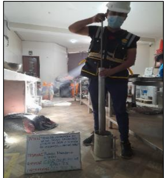
Figura 36: Apisonamiento del material con adición de 9% de cloruro de sodio dentro del molde en 5 capas, en un molde con 56 golpes, según referencia de la norma MTC E 115. FUENTE: Elaboración propia
