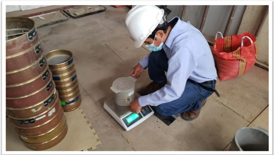
Fotografía 5: pesando el agregado fino para el ensayo de peso unitario varillado
