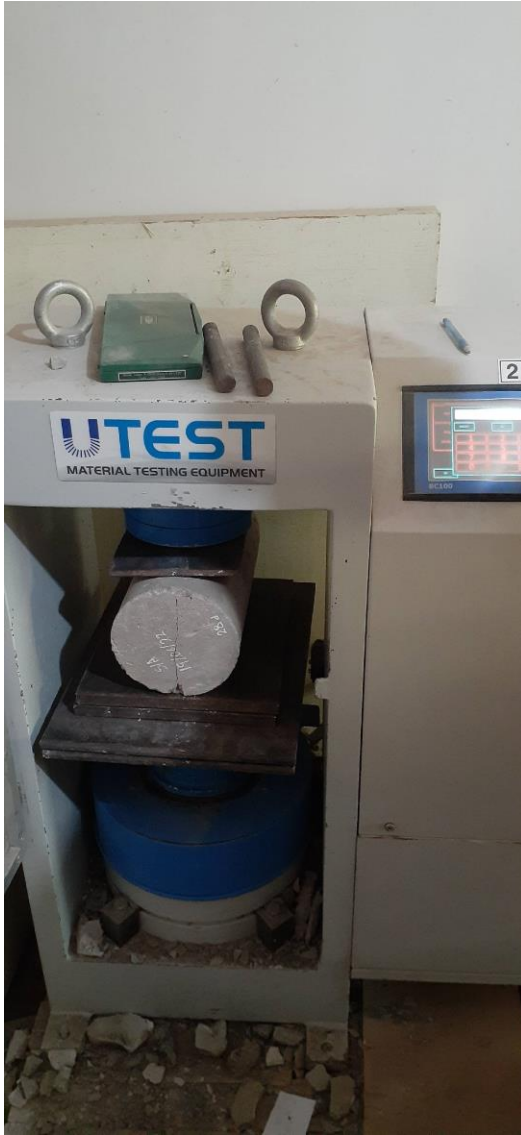
Fotografías 54 y 55: ensayo de tracción indirecta
