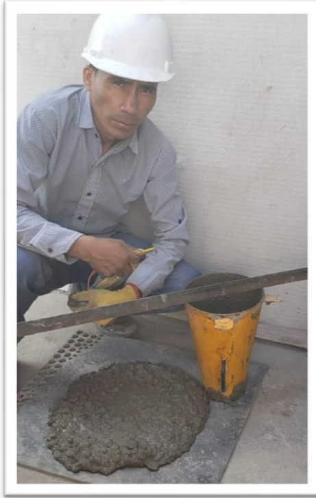
Fotografía 44: realizando la medida de revenimiento
