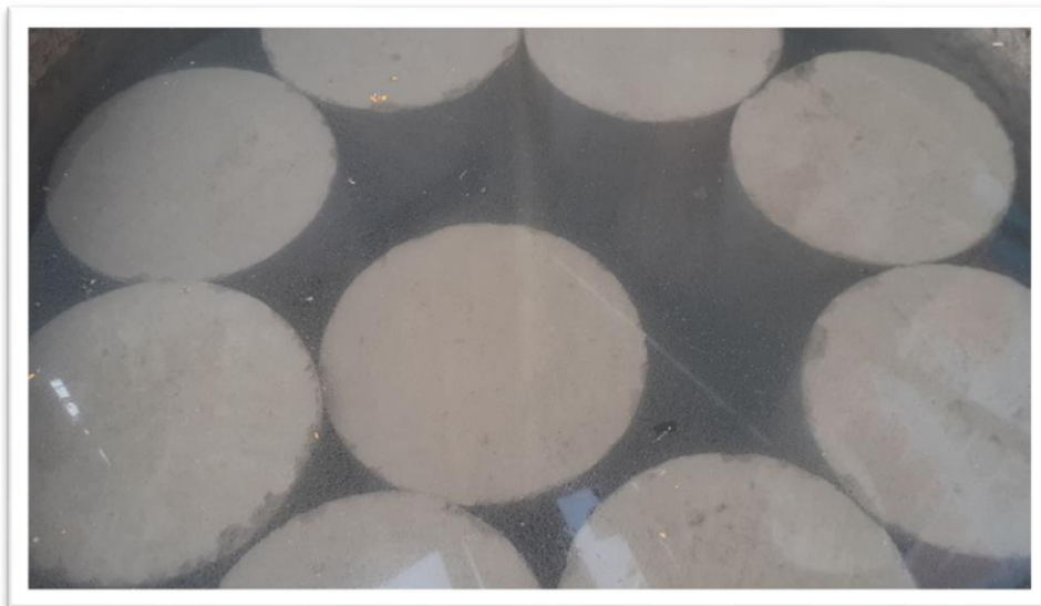
Fotografía 23: curado de testigos por inmersión en agua
