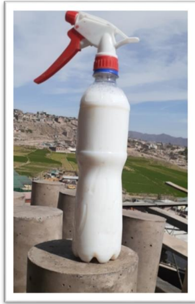
Fotografía 39: testigos curados con membranal reforzado
