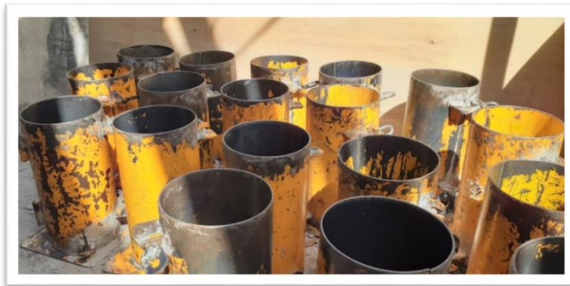
Fotografía 34: moldes para elaborar los testigos de concreto
