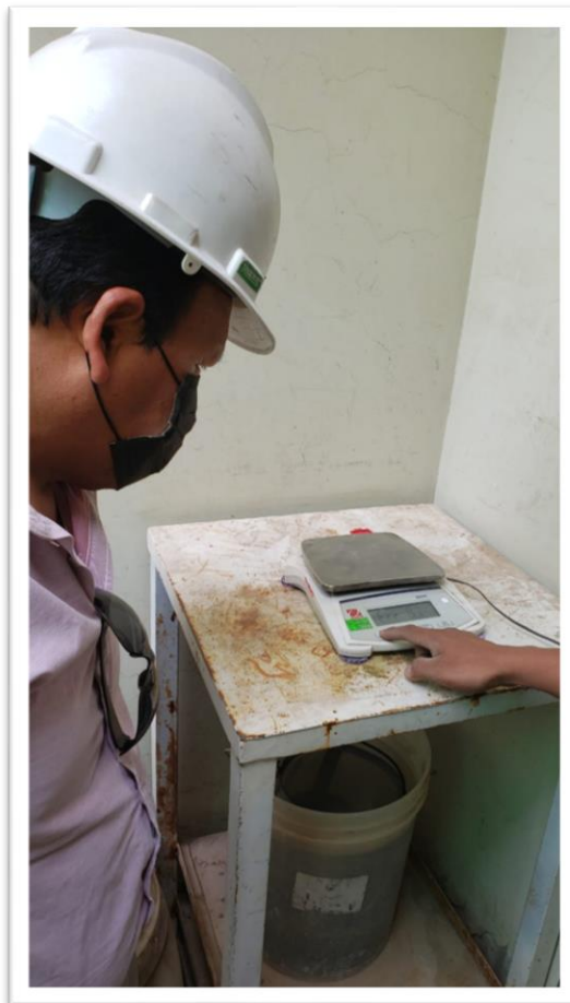
Fotografía 11: peso específico y absorción del agregado grueso
