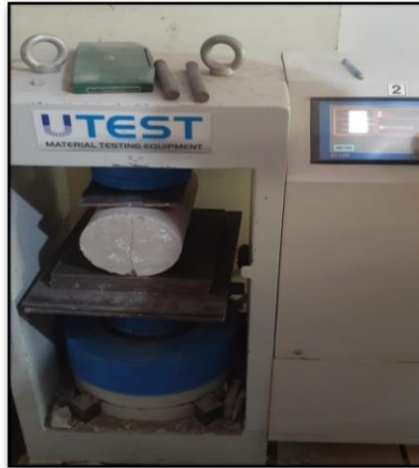
Figura 3. Ensayo de resistencia a la tracción indirecta por compresión diametral.
