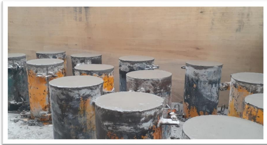
Fotografía 30: testigos elaborados para pruebas de resistencia a compresión
