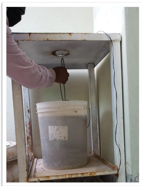
Fotografía 12: peso específico y absorción del agregado grueso
