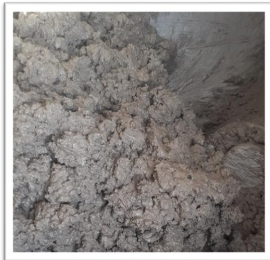
Fotografía 17: consistencia de la mezcla sin alterar el agua requerida
