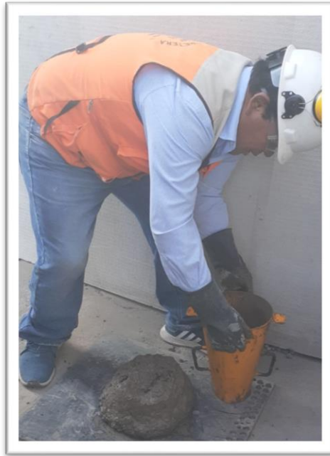
Fotografía 26: ensayo de revenimiento
