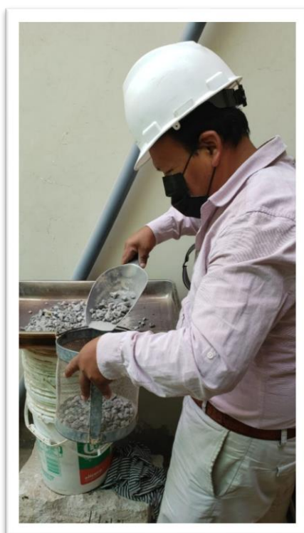
Fotografía 13: peso específico y absorción del agregado grueso
