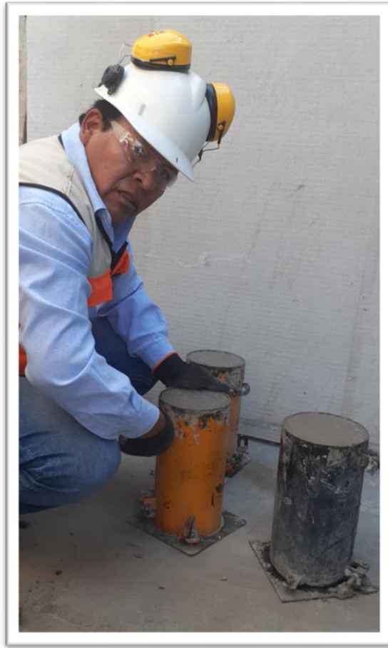
Fotografía 19: desmoldado de testigos
