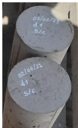
Fotografía 35: testigos expuestos al medio ambiente sin curado alguno
