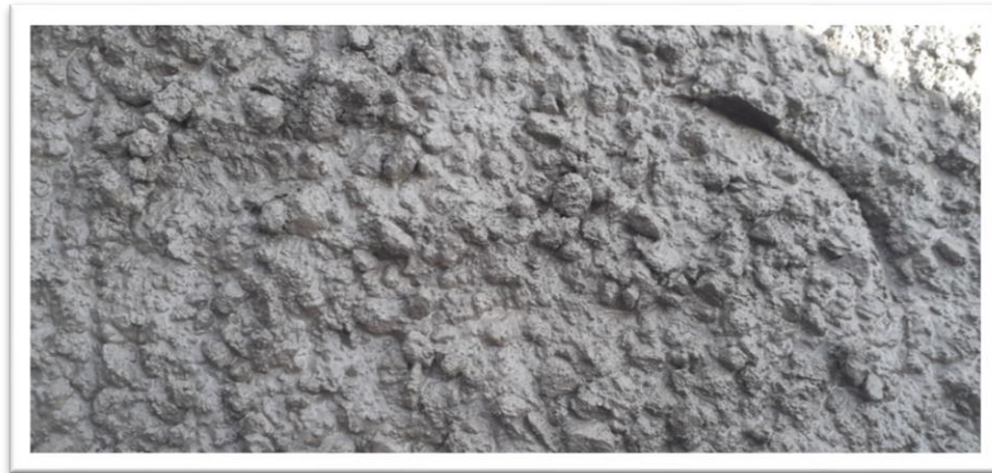
Fotografía 16: consistencia con 8 % más de agua requerida
