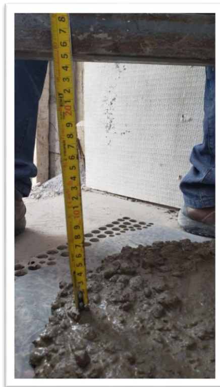
Fotografía 43: midiendo slump de concreto con 16 % más de agua requerida
