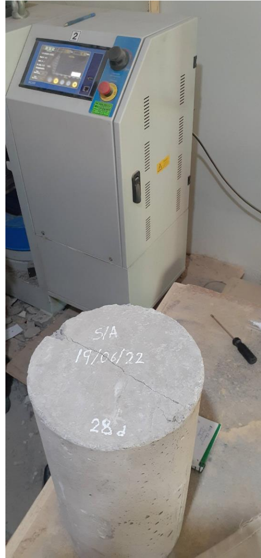
Fotografías 54 y 55: ensayo de tracción indirecta
