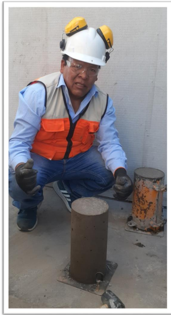
Fotografía 21: desmoldado de testigos
