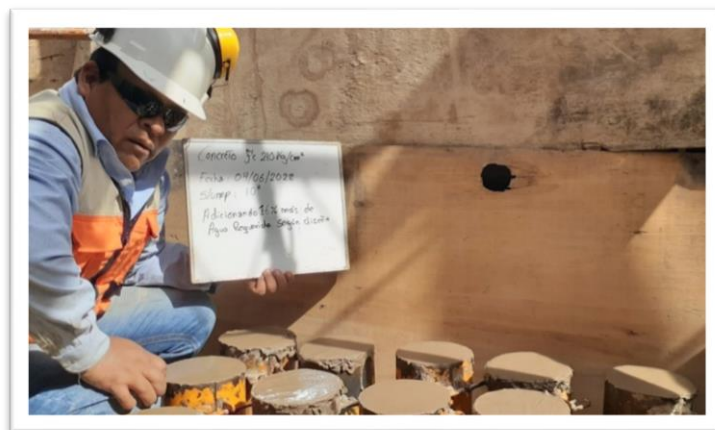
Fotografía 38: testigos con un 16 % más de agua requerida
