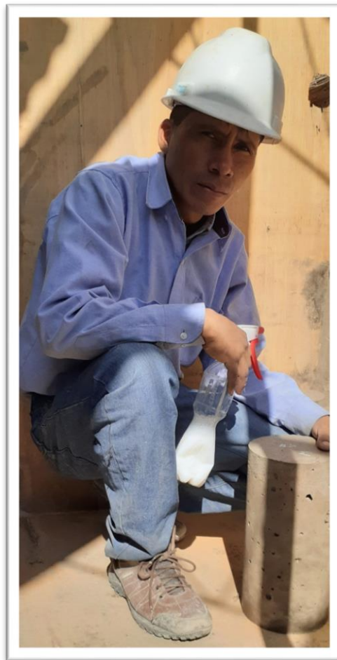
Fotografía 42: curando los testigos con membranal
