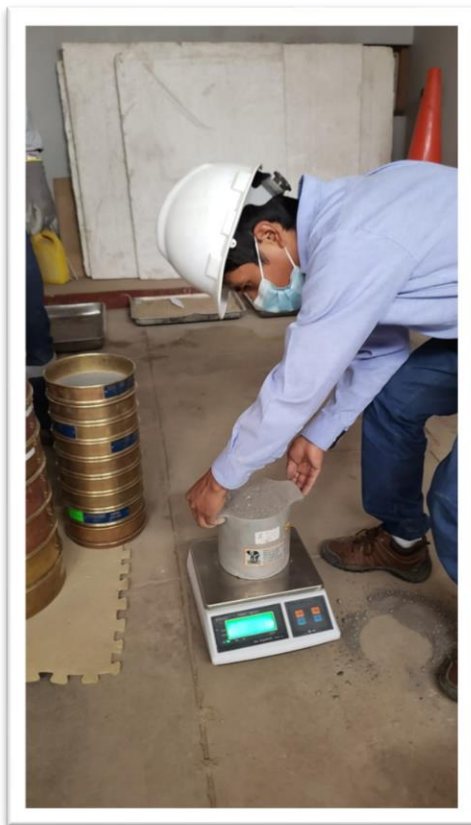
Fotografía 6: ensayo peso unitario del agregado fino
