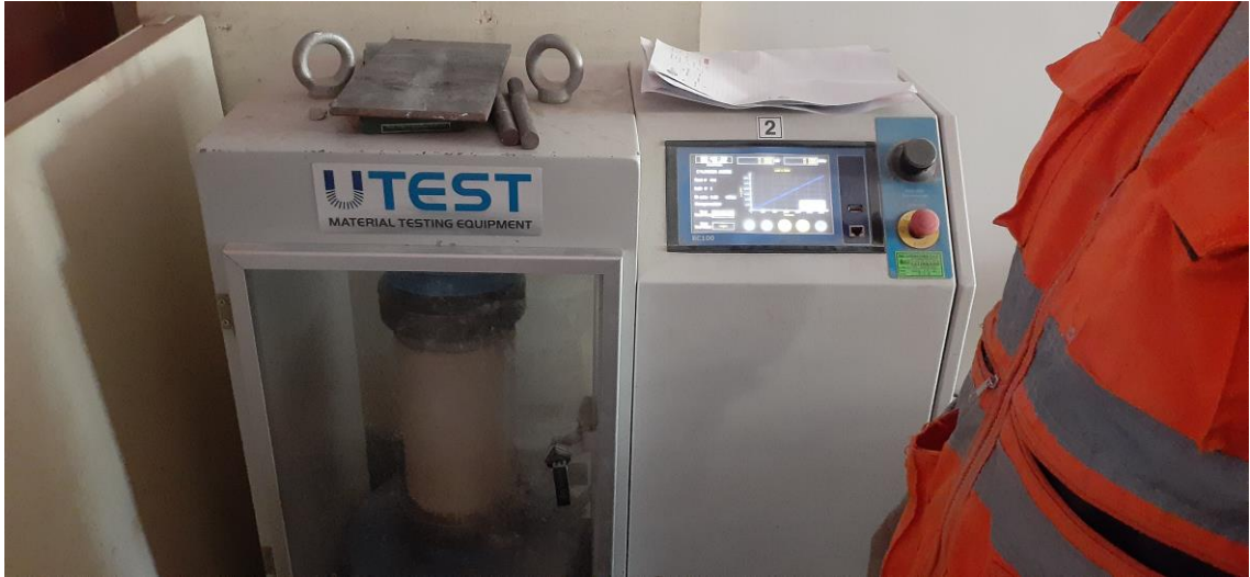
Fotografía 50: rotura de probeta
