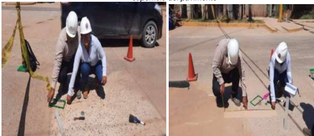
Figura 12. Esparcir la arena de forma homogénea tapando los agujeros de la superficie del pavimento
