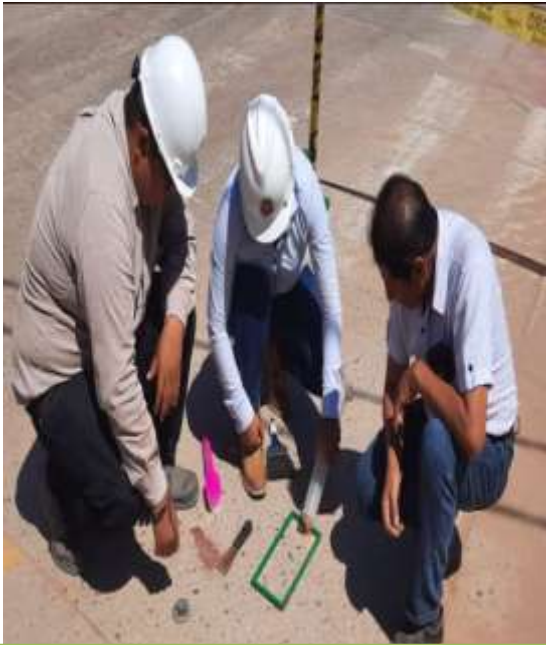
FOTOGRAFIA 09: Se puede observar, la colocación de nuestro marco portátil al pavimento a evaluar
