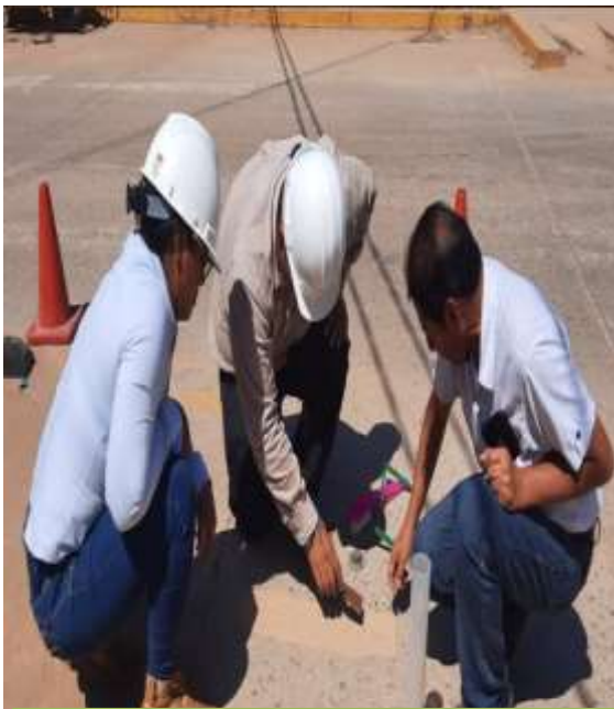
FOTOGRAFIA 11: Se puede la toma de datos para realizar el ensayo de mancha de arena
