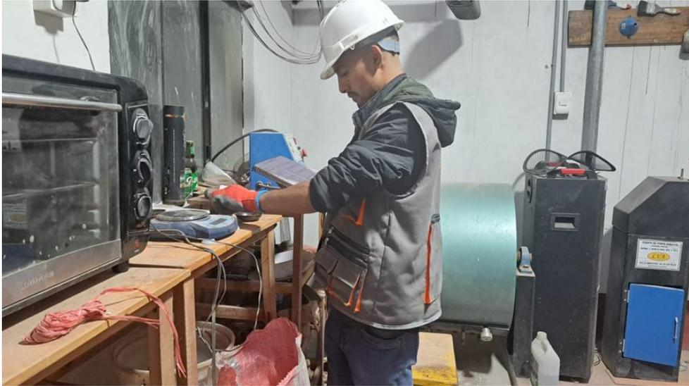
**Figura 03:** pesado de las muestras para determinar el porcentaje de humedad.
