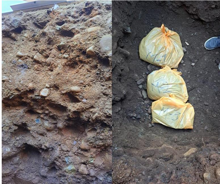
**Figura 07:** Calicata c-1 profundidad 3 metros como lo especifica la normativa muestra-1; muestra-2 y muestra-3.
