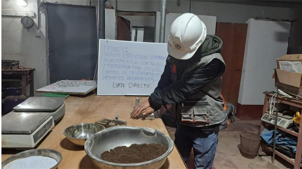
**Figura 03:** Ensayo de corte directo, se procede a colocar al muestreador una porción de suelo para luego presionar y compactar la muestra.
