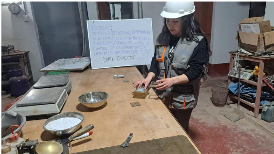
**Figura 03:** una vez compactado la muestra de suelo se procede a retirar los tornillos y caja de corte y llevarlo a la placa de transferencia de corte para su ensayo correspondiente.
