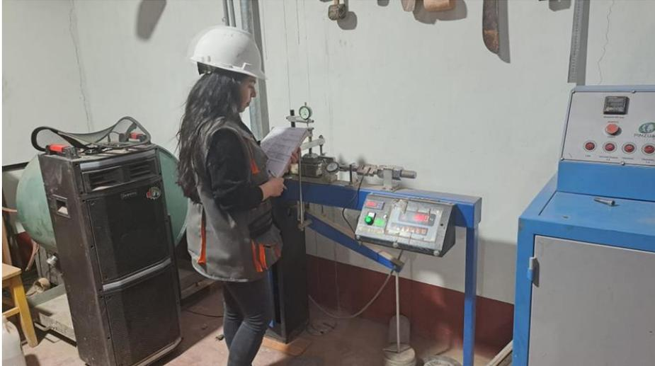
**Figura 03:** Se toma nota de los datos obtenidos en la placa de transferencia de corte, se toman las medidas del dinamómetro a los 5 y 10 segundos y cada 20 segundos posteriormente.
