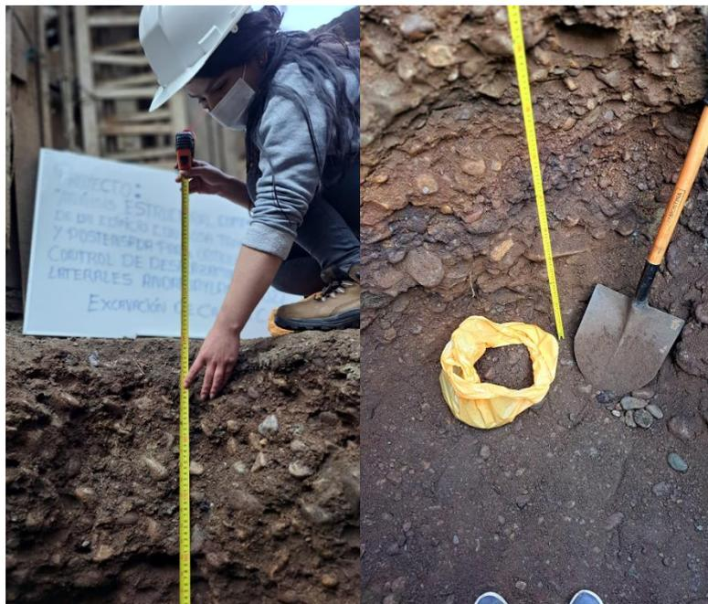
**Figura 03:** Altura de calicata C-1; 3 metros de profundidad.
