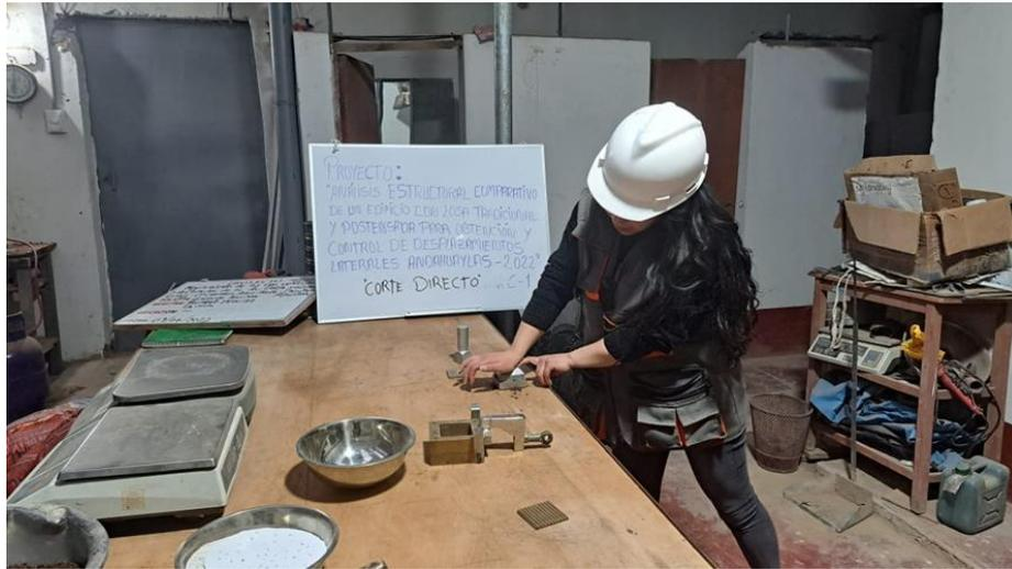
**Figura 03:** Se presiona la muestra de suelos en el muestreador para compactarla.
