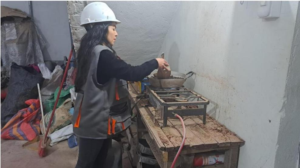
**Figura 03:** Secado de muestra de suelo para análisis granulométrico.
