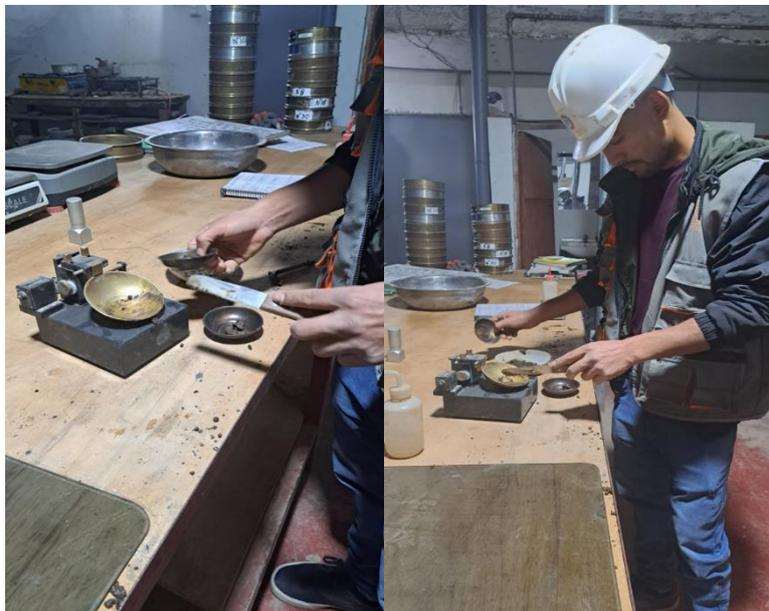
**Figura 03:** Se realizo el ensayo en las cuales la ranura de la muestra se cerro con 38 golpes, se toma una pequeña muestra para poder pesarla.
