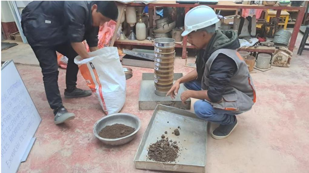
**Figura 03:** División de muestra de suelo para realizar el análisis granulométrico por medio del tamizado.
