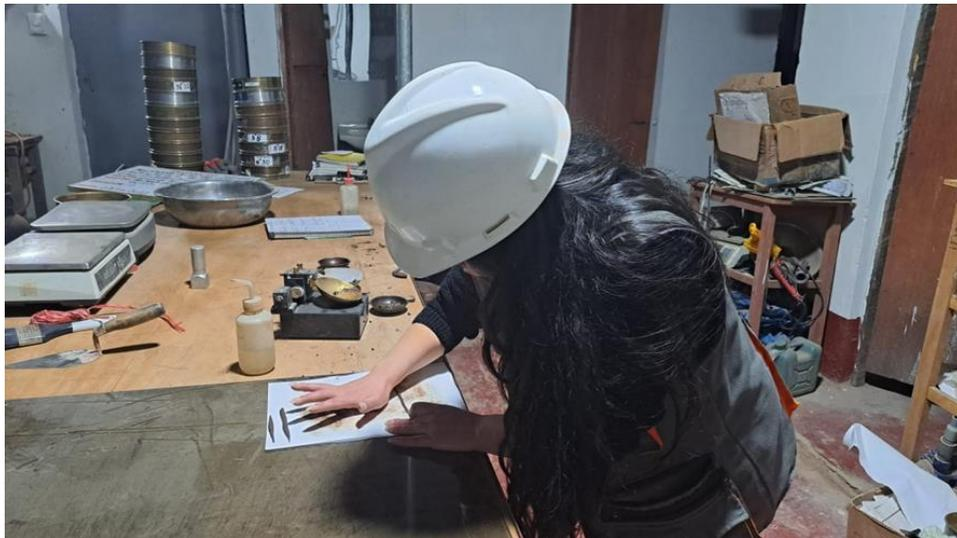
**Figura 03:** Ensayo de limite plástico enrollado de suelo.
