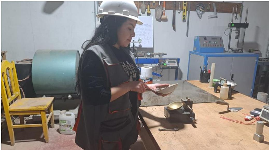
**Figura 03:** Ensayo de limite plástico.
