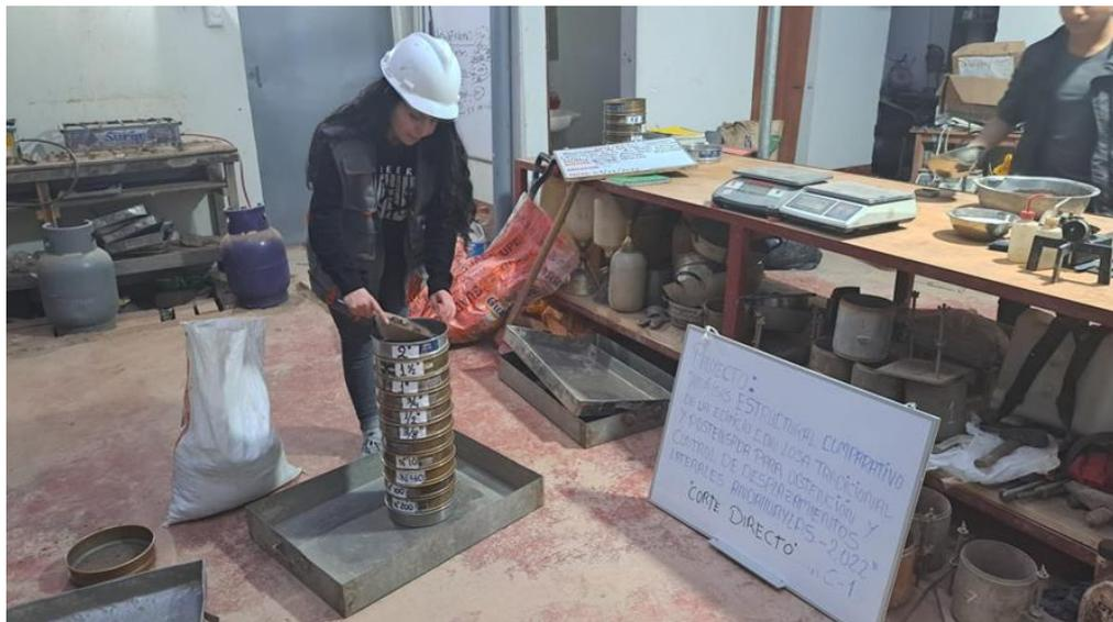
**Figura 03:** Tamizado de muestra de suelo seco para análisis granulométrico.
