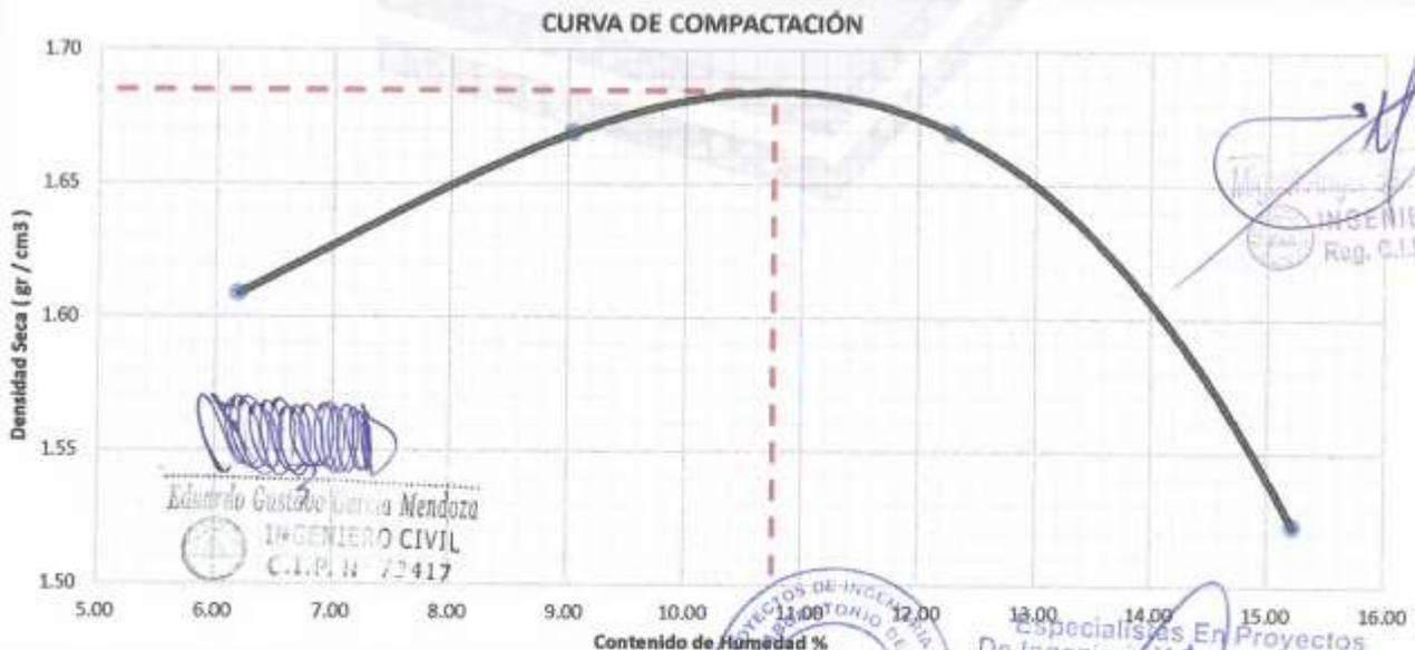
**ENSAYO DE COMPACTACIÓN PROCTOR MODIFICADO**
