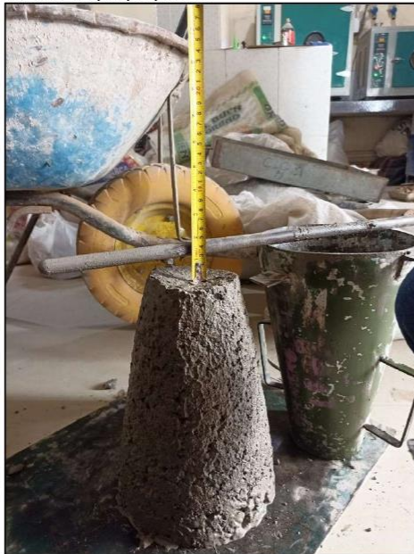
Fotografía N.º 08: Se realizó la medición de asentamiento del concreto del 5% de adición de polipropileno.
