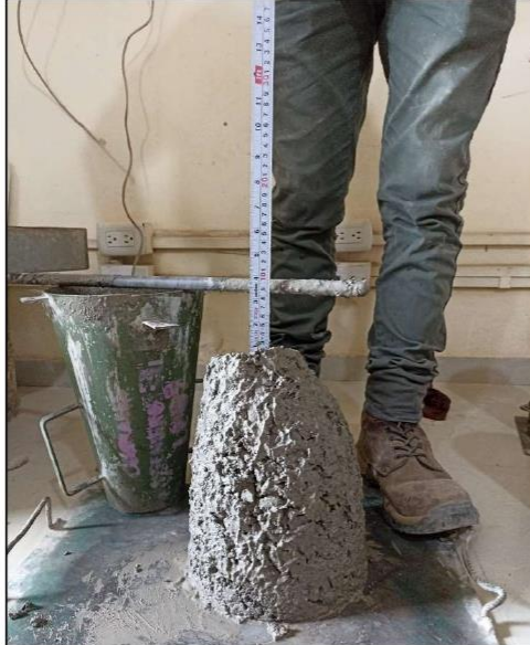
Fotografía N.º 08: Se realizó la medición de asentamiento del concreto del 5% de adición de polipropileno.
