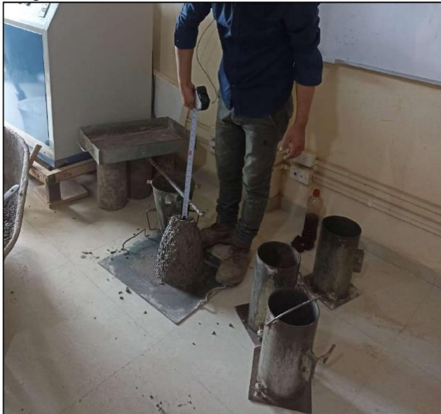
Fotografía N.º 06: Se realizó la medición de asentamiento del concreto.
