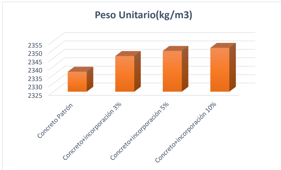
Figura 7: Peso unitario del concreto natural y concreto con incorporaciones de fibras de polipropileno
