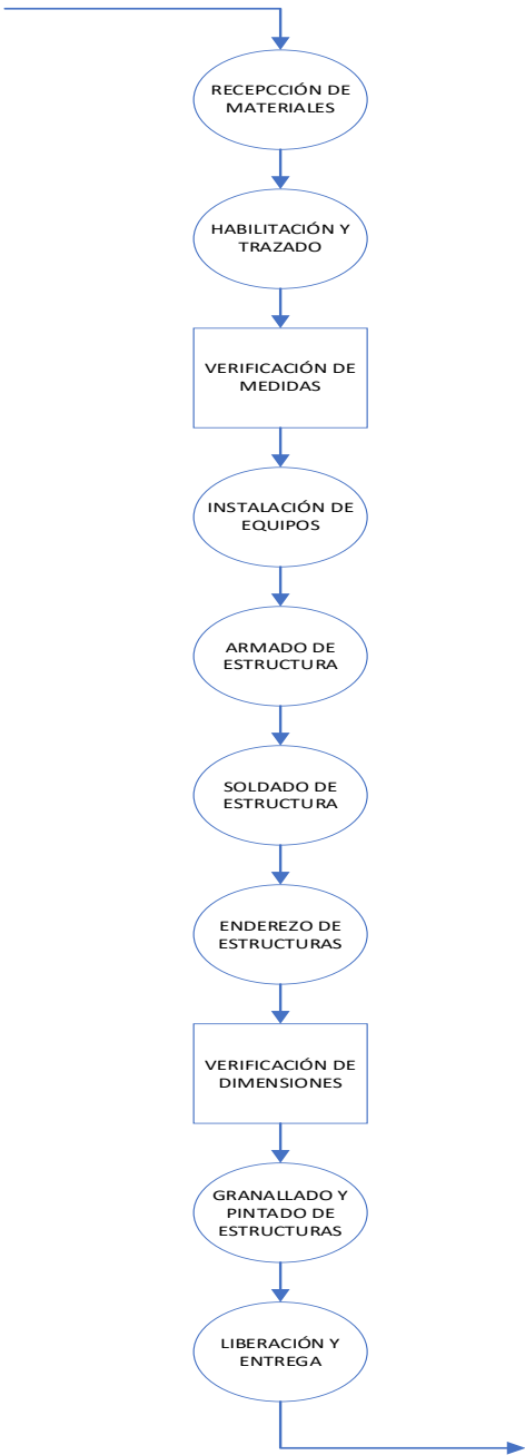
Figura 9: DOP fabricación de estructuras
