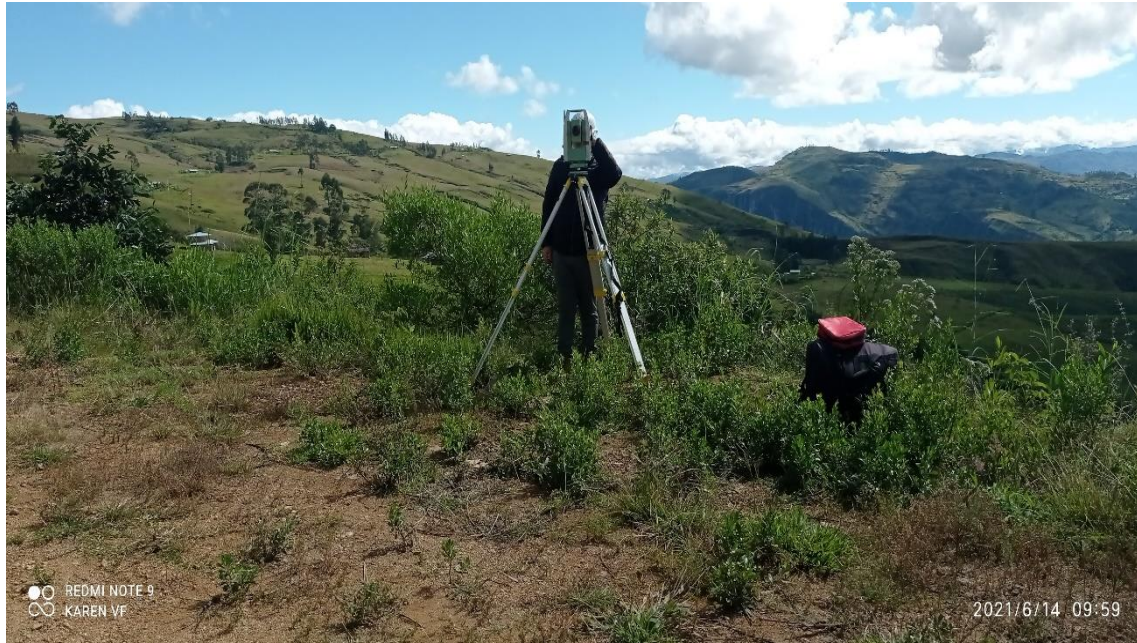
Foto 5: Levantamiento topográfico para seccionamiento transversal.
