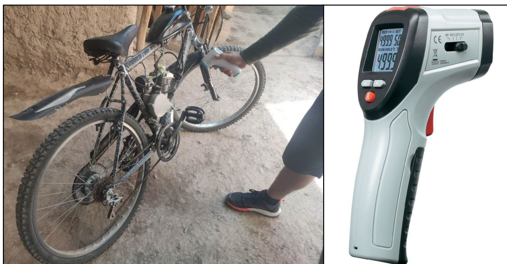
Figura 24. Implemento de control – Termómetro Digital Industrial VOLT CRAFT IRF 260-10S Fuente: Soselectronic (2022)
