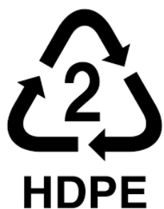
Figura 1: Simbología y clasificación del polietileno de alta densidad (HDPE o PEAD).
