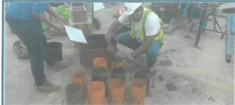
Foto N° 14 Diseño del concreto patrón F' C 210Kg/Cm 2 .
