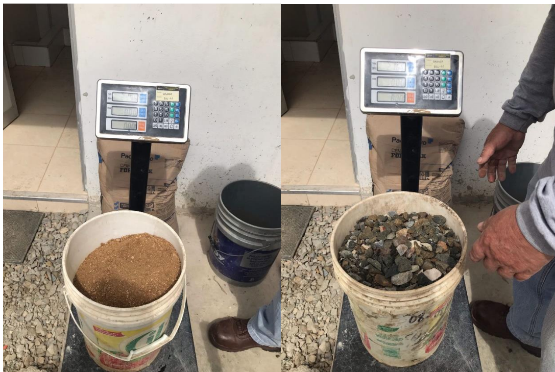
Pesaje de los agregados para la elaboración de concreto
