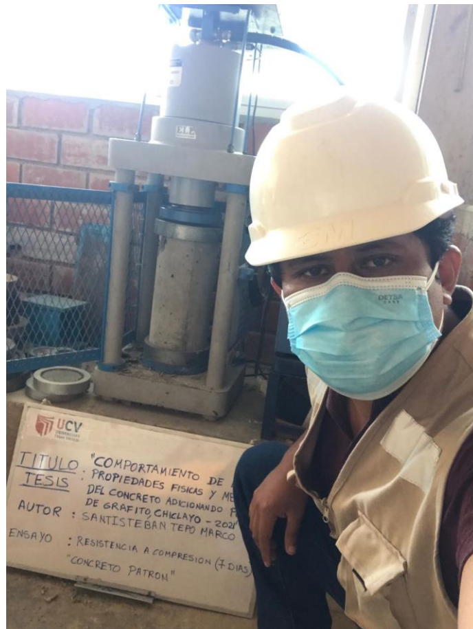
Ensayo de resistencia a compresión
