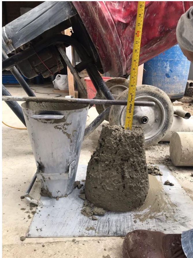
Medición del asentamiento del concreto
