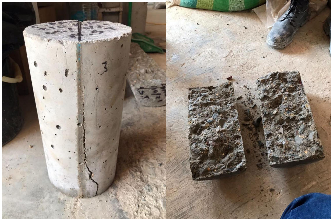
Rotura a tracción por compresión diametral
