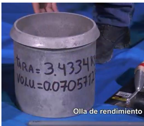
Figura 14: Olla de rendimiento Fuente: (Unión de Concreteras S.A)
