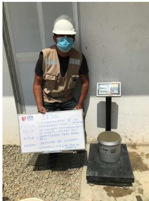
Figura 37. Determinación de la densidad del concreto
