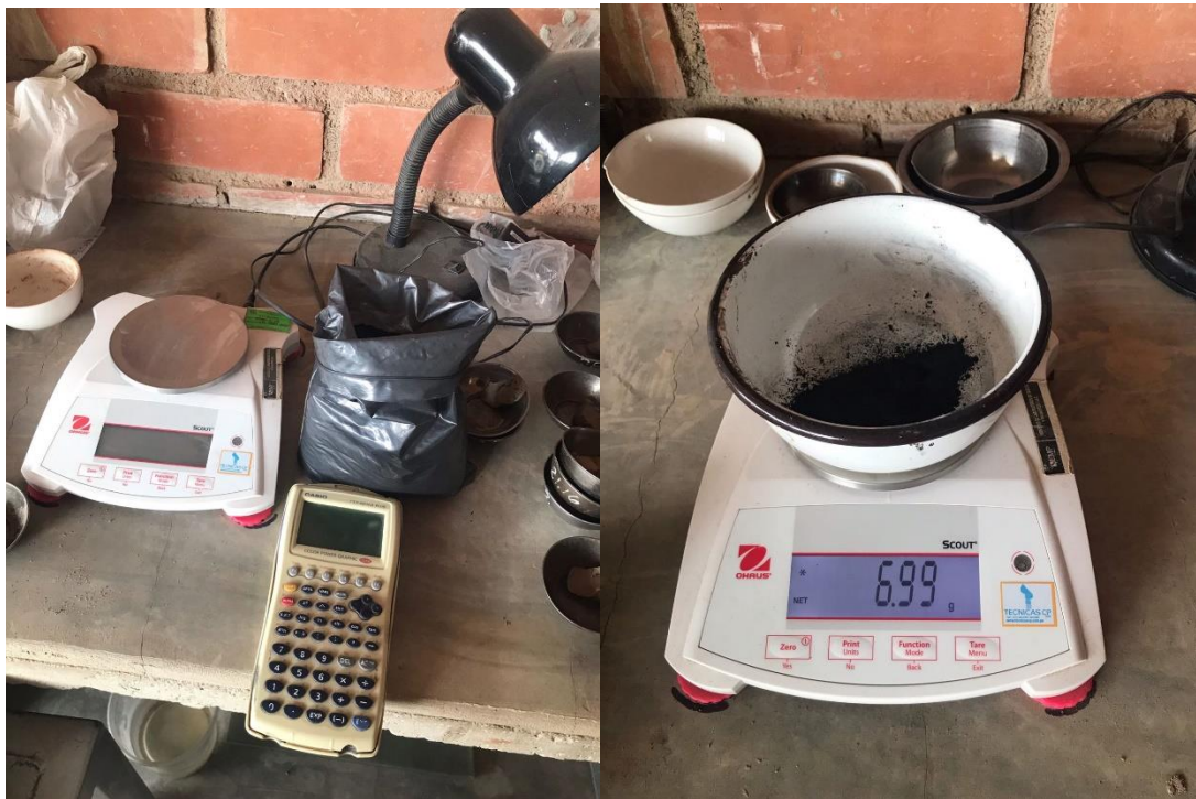
Pesaje del polvo de grafito según las dosificaciones
