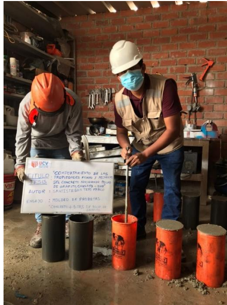
Figura 29. Moldeo de probetas 6" x 12"
