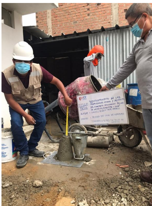
Figura 34. Determinación del revenimiento Fuente: Elaboración propia
