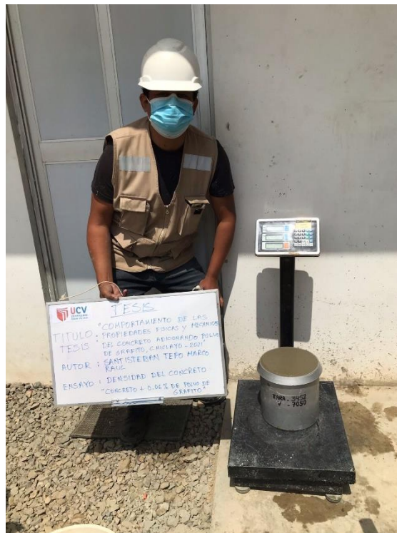
Determinación de la densidad del concreto fresco
