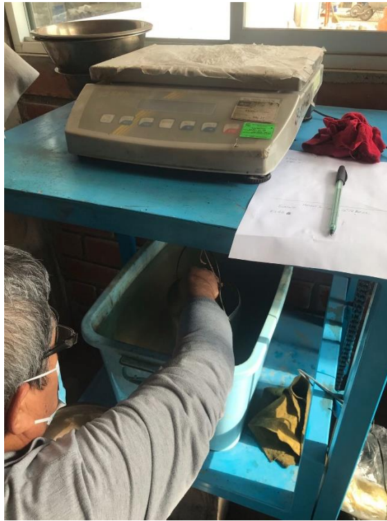
Peso del agregado grueso en canastilla para determinar el peso específico
