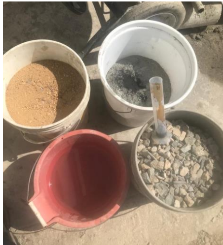
Figura 26. Preparación de los materiales para el concreto Fuente: Elaboración propia
