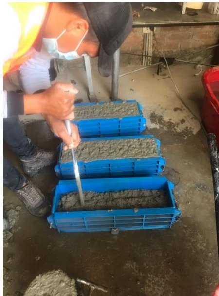
Figura 30. Moldeo de probetas prismáticas de 15cm x 15cm x 50 cm
