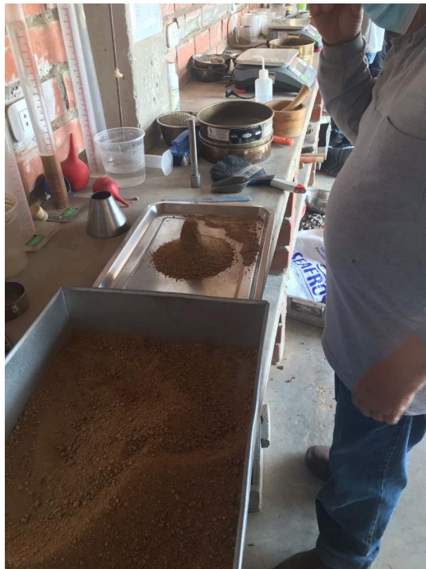
Ensayo del cono de abrams para el agregado grueso (determinación del estado de saturado superficialmente seco)
