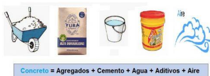
Figura 4: Componentes para elaborar concreto Fuente: (civilmas.net)
