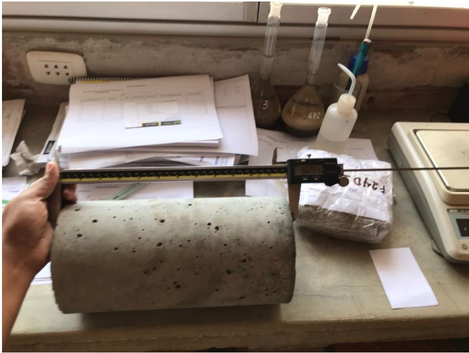
Medición de probeta con la ayuda del instrumento pie de rey
