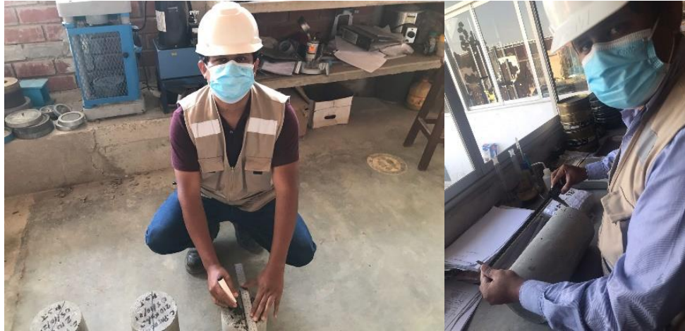
Figura 40. Medición de testigos Fuente: Elaboracion propia
