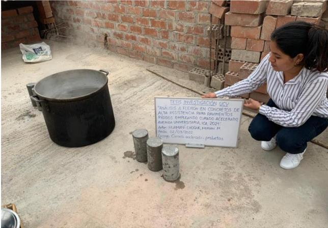
Figura 15. Reposo de probetas cilíndricas luego de curado acelerado
