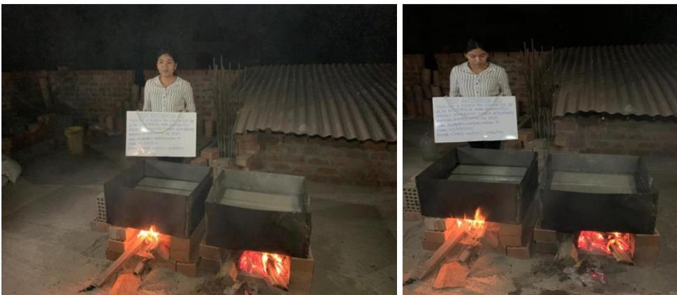
Figura 16. Curado acelerado de probetas de vigas mediante método de agua hirviendo
