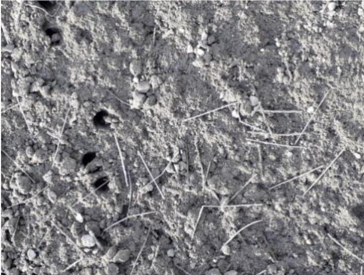
*Figura 4. Concreto con aditivo microfibra*
