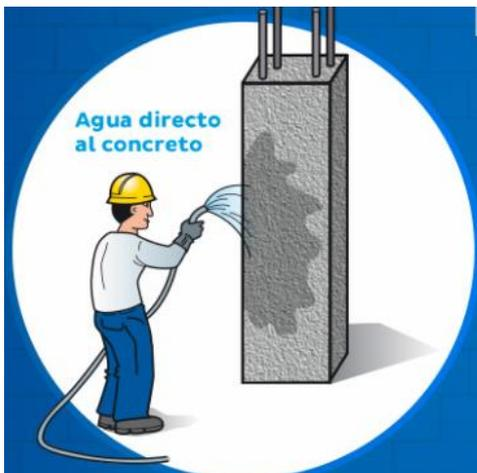
*Figura 7. Continua y directa aplicación de agua para curado de concreto*
