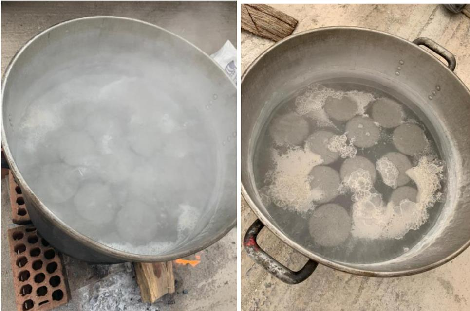
*Figura 14. Curado acelerado de probetas cilíndricas mediante método de agua hirviendo*
