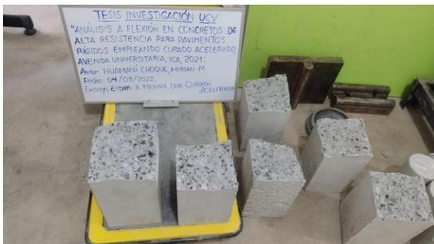
Figura 21. Ensayo de resistencia a la flexión
