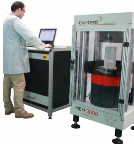
*Figura 5. Ensayo de resistencia a la compresión del concreto*
