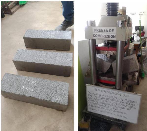
Figura 20. Ensayo de la resistencia a la flexión
