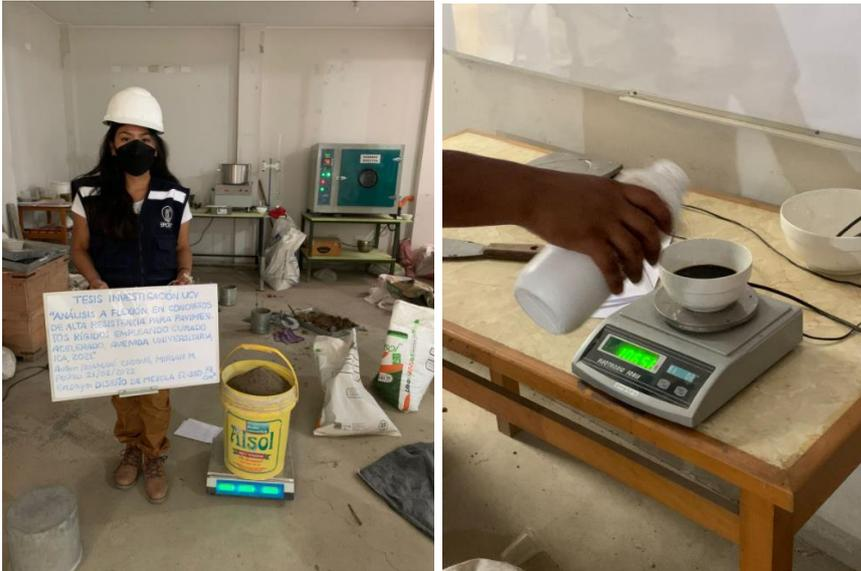
Figura 11. Pesado de materiales para elaboración de mezcla
