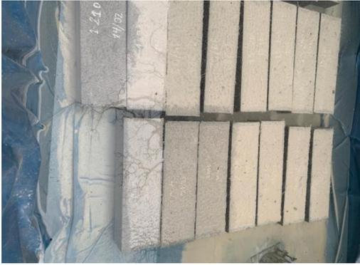
Figura 17. Curado tradicional de vigas de concreto
