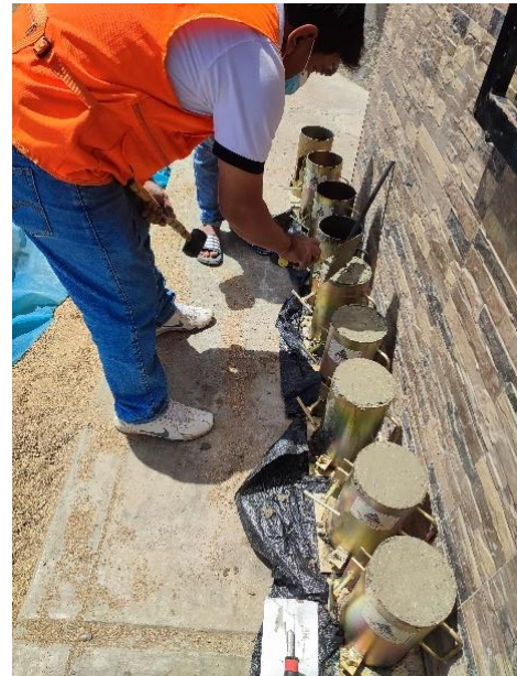
Encofrado de probetas
