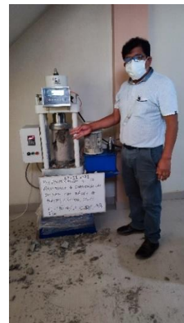
Ensayo de resistencia a la compresión
