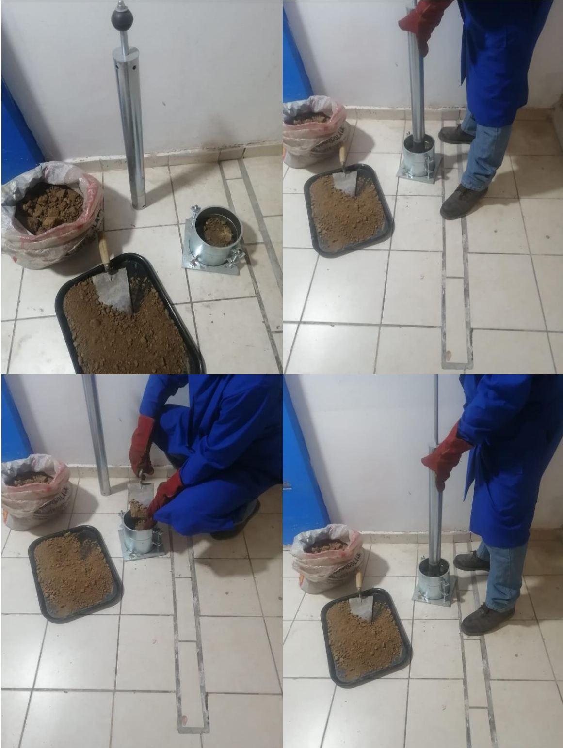
Imágenes de procedimiento del ensayo proctor
