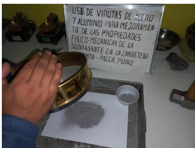
**Tamizado de las virutas de aluminio mediante el tamiz #40**
