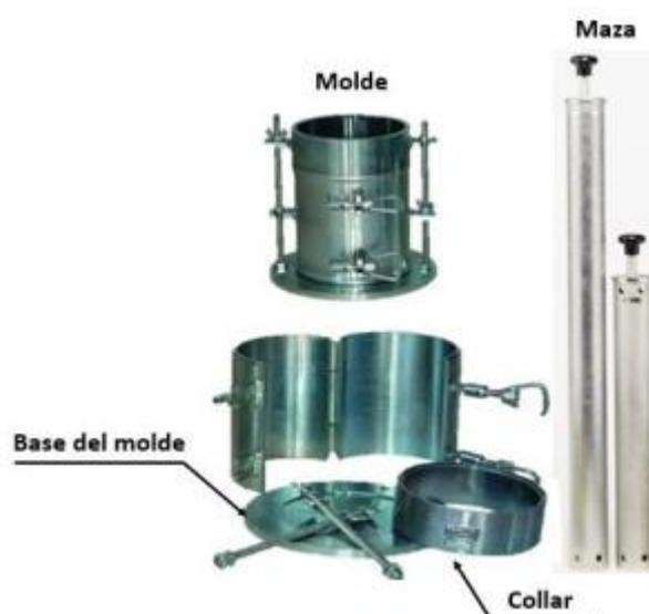
*Figura 5.* Equipamiento necesario para el ensayo de Proctor
