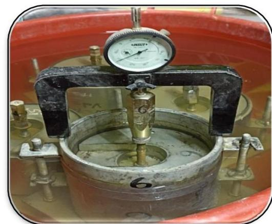
Saturacion de la muestra con el dial de deformaciones
