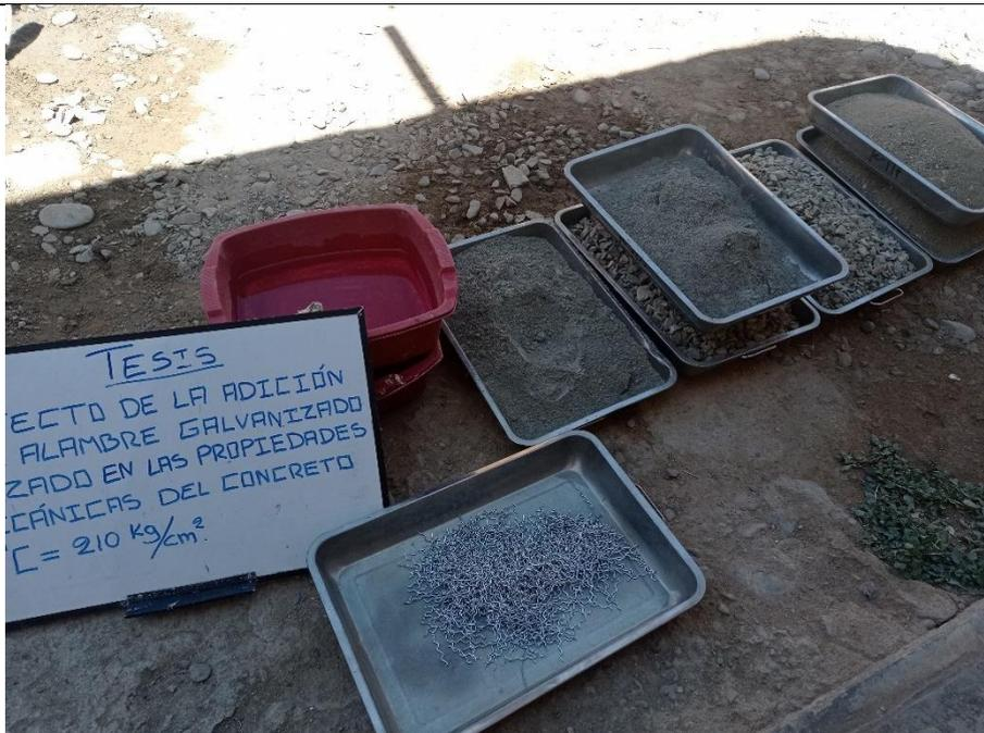
**FOTOGRAFIA N.º 16:** Vista parcial obsérvese todos los materiales para la fabricación del concreto con adición de alambres galvanizados rizados, para ser vertidos a la mezcladora.
