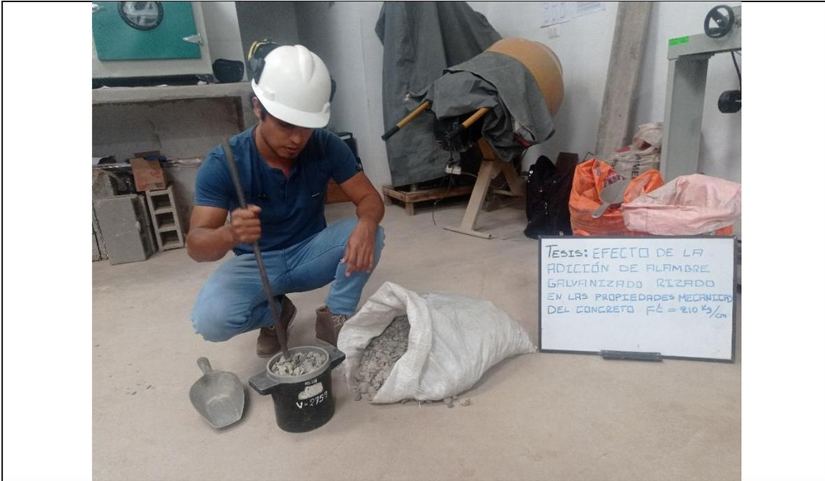
**FOTOGRAFIA N.º 7:** Vista parcial obsérvese la elaboración del ensayo de peso unitario del agregado grueso.
