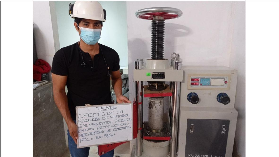
FOTOGRAFIA N.º 25: Vista parcial obsérvese la elaboración del ensayo de resistencia a compresión.
