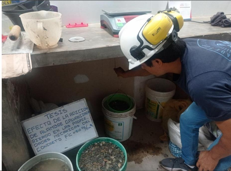
FOTOGRAFIA N.º 11: Vista parcial obsérvese la elaboración del ensayo de la gravedad específica y absorción agregado grueso.
