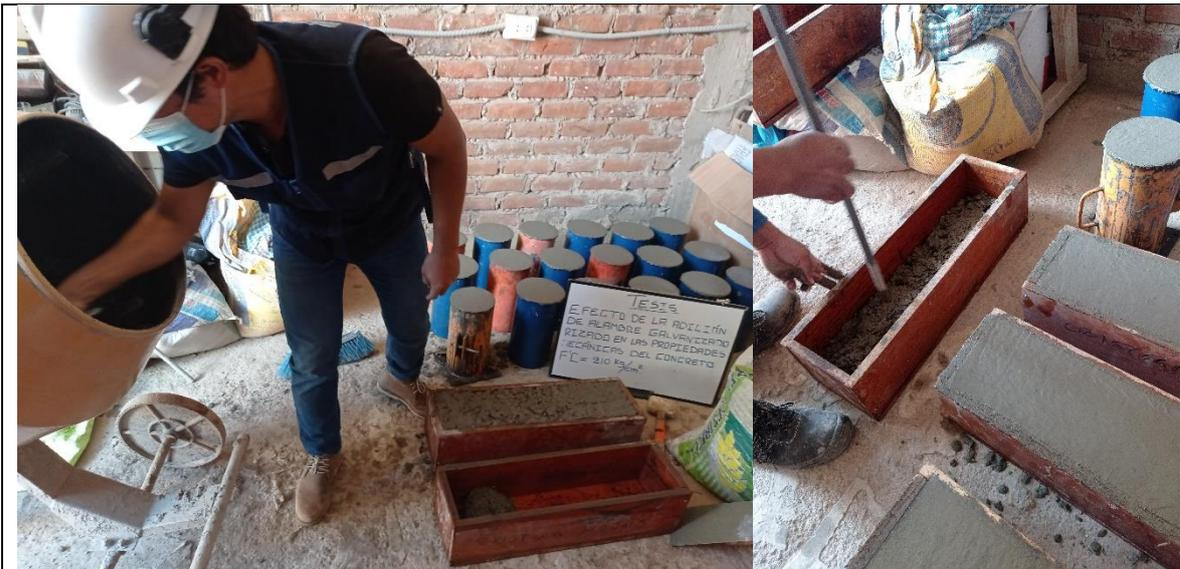
FOTOGRAFIA N.º 21: Vista parcial obsérvese elaboración de las muestras prismáticas.
