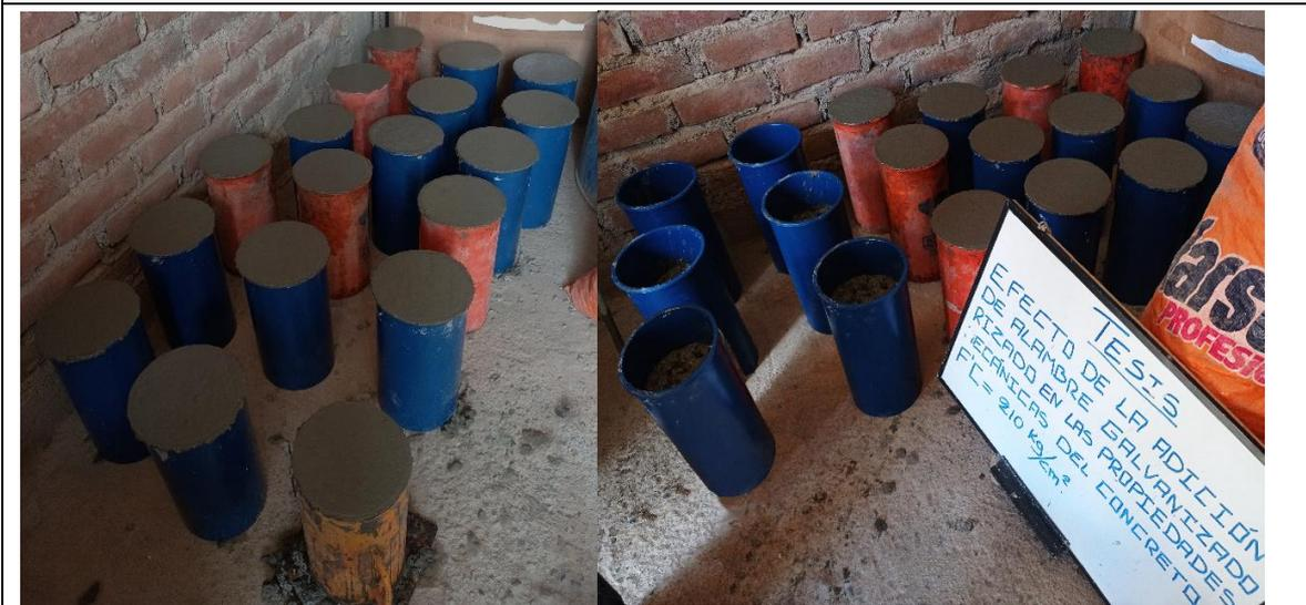
FOTOGRAFIA N.º 20: Vista parcial obsérvese la elaboración de las muestras cilíndricas segundo y tercer grupo
