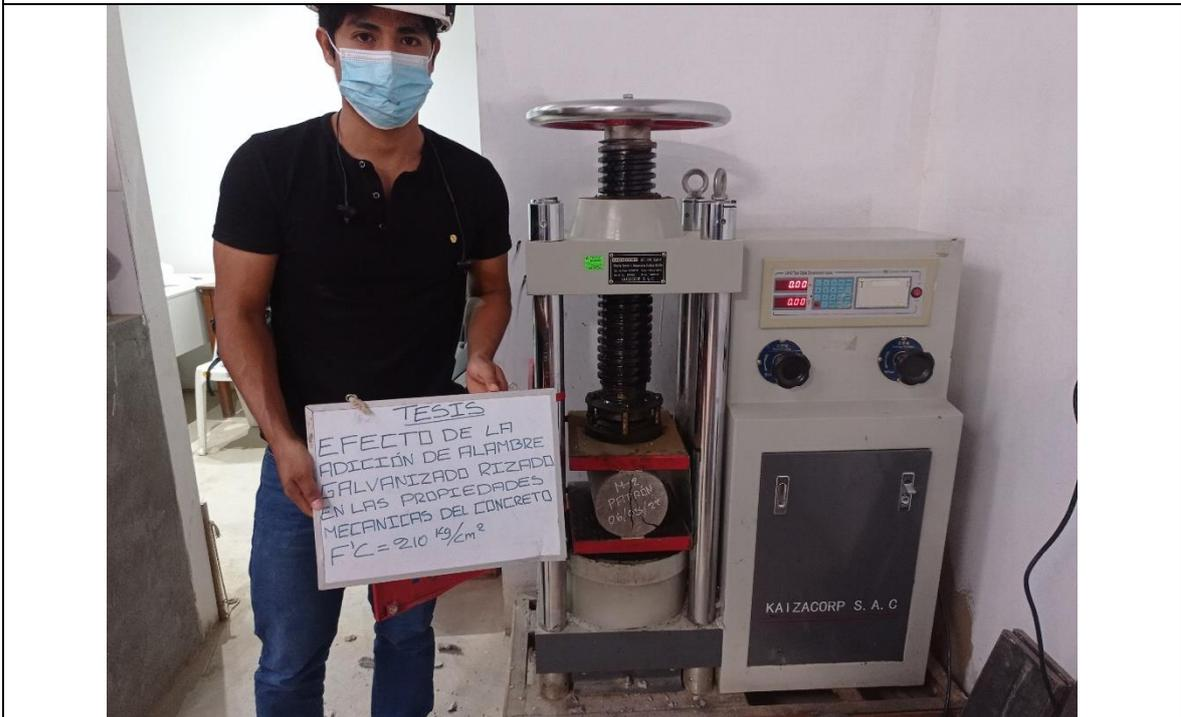
FOTOGRAFIA N.º 26: Vista parcial obsérvese la elaboración del ensayo de resistencia a tracción.
