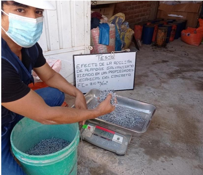
**FOTOGRAFIA N.º 15:** Vista parcial obsérvese el peso de los alambres galvanizados rizados según indica el diseño de mezcla.
