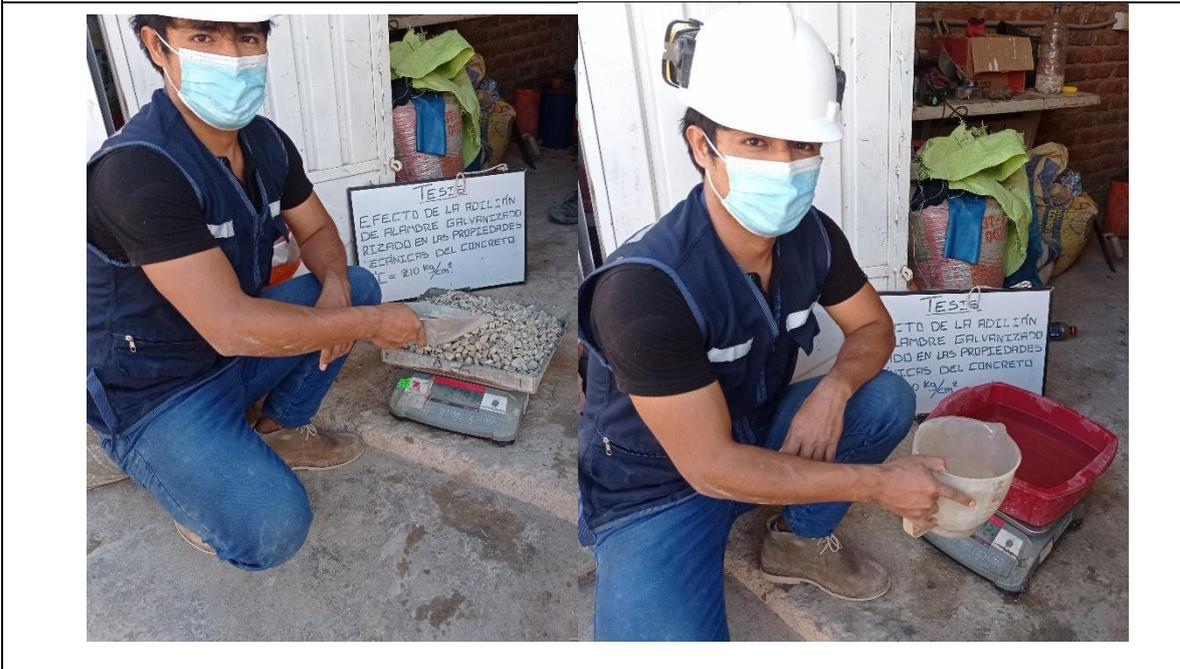
**FOTOGRAFIA N.º 14:** Vista parcial obsérvese el peso de los materiales según los resultados del diseño de mezcla.
