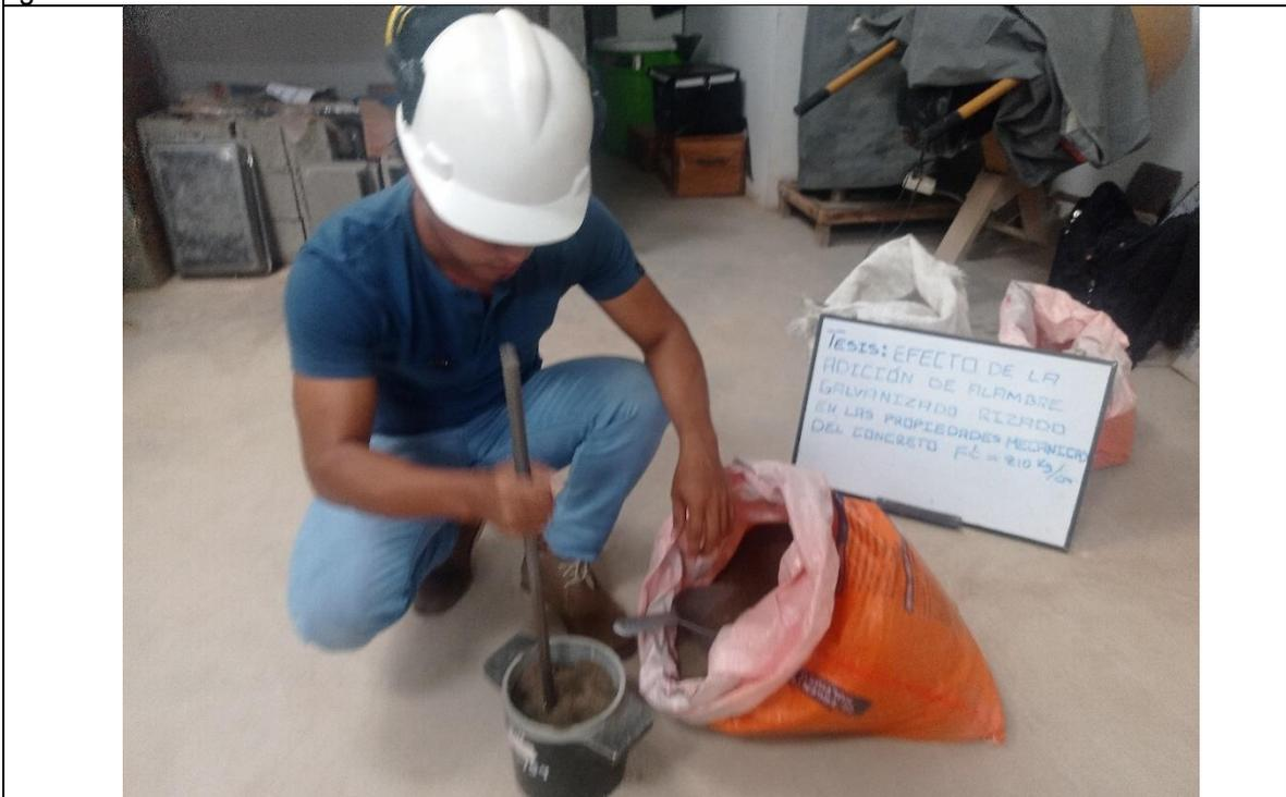
FOTOGRAFIA N.º 6: Vista parcial obsérvese la elaboración del ensayo del peso unitario del agregado fino.
