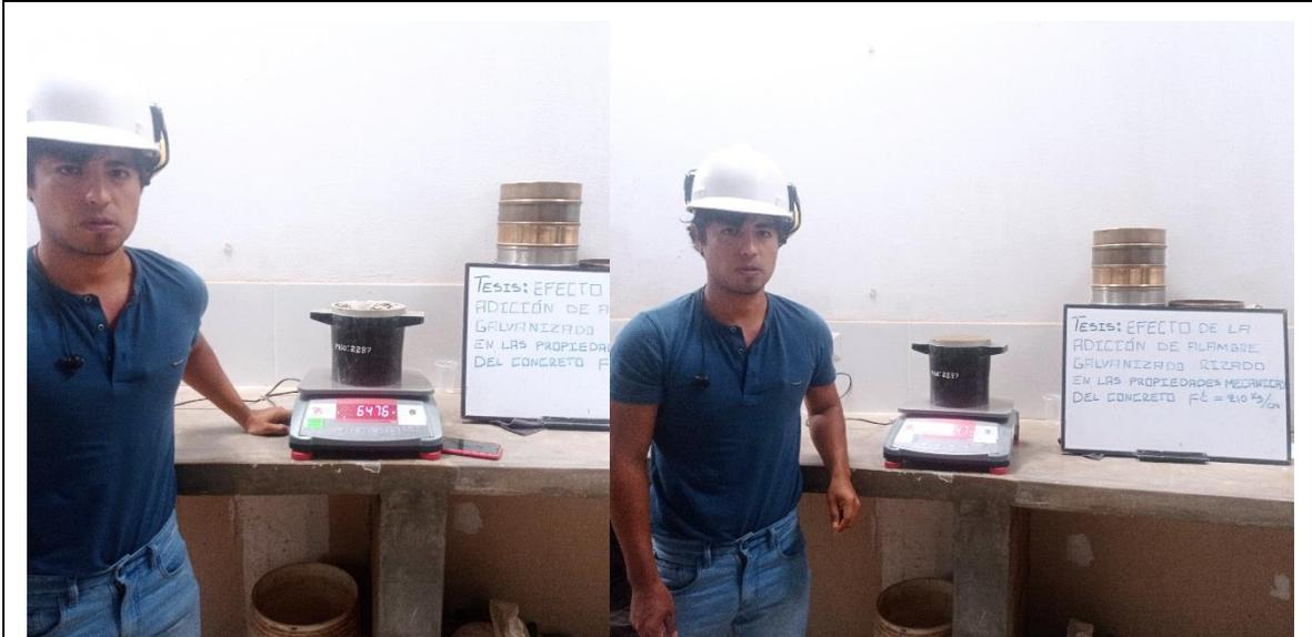
**FOTOGRAFIA N.º 8:** Vista parcial obsérvese el peso de las muestras fino y grueso para el ensayo de peso unitario.
