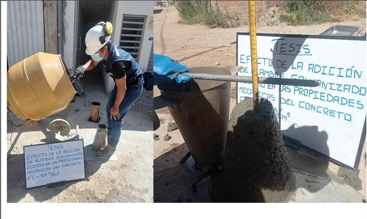
FOTOGRAFIA N.º 18: Vista parcial obsérvese la elaboración del ensayo de consistencia del concreto, mediante el cono de Abrams.
