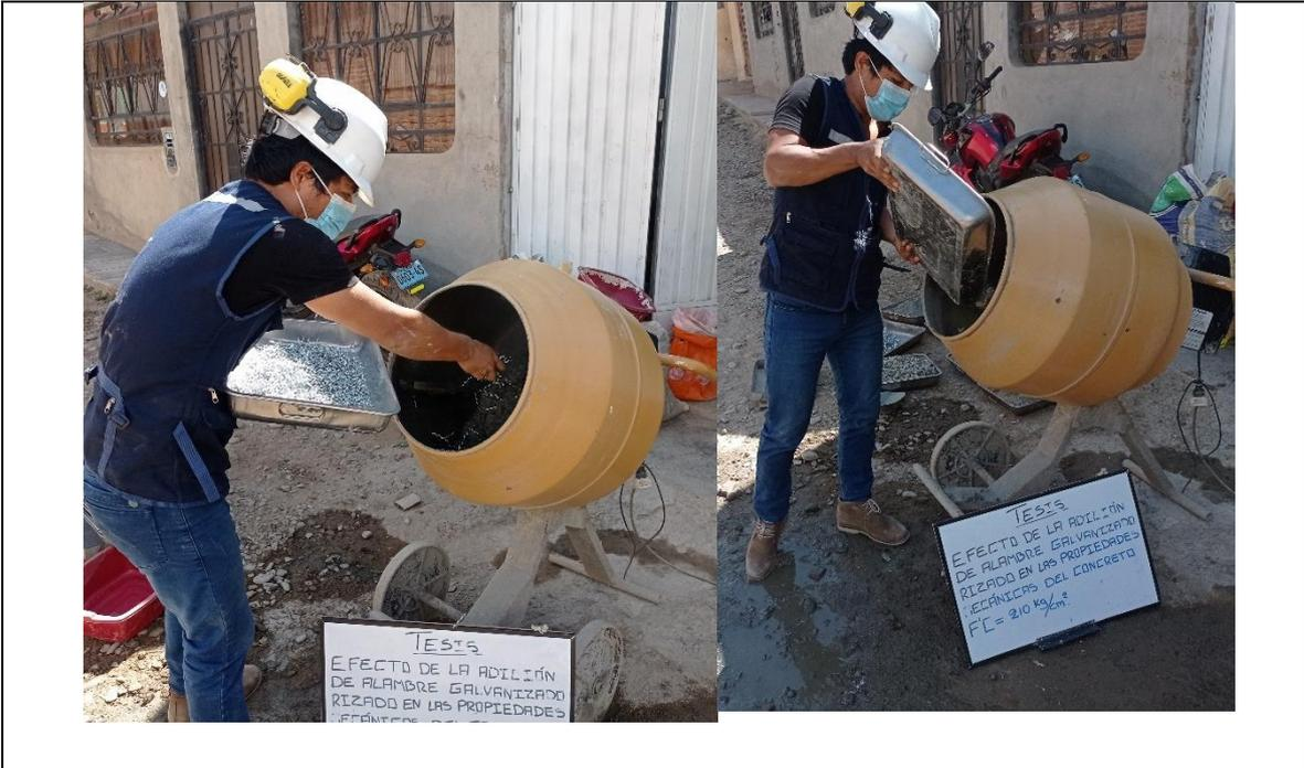
FOTOGRAFIA N.º 17: Vista parcial obsérvese el vaciado de los materiales al mezclador.
