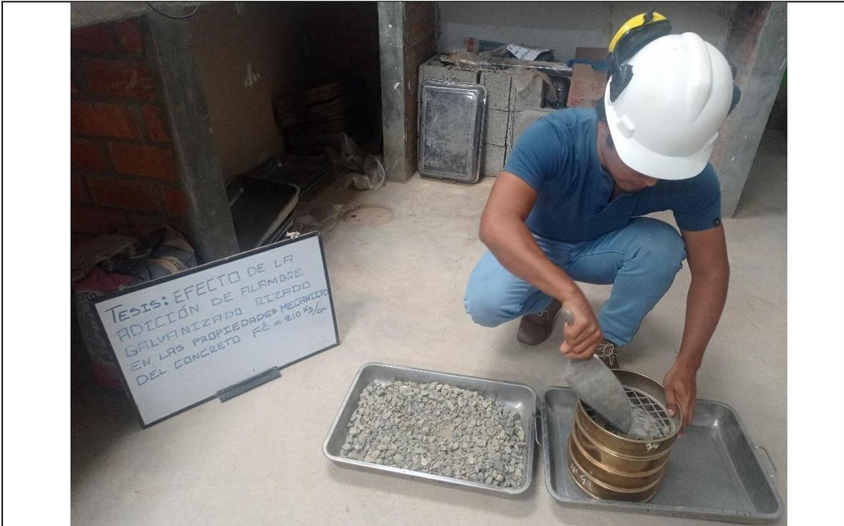
FOTOGRAFIA N.º 5: vista parcial obsérvese la elaboración del ensayo granulométrico del agregado grueso.
