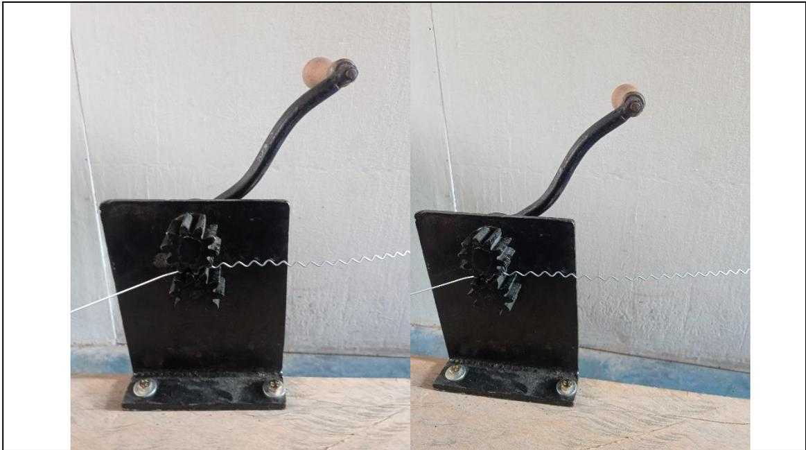
**FOTOGRAFIA N.º 1:** Vista parcial obsérvese al dispositivo que se utilizó para el rizado de los alambres galvanizados calibre 16.
