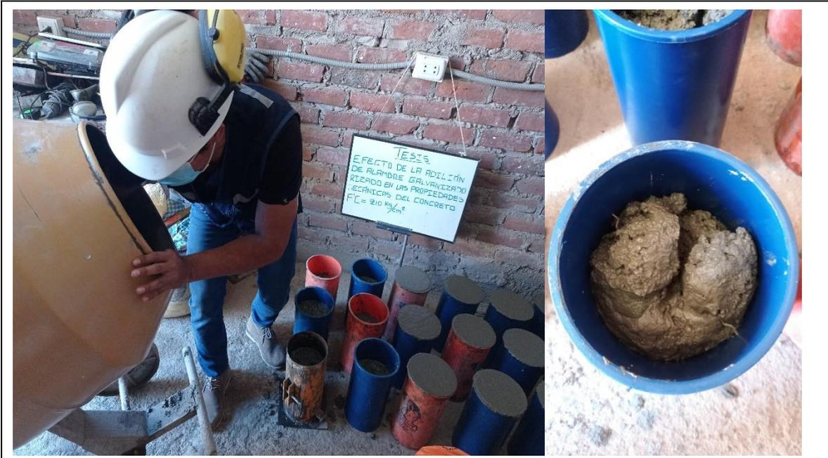
FOTOGRAFIA N.º 19: Vista parcial obsérvese la elaboración de las muestras cilíndricas primer grupo.
