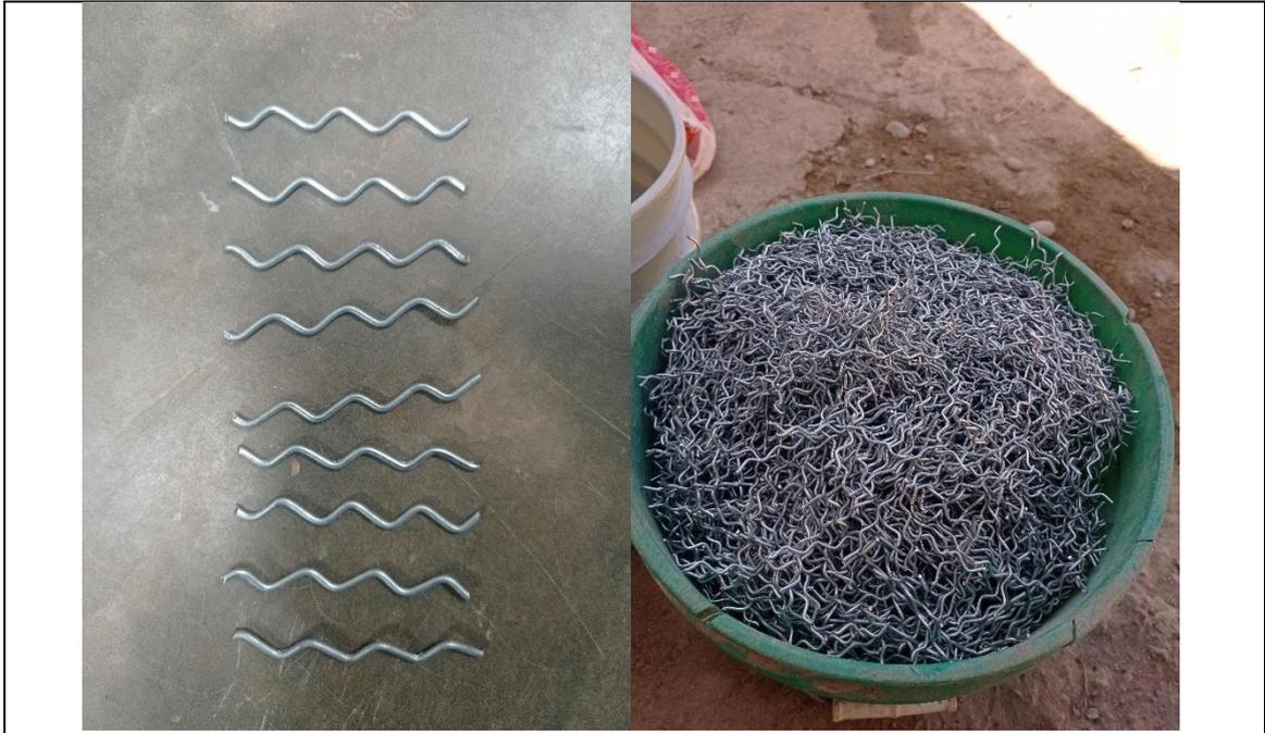
**FOTOGRAFIA N.º 3:** Vista parcial obsérvese al resultado final de las fibras de alambre galvanizado rizado.
