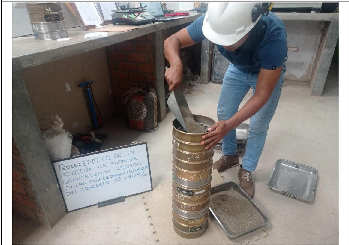
**FOTOGRAFIA N.º 4:** vista parcial obsérvese la elaboración del ensayo granulométrico del agregado fino.
