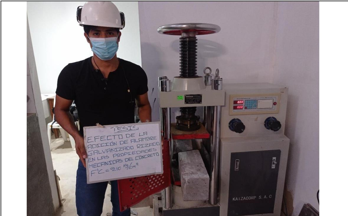
FOTOGRAFIA N.º 27: Vista parcial obsérvese elaboración del ensayo de resistencia a flexión.
