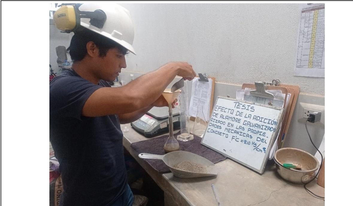
**FOTOGRAFIA N.º 9:** Vista parcial obsérvese la elaboración del ensayo de la gravedad específica y absorción agregado fino.
