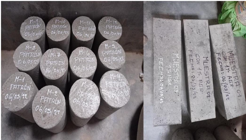
**FOTOGRAFIA N.º 23:** Vista parcial obsérvese la elaboración del desmolde y etiquetado de las muestras.
