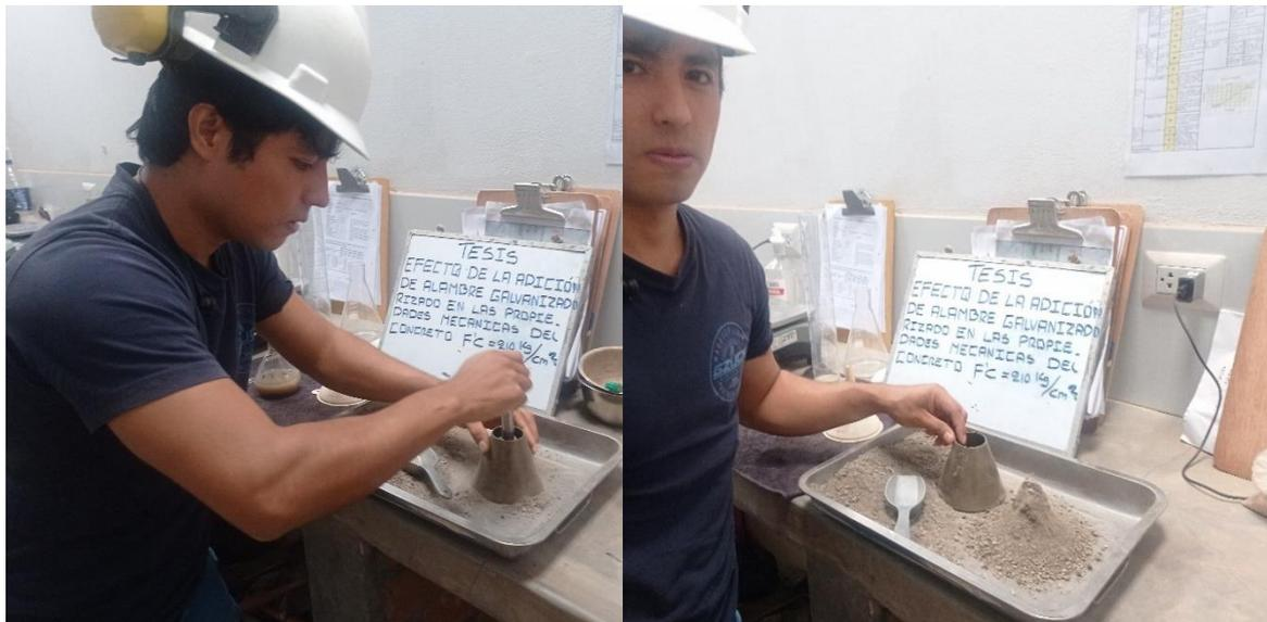
**FOTOGRAFIA N.º 10:** Vista parcial obsérvese el uso del cónico y compactador metálico para el ensayo de porcentaje de absorción.
