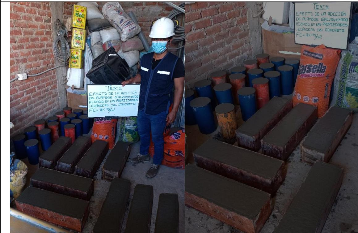
FOTOGRAFIA N.º 22: Vista parcial obsérvese elaboración de las muestras prismáticas.
