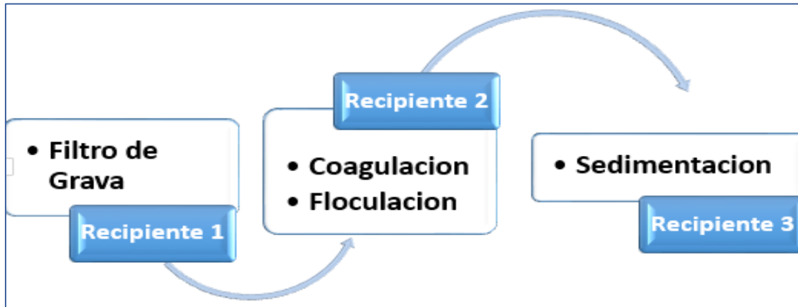
Gráfico N°1: Esquema del proceso químico del biofiltro
