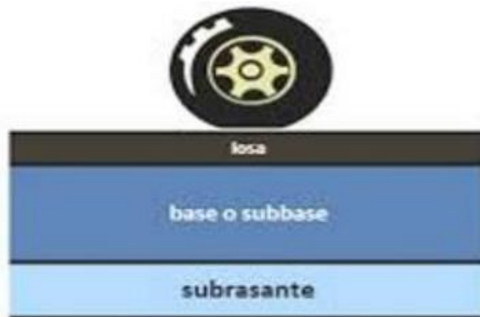
Gráfico 2. Elementos que conforman un pavimento rígido
