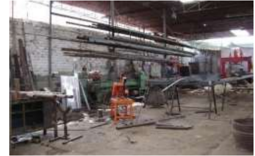
Figura 04: Ambiente inadecuado para realizar labores, pedazos de materiales de fierro tirados en el piso obstaculizando el libre tránsito del personal.
