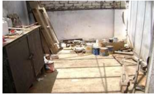
Figura 03: Productos inflamables: latas de pintura y galones de thinner expuestas a los rayos de sol y sin lugar adecuado para su almacenamiento.
