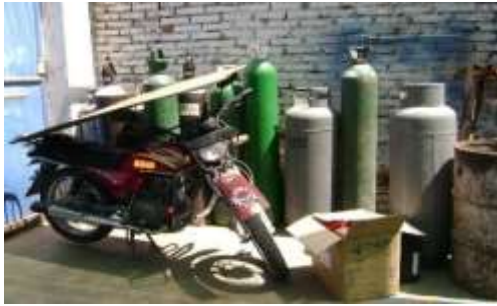
Figura 02: Balones de gas, oxígeno y argón expuestos a los rayos solares sin ningún tipo de protección o guardas de seguridad.
