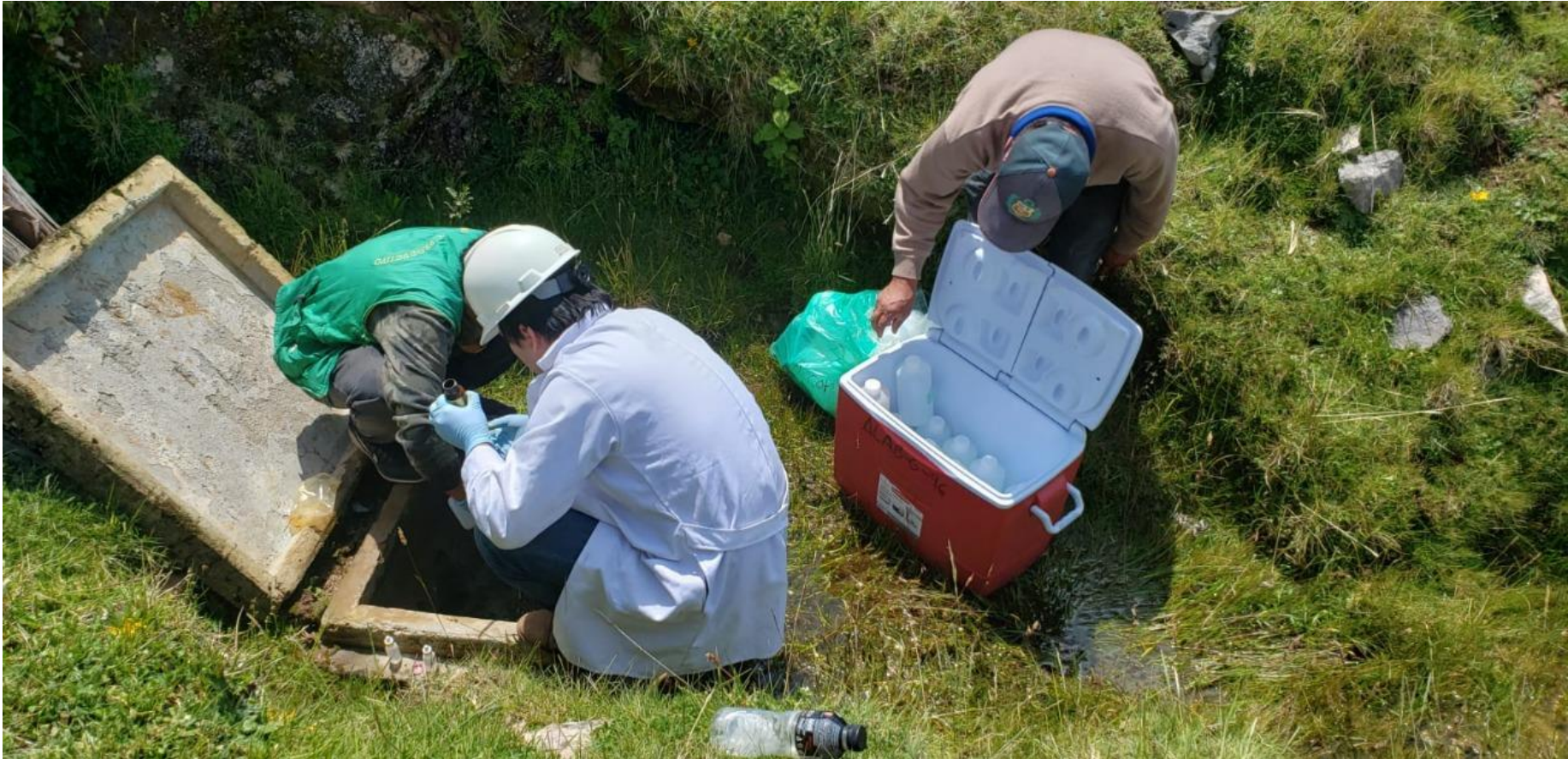
Toma de muestra Físico – Químico - Bacteriológico en la Captación Hatum (punto 2)
