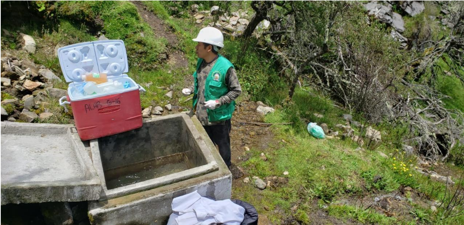
Toma de muestra Físico – Químico - Bacteriológico en la Captación Rumi (punto 1)
