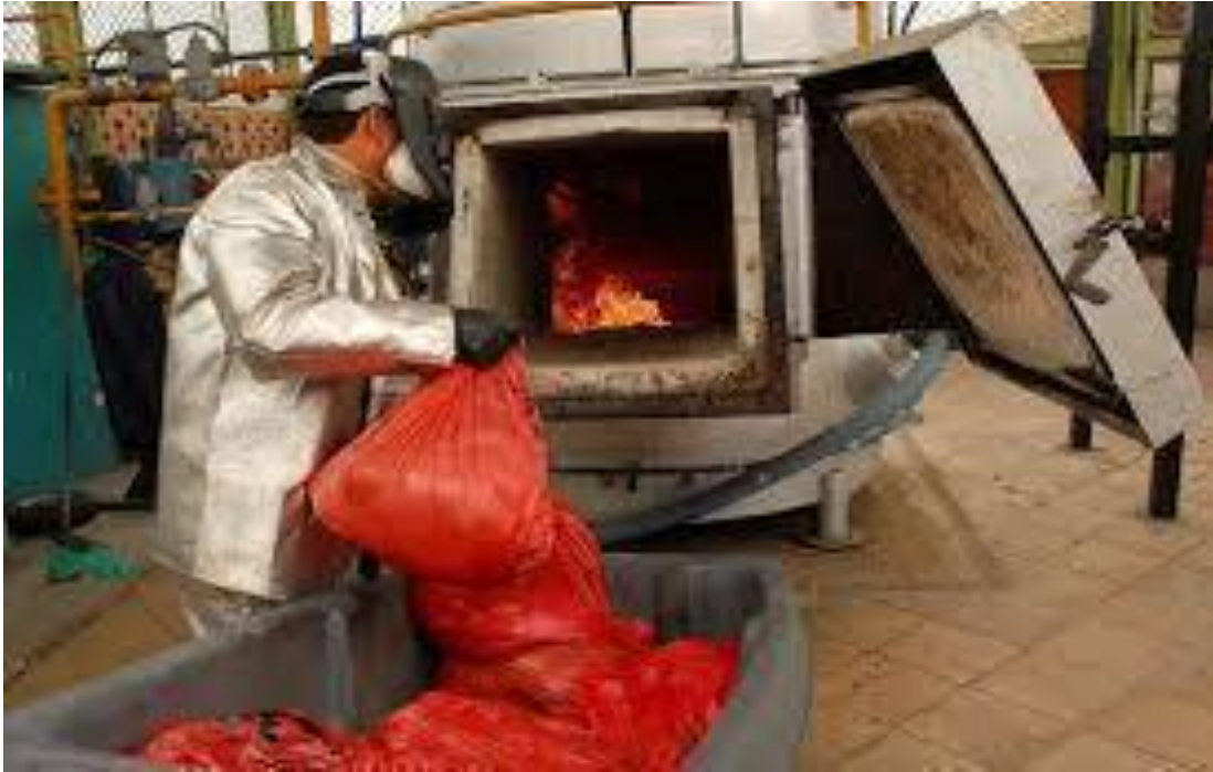
Figura 4: Incineración de residuos sólidos peligrosos a altas temperaturas.
