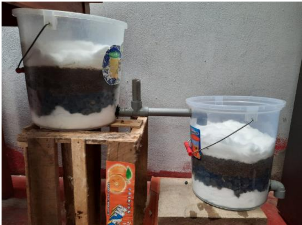
Imagen 10: verificación de biofiltro, asegurándose que no presente ninguna filtración en las uniones
