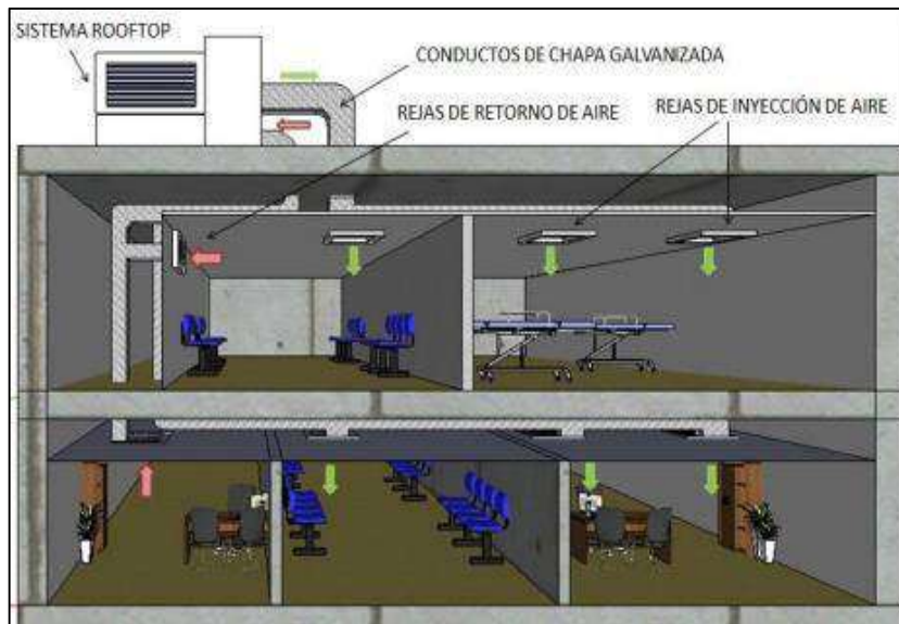
Figura 6. Esquema de un sistema “todo-aire” utilizando un equipo Rooftop. Fuente: (Luciani, 2016, p. 19)
