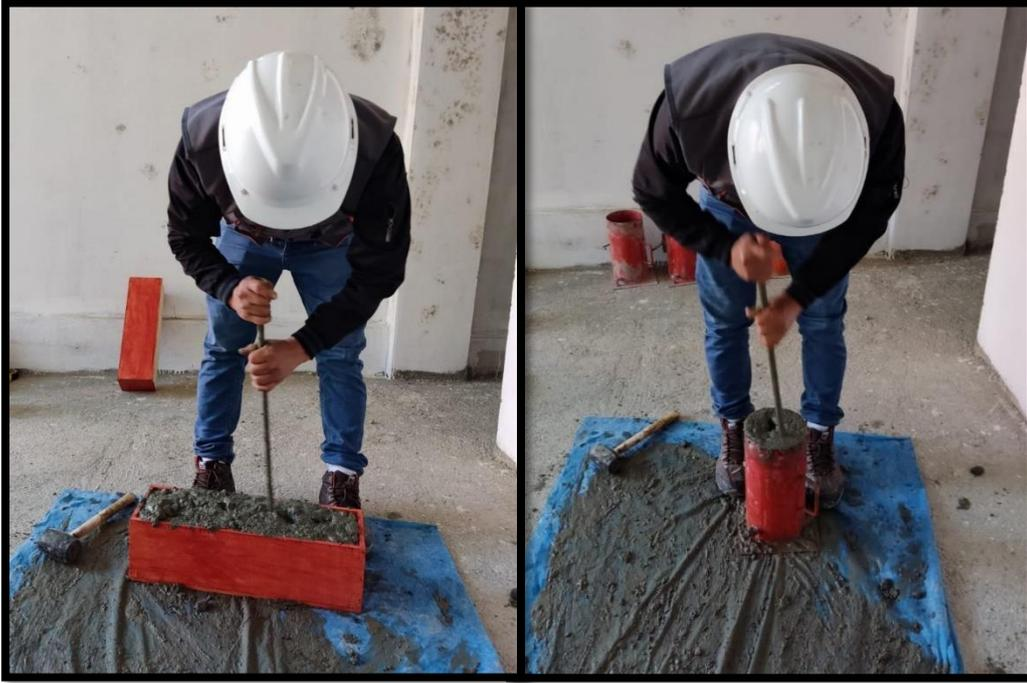
**Fotografía 5.** *Elaboración de briquetas y vigas de concreto*
