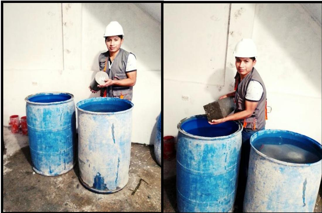
**Fotografía 6.** *Curado de las briquetas y vigas de concreto*
