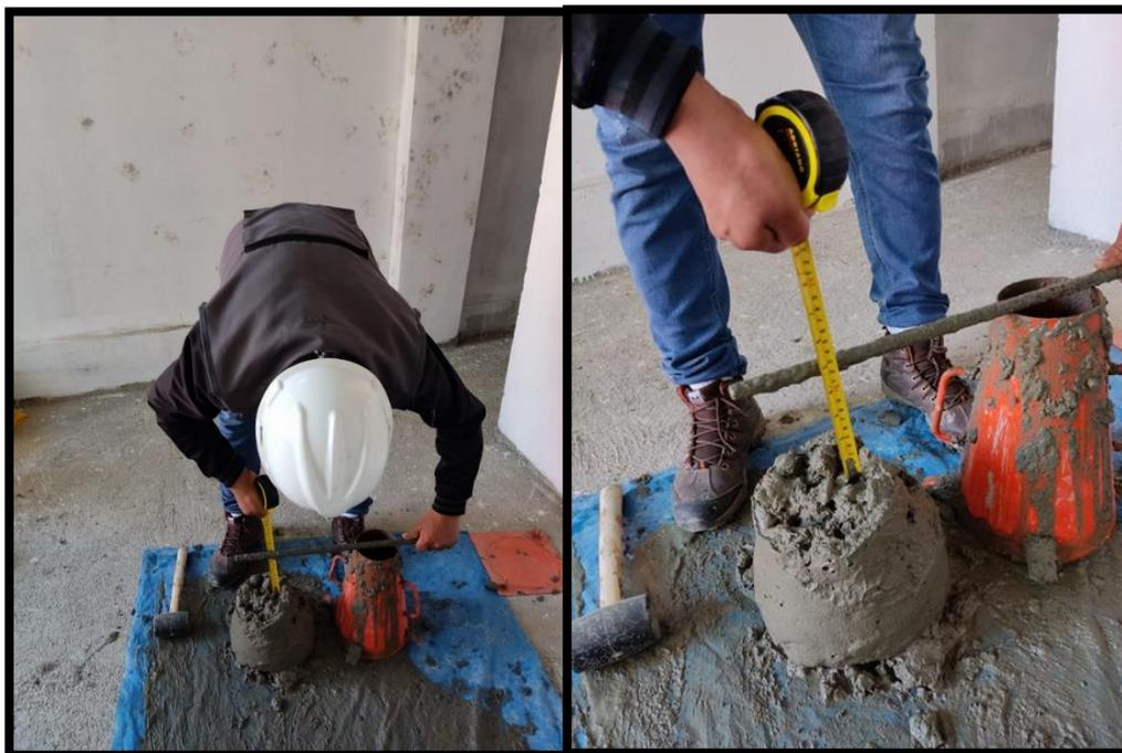
**Fotografía 4. Ensayo del asentamiento**
