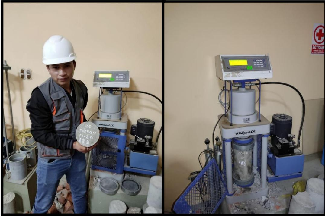
**Fotografía 7. Ensayo de resistencia a la compresión**
