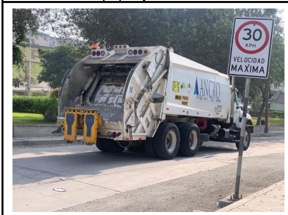
Foto 17: Camión compactador de residuos de empresa tercera
