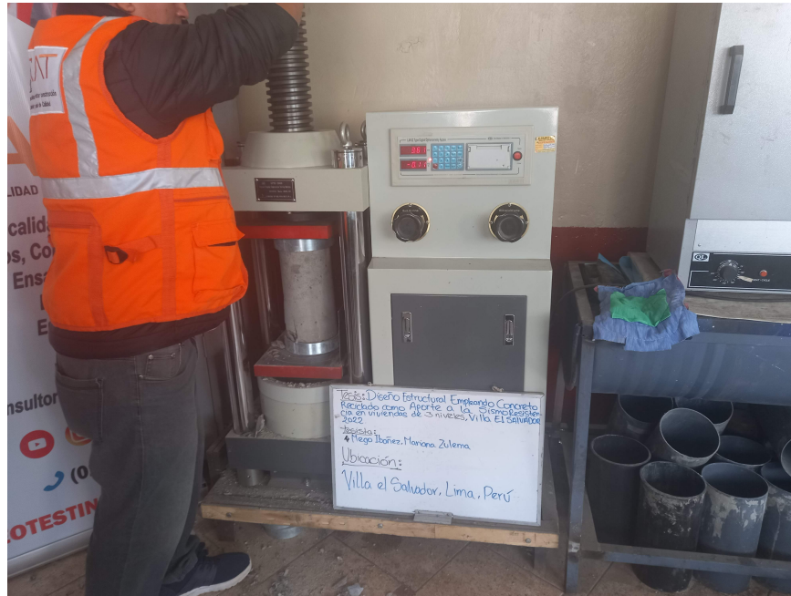
Figura 12: Ensayo a compresión.
