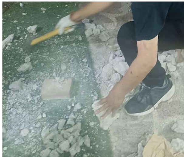
Figura 17: Trituración manual del concreto reciclado.
