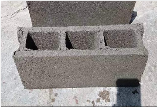
Figura 1. Unidad de bloque de concreto con 3 alveolos de 40x20x12
