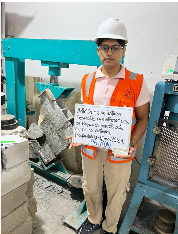
Foto 43: Rompimiento diagonal en muretes
