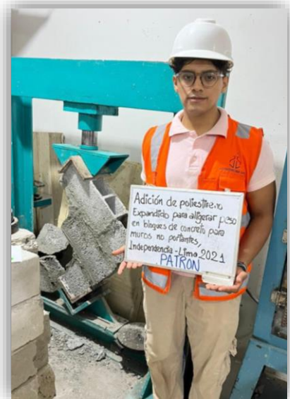
Figura 35. Rompimiento diagonal de murete EPS
