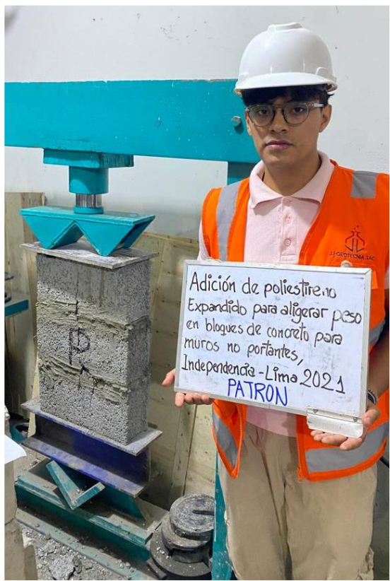
Foto 39: Rompimiento en pilas patrón
