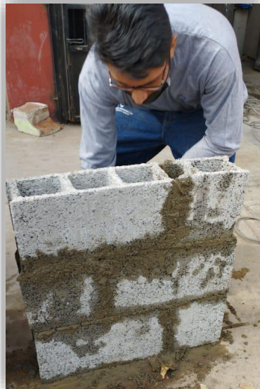
Figura 34. Realización de muretes patrón y con EPS
