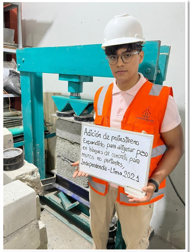
Foto 42: Rompimiento en pilas 7% de EPS
