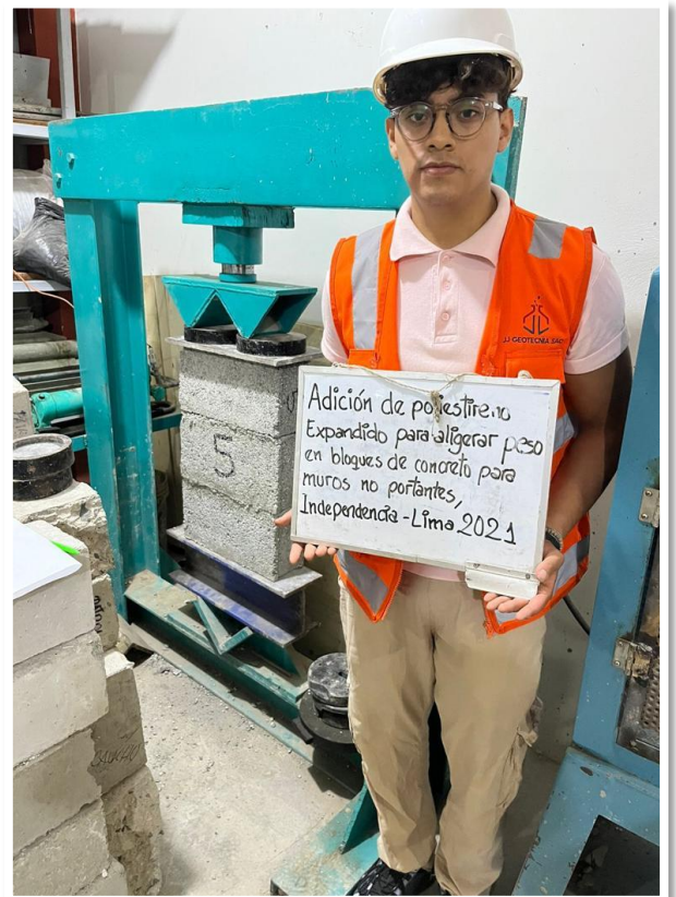
Foto 40: Rompimiento en pilas 5% de EPS
