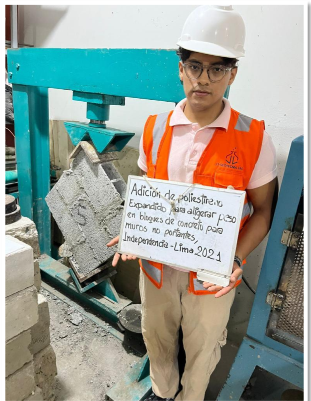
Foto 44: Rompimiento diagonal en muretes
