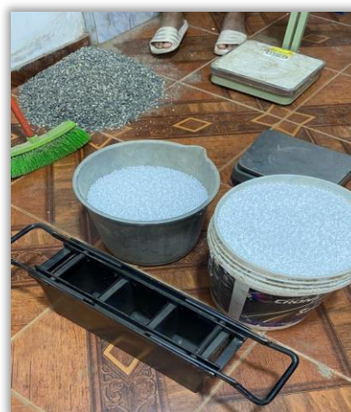
Figura 7. Peso de materiales de concreto más material añadido
