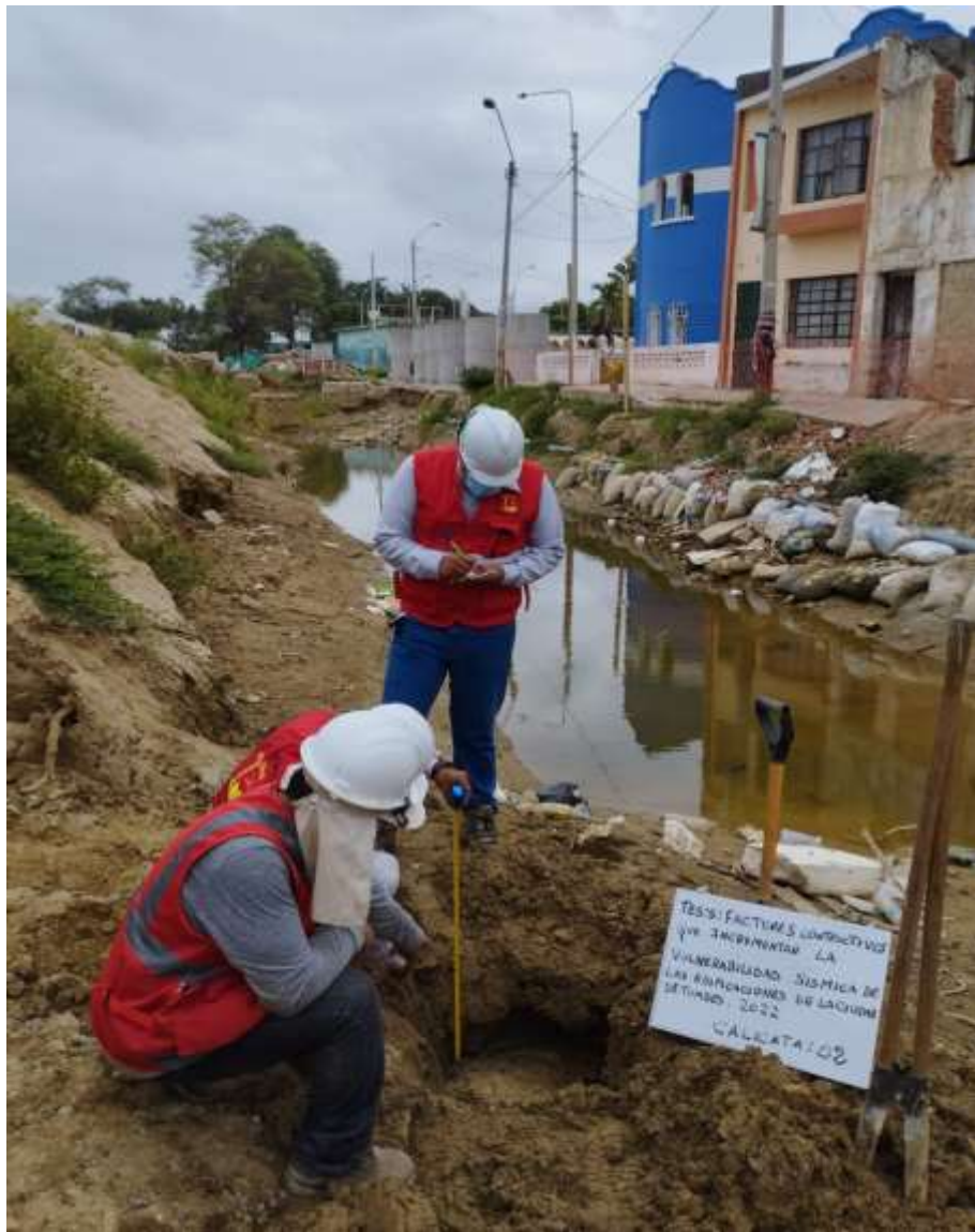
Figura 25: Tesistas verificando la profundidad de la napa freática
