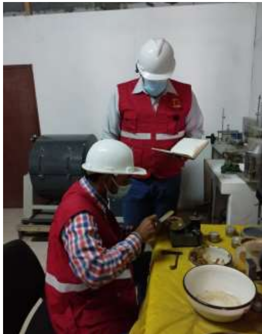
Figura 28: Verificando los componentes de la cuchara Casagrande
