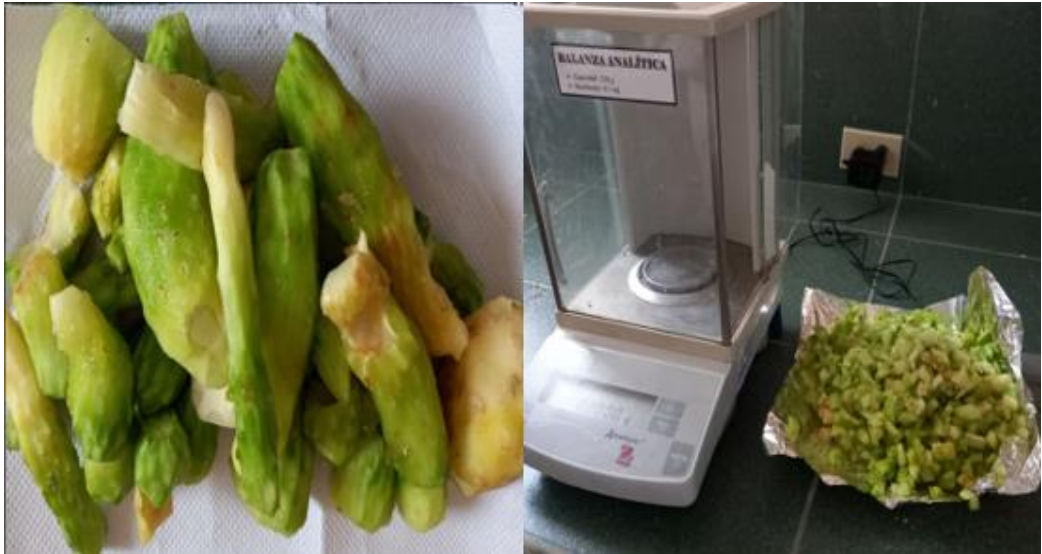
Figura 12. Secado y trituración del coagulante Opuntia Floccosa
