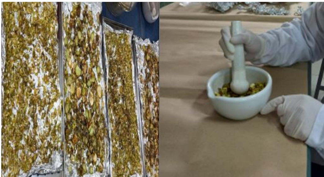
Figura 12. Secado y trituración del coagulante Opuntia Floccosa
