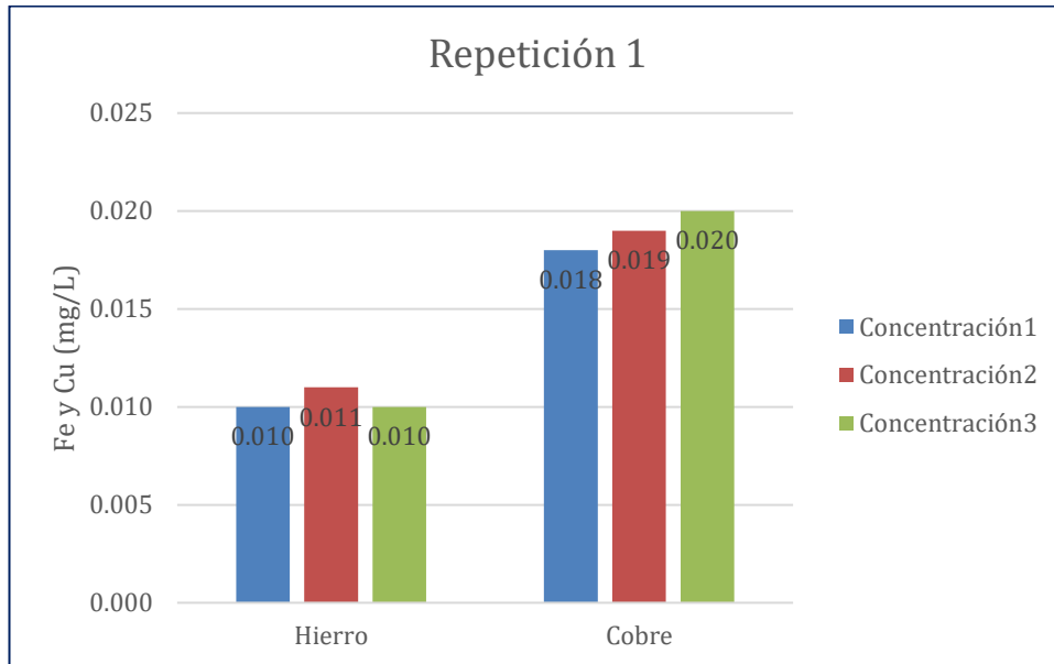
Figura N°17: Resultado del hierro y cobre del Test de Jarras Resultados de la 1 ra Repetición
