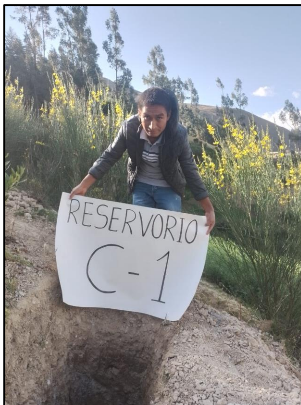
Imagen N°05: Calicata en la ubicación del reservorio
