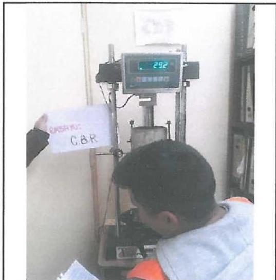
FIGURA N°60 :Se realizo el ensayo CBR para el material estabilizado con el 5% de CCV
