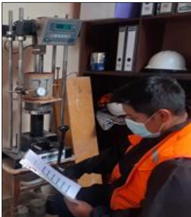
Figura 17. Ensayo del CBR
