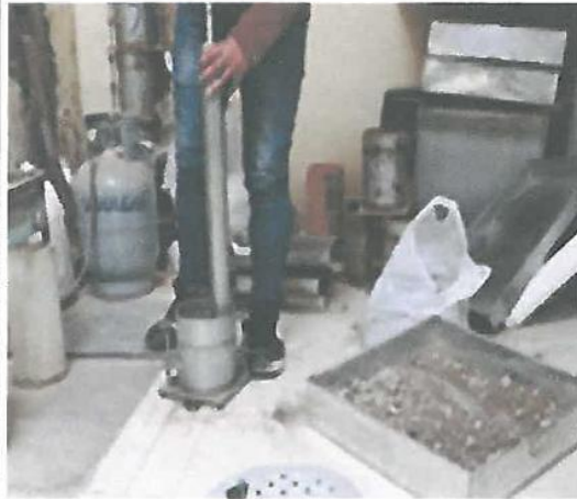
FIGURA N°67 :Se realizo el ensayo proctor para el material estabilizado con el 15% de CCV
