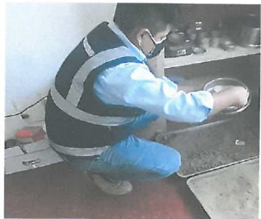
FIGURA N°44 :Tamizado del material por la malla N°40 para los ensayos de limites de atterberg.
