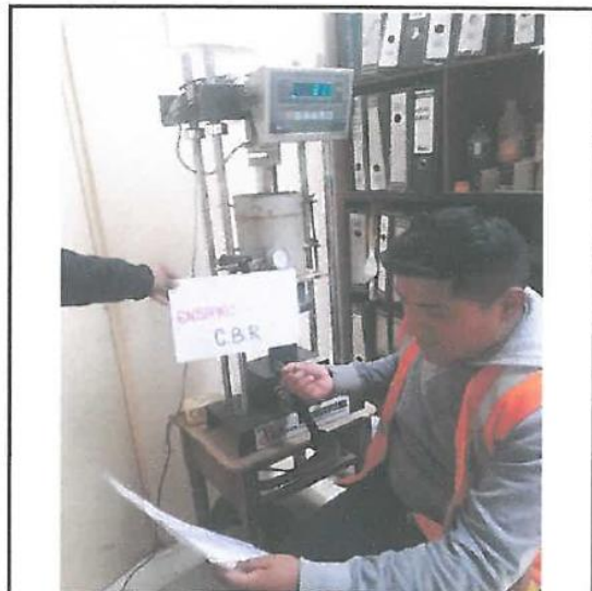
FIGURA N°64 :Se realizó el ensayo CBR para el material estabilizado con el 10% de CCV
