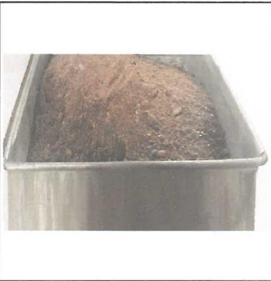
FIGURA N°61 :Muestra totalmente seca para iniciar el ensayo de granulometría en la muestra estabilizada con 10% de CCV.
