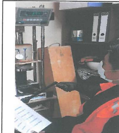
FIGURA N°32 : Se realizo el ensayo de CBR para el material extraido de la calicata N°1
