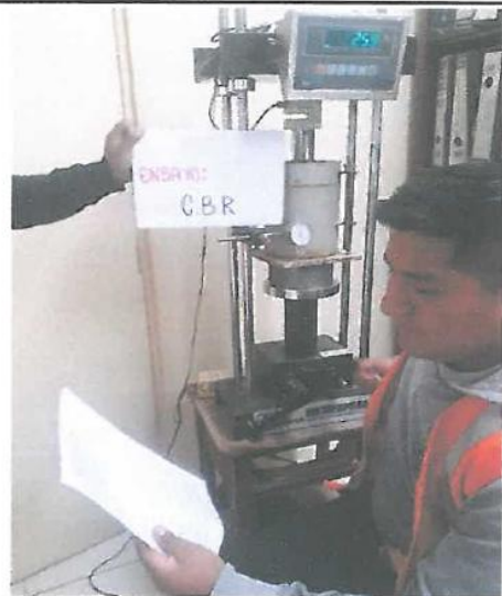
FIGURA N°68 :Se realizo el ensayo CBR para el material estabilizado con el 15% de CCV
