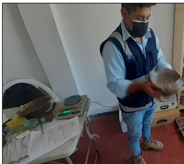
Figura 14. Tamizado por la malla N° 40 para el límite plástico
