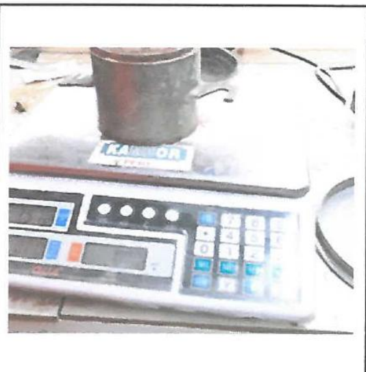
FIGURA N°39 :Se realizo el ensayo proctor para el material extraido de la calicata N°2
