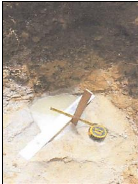
Figura 7: Medición de la calicata de percolación
