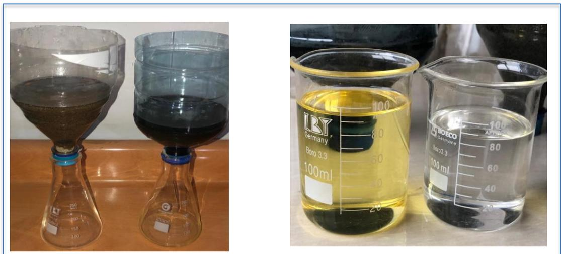
**Figura 20:** Proceso de filtración y adsorción
