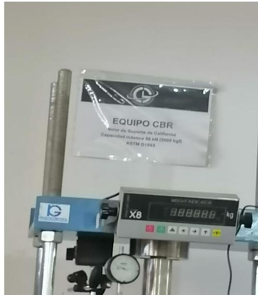
Figura 12: Equipo para ensayo cbr
