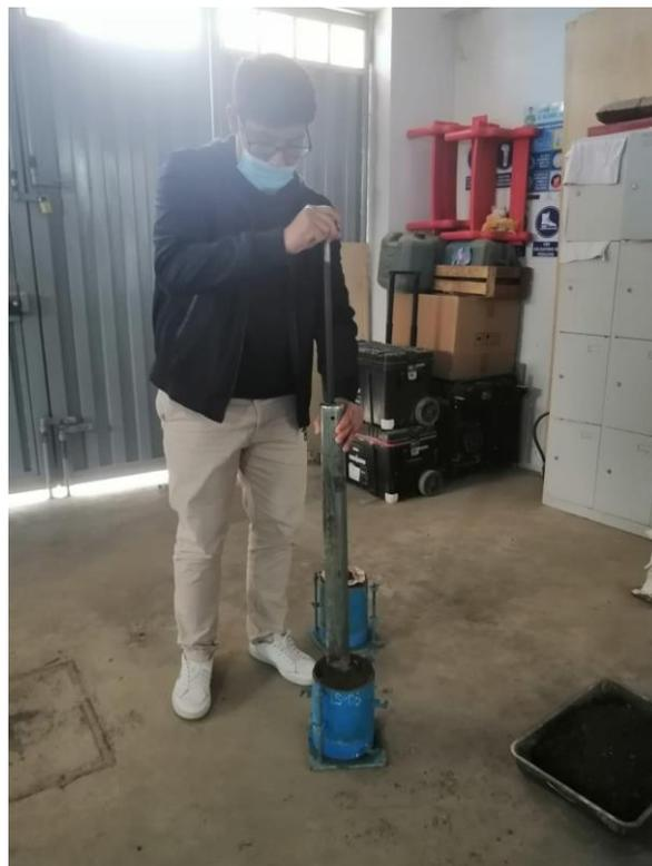
Figura 13: Ensayo próctor
