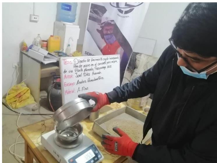
Figura 15: Ensayo granulométrico
