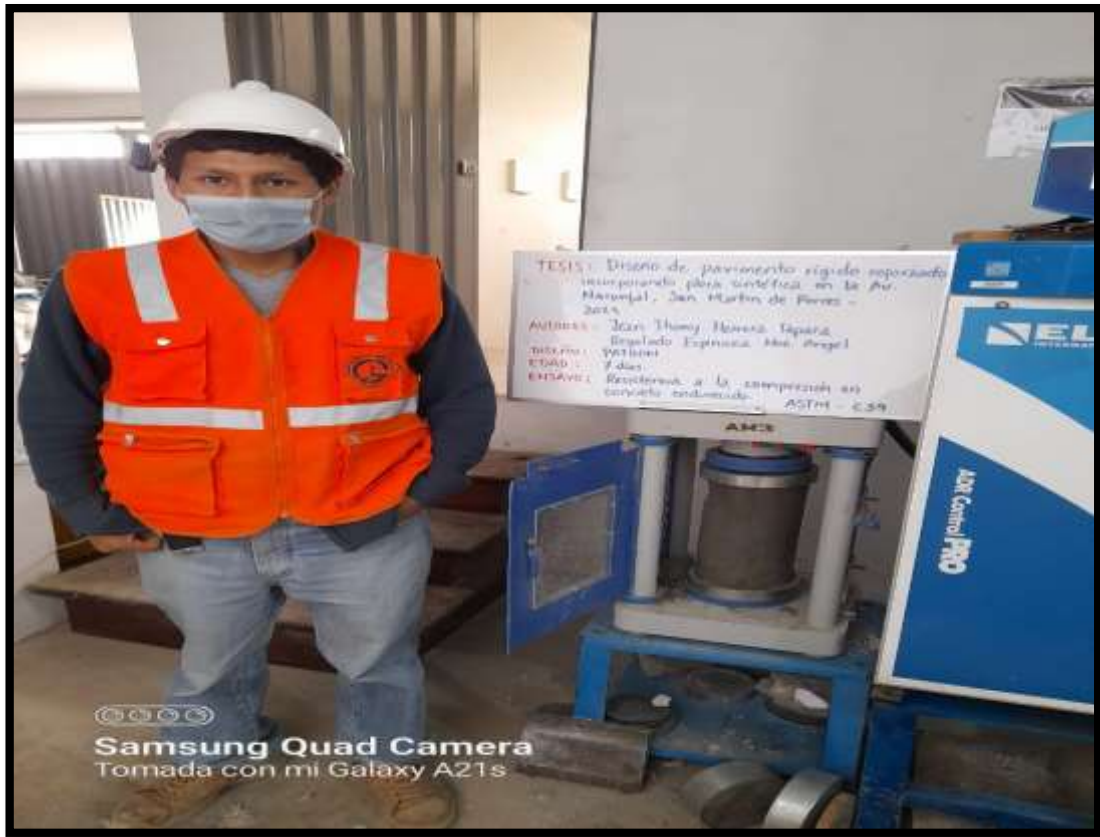
fotografía 18. Ensayo a compresión del concreto patrón 7 días
