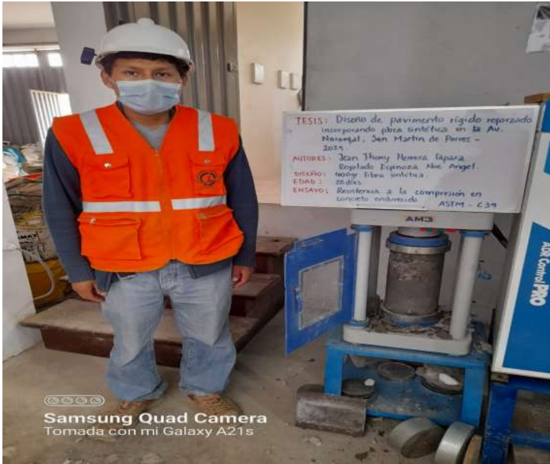
fotografía 26. M- 2 Ensayo a compresión del concreto con fibra 28 días
