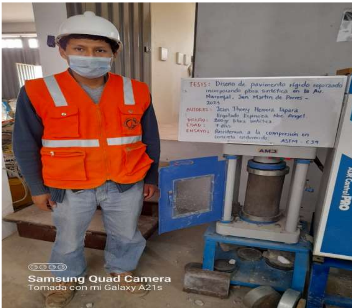
fotografía 21. M- 1 Ensayo a compresión del concreto con fibra 7 días
