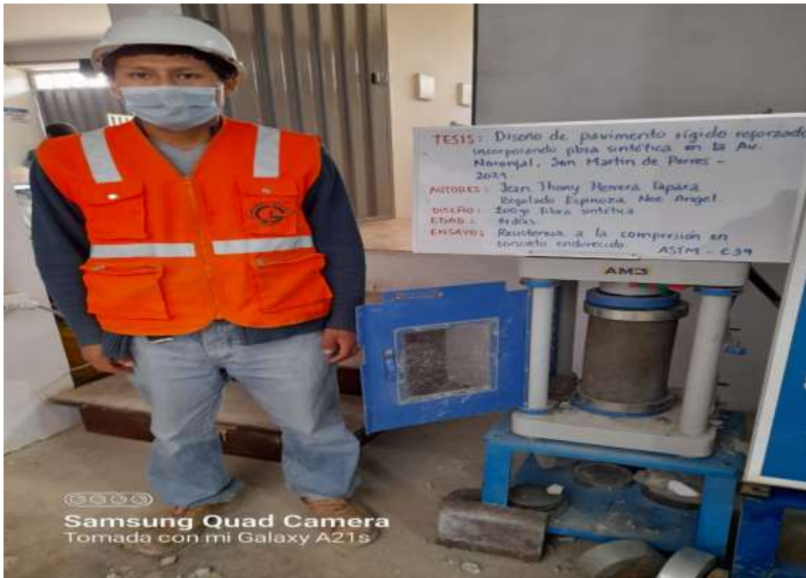
fotografía 22. M- 1 Ensayo a compresión del concreto con fibra 14 días
