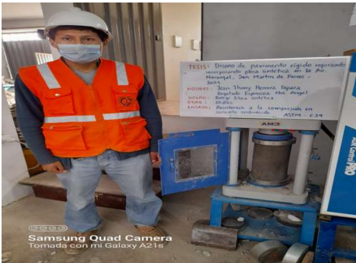
fotografía 23. M- 1 Ensayo a compresión del concreto con fibra 28 días
