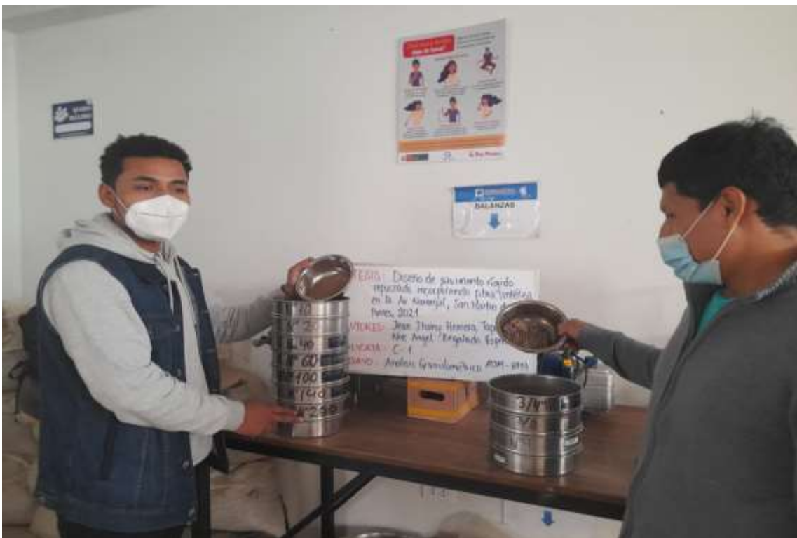
fotografía 9. Investigadores realizando el ensayo granulométrico
