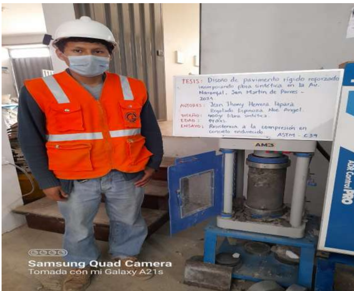
fotografía 25. M- 2 Ensayo a compresión del concreto con fibra 14 días
