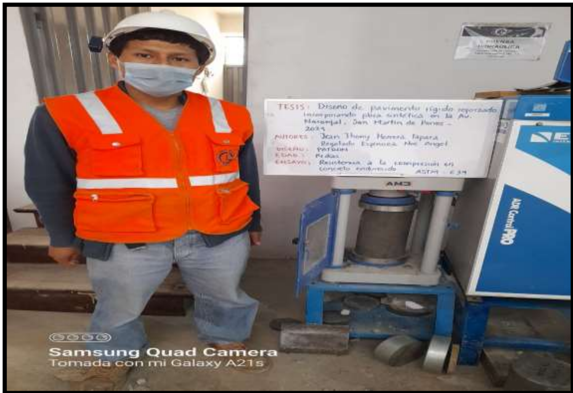
fotografía 19. Ensayo a compresión del concreto patrón 14 días
