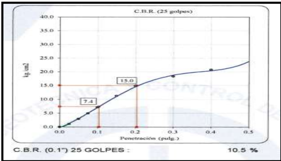
Figura 34: C.B.R. con 25 golpes muestra - 2. Fuente: INGEOCONTROL S.A.C (2021).
