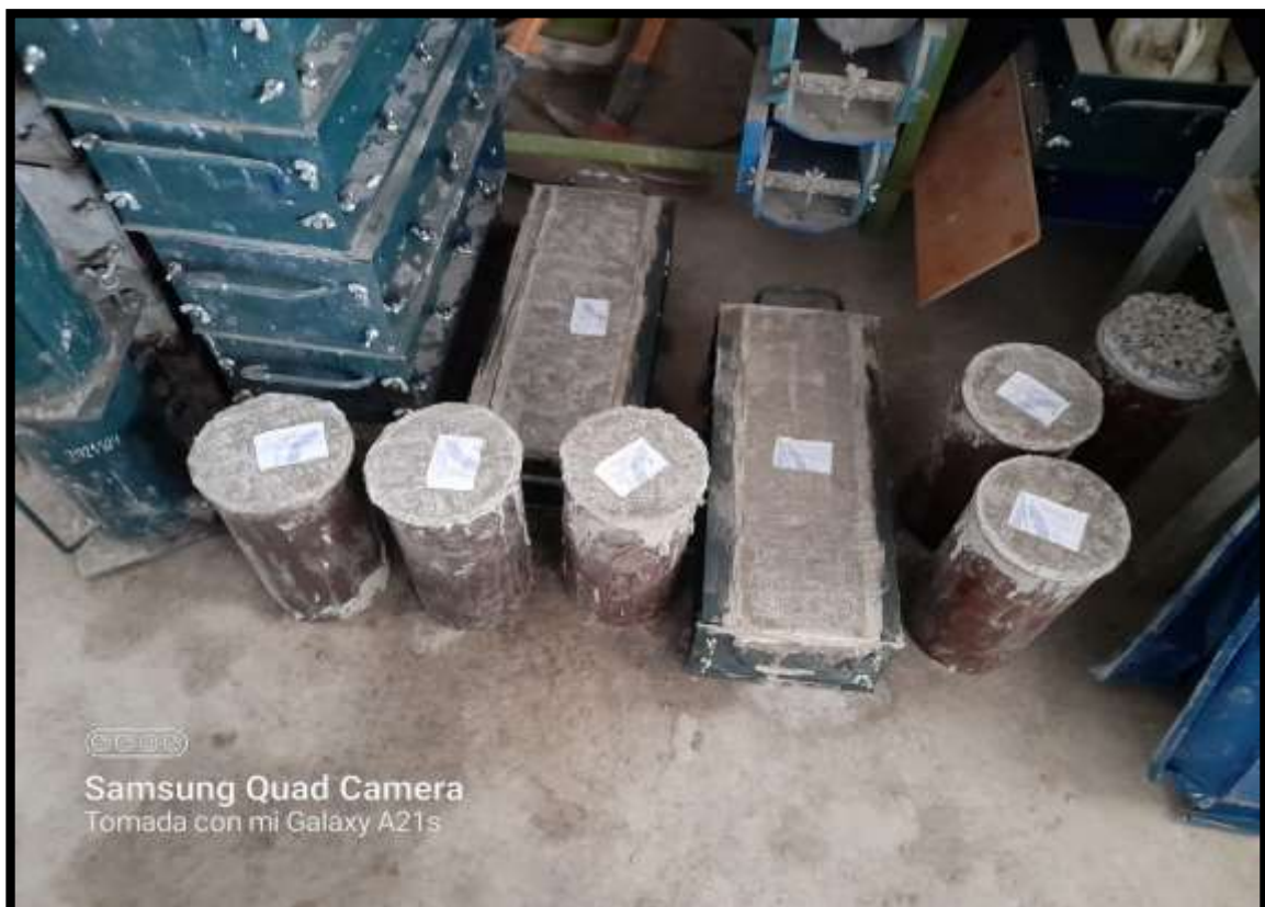
fotografía 17. Muestra cilíndrica y prismática(viga) de estudio
