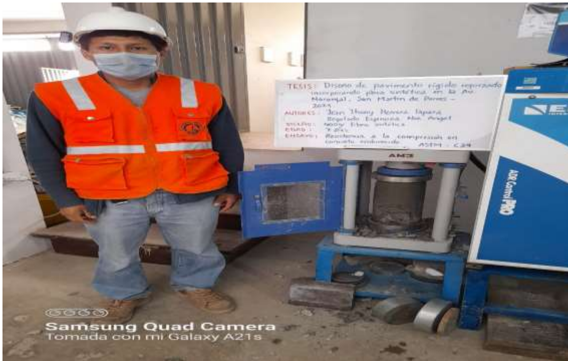
fotografía 24. M- 2 Ensayo a compresión del concreto con fibra 7 días
